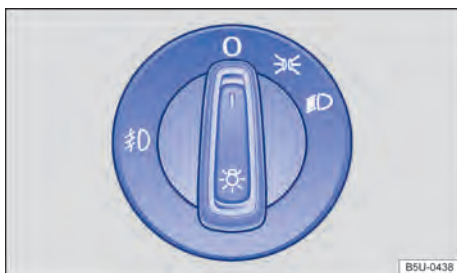
Fig. 63 Ao lado do volante: interruptor de luzes.
