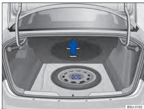
Fig. 145 No compartimento de bagagem, sob o revestimento de assoalho: roda de emergência e ferramentas de bordo.
