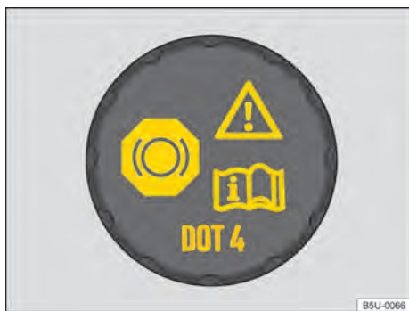
Fig. 177 No compartimento do motor: tampa do reservatório de fluido de freio.
