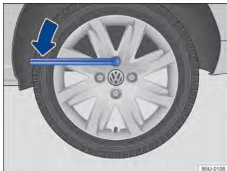
Fig. 188 Troca de roda: soltar os parafusos da roda.
