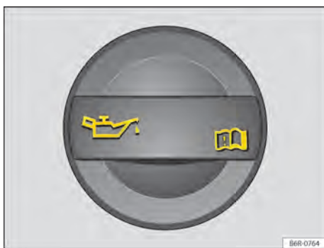
Fig. 174 No compartimento do motor: tampa da abertura para enchimento de óleo do motor.
