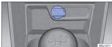
Fig. 97 No console central dianteiro: tomada 12 V.
