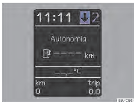
Fig. 78 No instrumento combinado: indicador de troca de marcha (variante 2).
