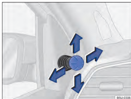
Fig. 68 Nas portas dianteiras: interruptor de ajuste dos espelhos retrovisores externos mecânicos.
