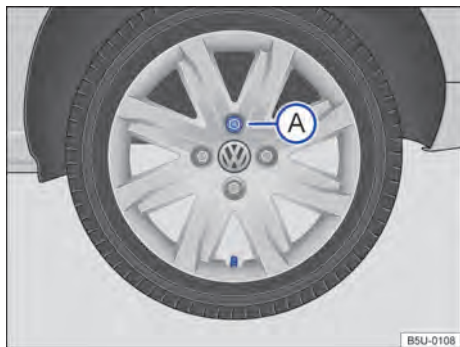
Fig. 190 Troca de roda: sequência de remoção dos parafusos da roda.
