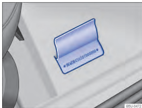
Fig. 193 Em frente ao banco do passageiro dianteiro: número de identificação do veículo (número do chassi) no assoalho, em frente ao banco do passageiro dianteiro.
