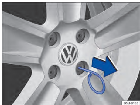
Fig. 186 Retirar as capas de cobertura dos parafusos da roda.
