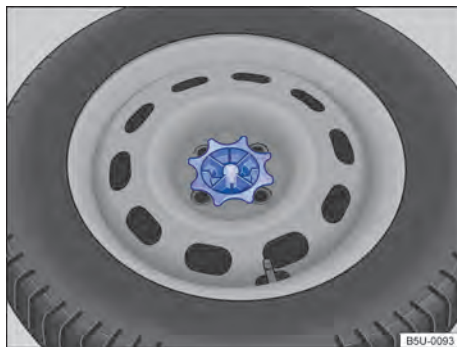
Fig. 186 No compartimento de bagagem: manípulo para fixação da roda de emergência.
