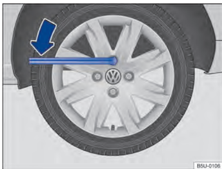
Fig. 142 Troca de roda: soltar os parafusos da roda.
