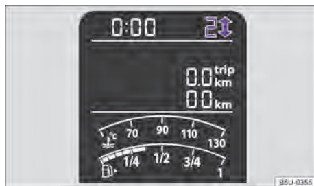
Fig. 78 No instrumento combinado: indicador de troca de marcha (variante 1).
