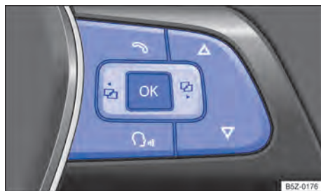
Fig. 18 Lado direito do volante multifunções: teclas de comando dos menus do instrumento combinado.
