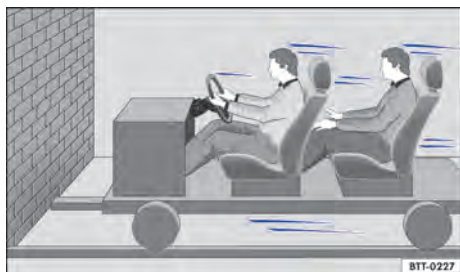
Fig. 22 Um veículo com os ocupantes do veículo sem cintos de segurança está em rota de colisão com um muro.
