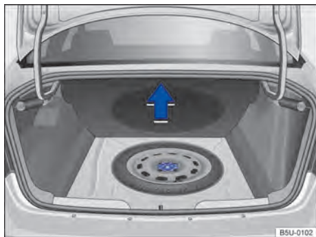
Fig. 104 No compartimento de bagagem, sob o revestimento de assoalho: roda de emergência e ferramentas de bordo.
