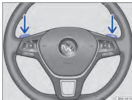
Fig. 86 Volante com seletores basculantes do Tiptronic.
