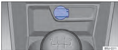
Fig. 101 No console central dianteiro: tomada 12 V.
