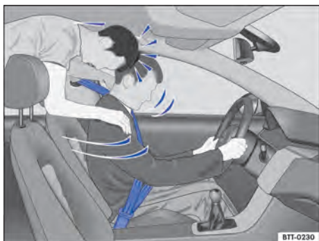
Fig. 25 O passageiro sem cinto de segurança no banco traseiro é lançado para frente sobre o condutor com cinto de segurança.
