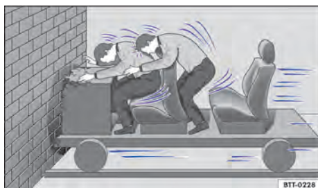
Fig. 23 Um veículo com os ocupantes do veículo sem cintos de segurança colide com o muro.
