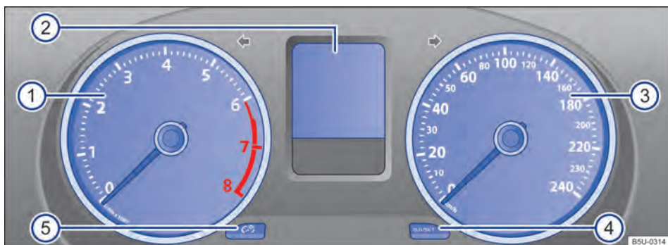
Fig. 9 Instrumento combinado no painel de instrumentos (variante 1). ▶
