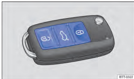
Fig. 45 Teclas na chave do veículo com comando remoto.
