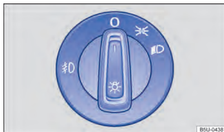
Fig. 63 No painel: interruptor das luzes.
