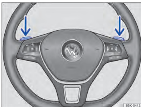
Fig. 86 Volante com seletores basculantes do Tiptronic.
