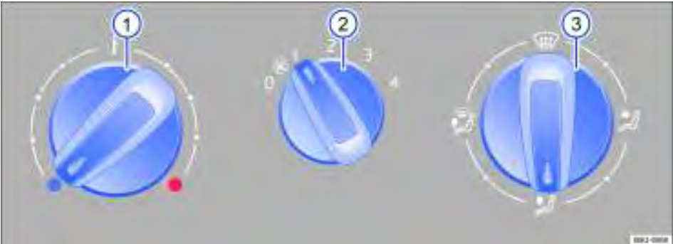
Fig. 118 No console central: comandos do aquecimento e da ventilação.
