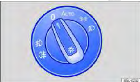
Fig. 66 No painel: interruptor giratório das luzes.
