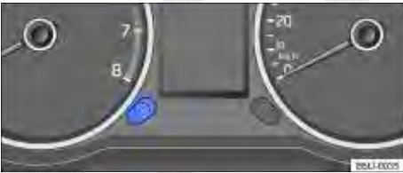
Fig. 67 No instrumento combinado: tecla de regulagem da iluminação dos instrumentos e dos interruptores.
