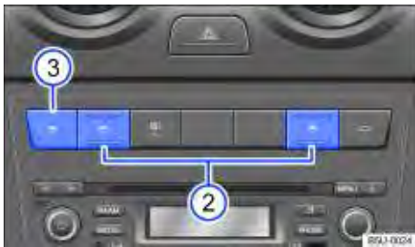
Fig. 36 No console central: teclas dos vidros elétricos traseiros.
