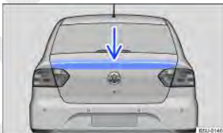
Fig. 34 Tampa do compartimento de bagagem fechada: região para fechamento.
