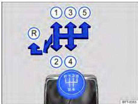
Fig. 101 Esquema de troca da transmissão manual de 5 marchas.
