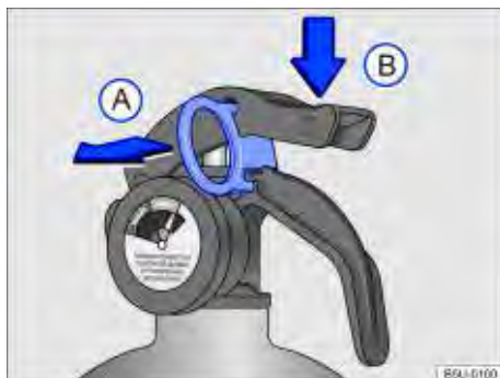
Fig. 150 Sequência de utilização do extintor de incêndio.
