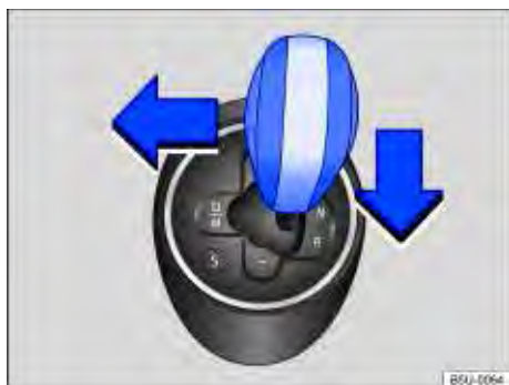
Fig. 104 Alavanca seletora da transmissão automatizada ASG.
