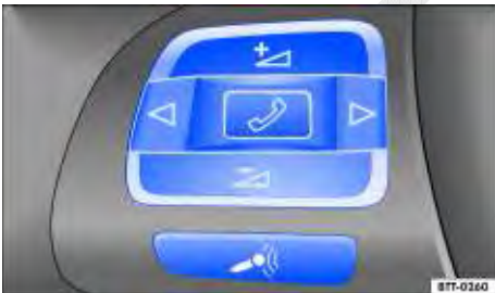
Fig. 16 Lado esquerdo do volante multifunções: teclas de comando.
