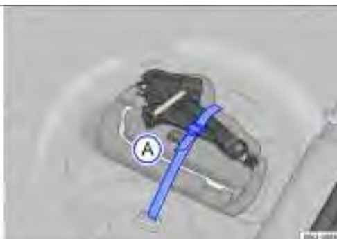
Fig. 157 No compartimento de bagagem: cinta de fixação da caixa de ferramentas e caixa de ferramentas de bordo.
