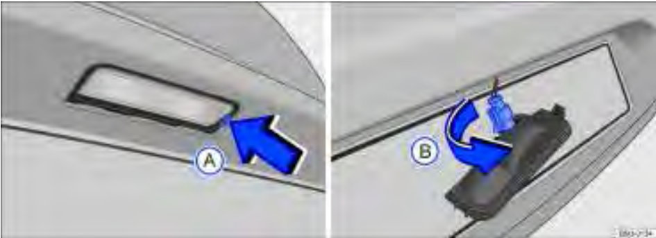
Fig. 187 No para-choque traseiro: remover a lanterna da placa de licença e o soquete da lâmpada.
