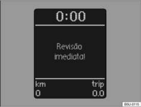
Fig. 11 Display do instrumento combinado: indicador do intervalo de serviço.
