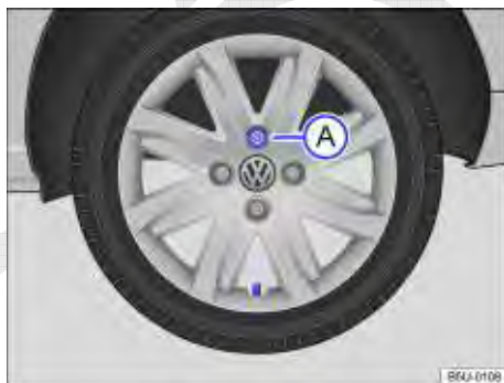
Fig. 159 Retirar a supercalota.
