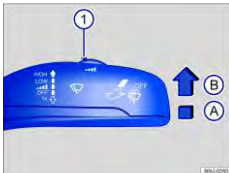
Fig. 71 Ao lado do volante: alavanca dos limpadores dos vidros: regular a sensibilidade do sensor de chuva ①.
