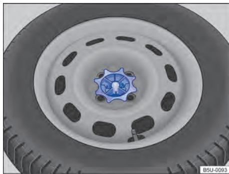
Fig. 197 No compartimento de bagagem: manípulo para fixação da roda de emergência.
