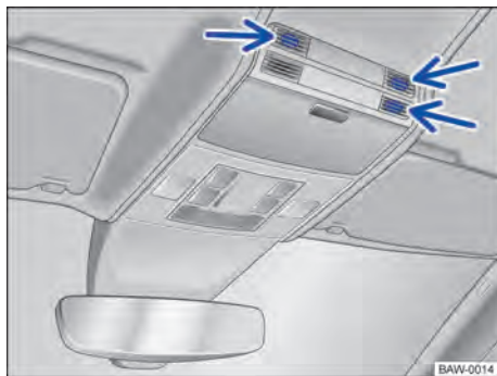
Fig. 58 No console do teto: sensores de monitoramento do interior do veículo (setas).
