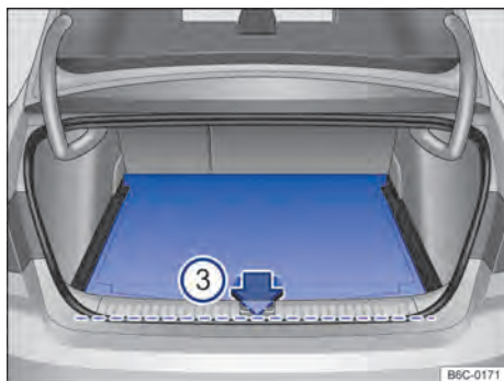
Fig. 152 No compartimento de bagagem: assoalho variável do compartimento de bagagem .
