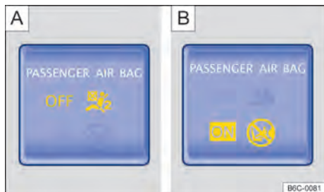
Fig. 34 Na parte superior do console central: luz de controle para o airbag frontal do passageiro dianteiro desligado [A] ou luz de controle para o airbag frontal do passageiro dianteiro ligado [B].
