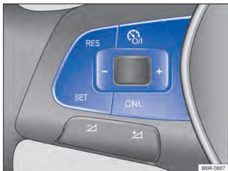
Fig. 95 Lado esquerdo do volante multifunções: botões para comandar o GRA.
