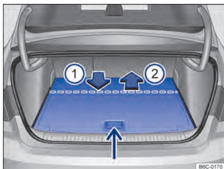
Fig. 151 No compartimento de bagagem: ajustar a altura do assoalho variável do compartimento de bagagem.
