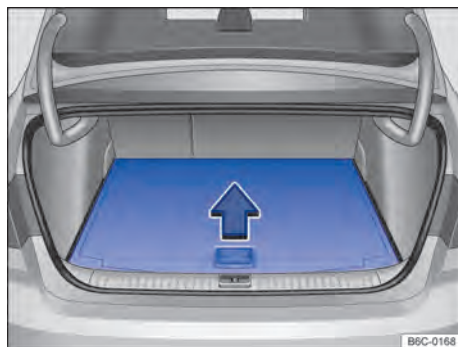
Fig. 150 No compartimento de bagagem: levantar o assoalho variável do compartimento de bagagem.
