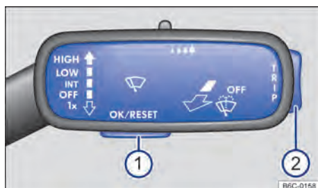
Fig. 18 Veículos sem volante multifunções: botão ① na alavanca dos limpadores do para-brisa para confirmação dos itens de menu e chave ② para alternar entre os menus.
