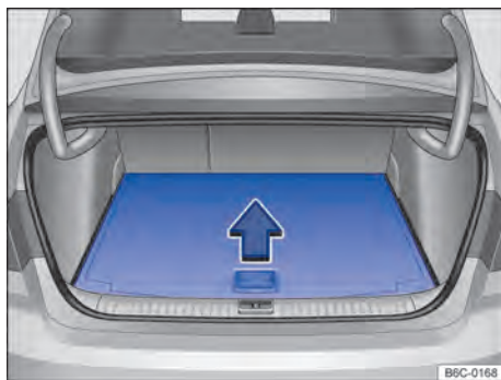
Fig. 151 No compartimento de bagagem: levantar o assoalho variável do compartimento de bagagem.
