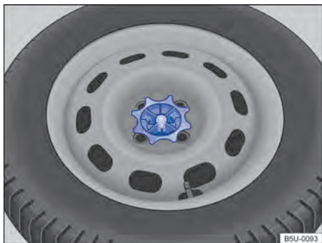
Fig. 198 No compartimento de bagagem: manípulo para fixação da roda de emergência.
