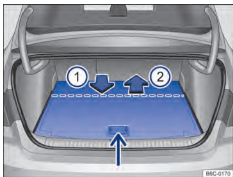
Fig. 152 No compartimento de bagagem: ajustar a altura do assoalho variável do compartimento de bagagem.
