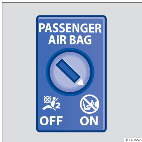
Fig. 39 No painel de instrumentos no lado do passageiro dianteiro: interruptor acionado pela chave para desligar e ligar o airbag frontal do passageiro dianteiro.
