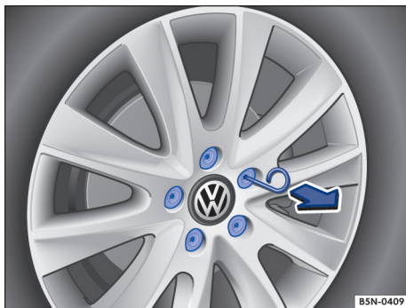
Fig. 165 Remover as capas de cobertura dos parafusos de roda.
