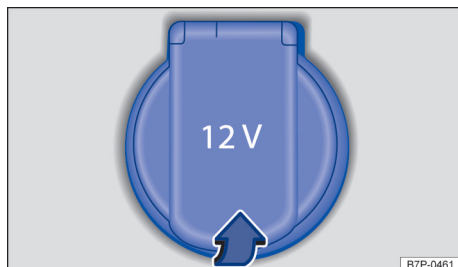
Fig. 114 No console central dianteiro: tomada 12 V.
