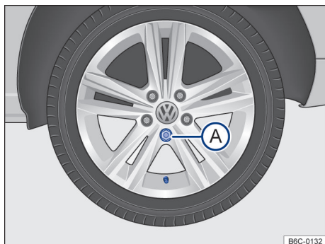
Fig. 164 Retirar a calota integral.
