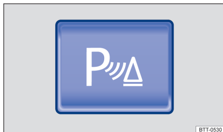
Fig. 104 No console central: botão para ligar e desligar o auxílio de estacionamento (dependendo da versão do veículo).
