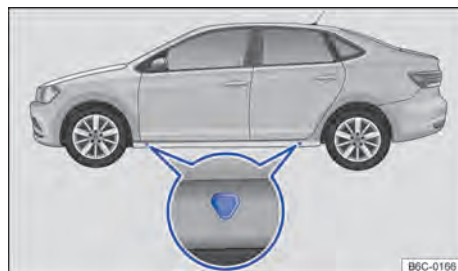
Fig. 166 Pontos de apoio do macaco.
