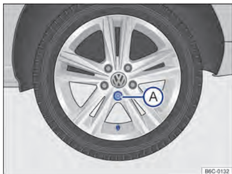
Fig. 163 Retirar a calota integral.
