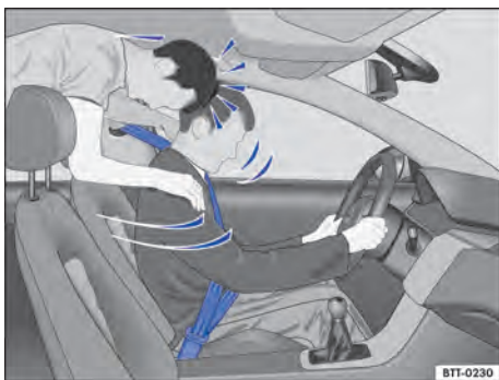
Fig. 29 O passageiro sem cinto de segurança no banco traseiro é lançado para frente sobre o condutor com cinto de segurança.
