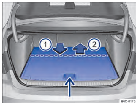
Fig. 116 No compartimento de bagagem: ajustar a altura do assoalho variável do compartimento de bagagem.
