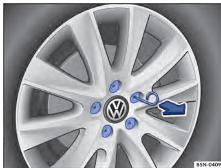
Fig. 164 Remover as capas de cobertura dos parafusos de roda.
