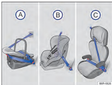
Fig. 42 As ilustrações (A), (B) e (C) mostram a fixação do sistema de retenção para crianças apenas com o cinto de segurança do veículo.
