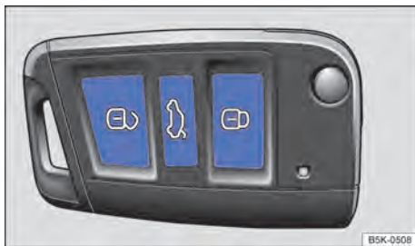
Fig. 53 Chave do veículo: travamento central.
