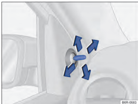
Fig. 81 Nas portas dianteiras: botão de ajuste dos espelhos retrovisores externos mecânicos.
