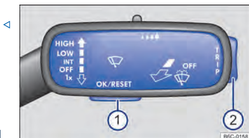
Fig. 21 Veículos sem volante multifunções: botão ① na alavanca dos limpadores do para-brisa para confirmação dos itens de menu e chave ② para alternar entre os menus.
