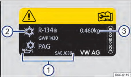
Fig. 174 Informações do ar-condicionado - motor 1.0L TSI e motor 1.6L.
