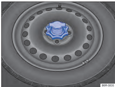
Fig. 144 No compartimento de bagagem: manipulô para fixação da roda de emergência.
