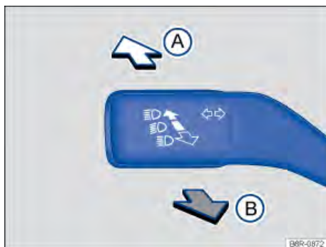
Fig. 65 À esquerda na coluna de direção: alavanca dos indicadores de direção e do farol alto.
