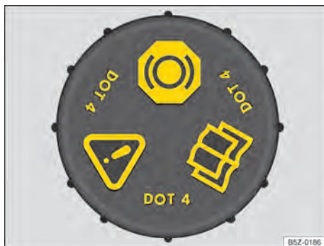
Fig. 138 No compartimento do motor: tampa do reservatório de fluido de freio (variante 2).
