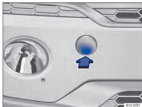
Fig. 128 No para-choque dianteiro à direita: soltar e remover a cobertura.
