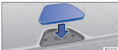
Fig. 152 No console central: fechar a abertura do suporte para telefone celular.
