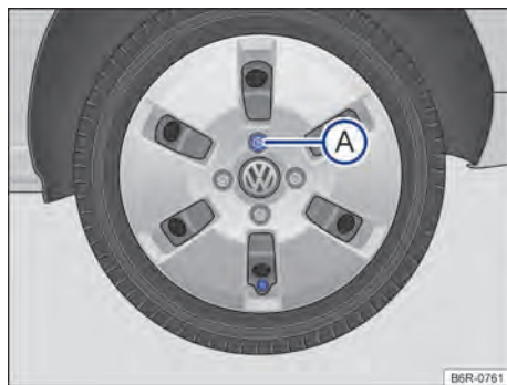
Fig. 147 Retirar a calota integral.
