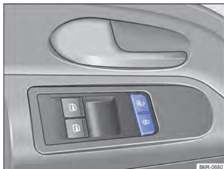
Fig. 47 Na porta do condutor: botão do travamento central.
