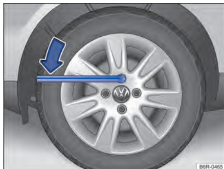
Fig. 149 Troca de roda: soltar os parafusos da roda.
