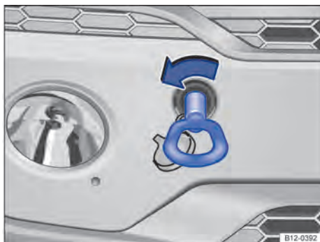
Fig. 129 No para-choque dianteiro à direita: rosquear a argola de reboque.
