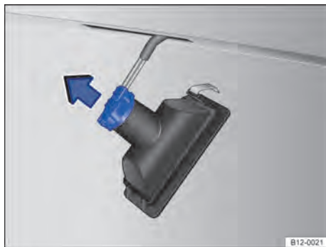
Fig. 120 Lanterna da placa de licença: remover o soquete da lâmpada.
