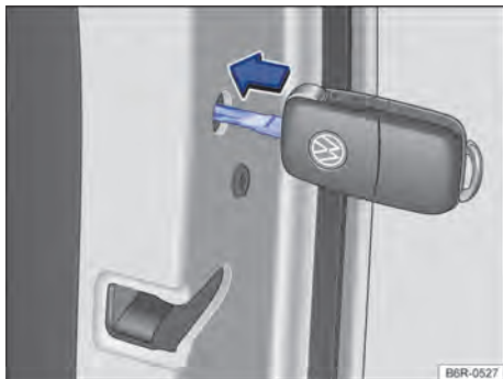
Fig. 51 Travamento de emergência do veículo com a chave do veículo.
