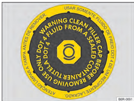
Fig. 137 No compartimento do motor: tampa do reservatório de fluido de freio (variante 1).
