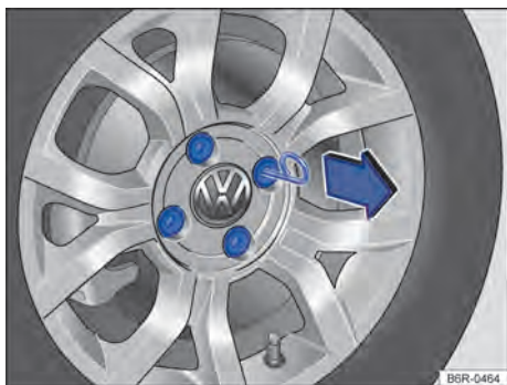
Fig. 148 Retirar as capas de cobertura dos parafusos da roda.
