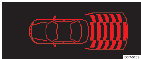
Fig. 81 Exibição do display do controle de distância de estacionamento no rádio.
