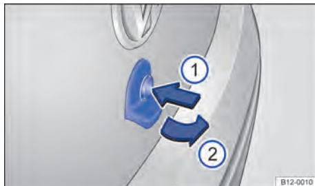
Fig. 53 Abrir a tampa traseira por fora.
