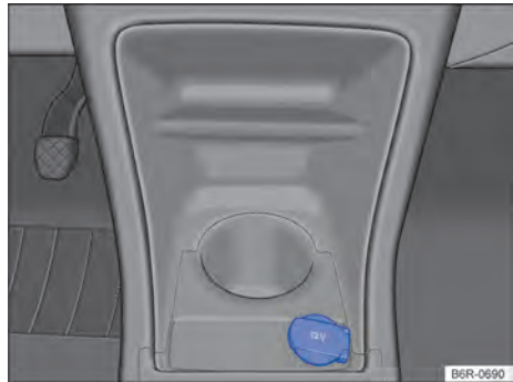
Fig. 91 No console central dianteiro: tomada 12 V.
