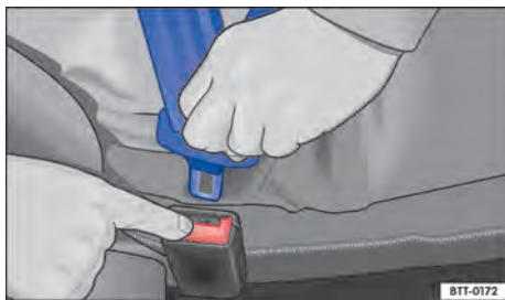
Fig. 29 Soltar a lingueta do cinto de segurança do fecho do cinto de segurança.
