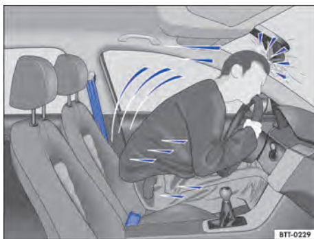
Fig. 25 O condutor sem cinto de segurança é lançado para frente.
