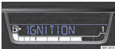
Fig. 17 No display do instrumento combinado: indicador de ignição ligada.
