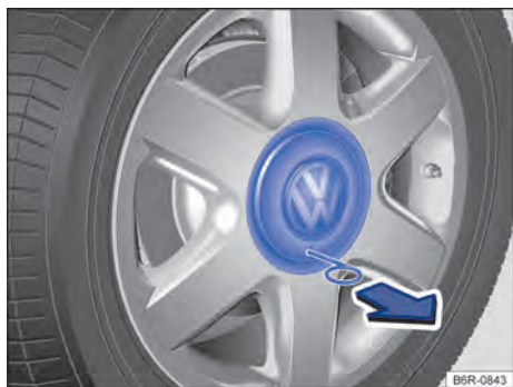
Fig. 146 Retirar a calota central da roda de liga leve.
