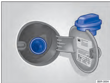
Fig. 108 Portinhola do tanque de combustível aberta com a tampa do tanque de combustível pendurada.
