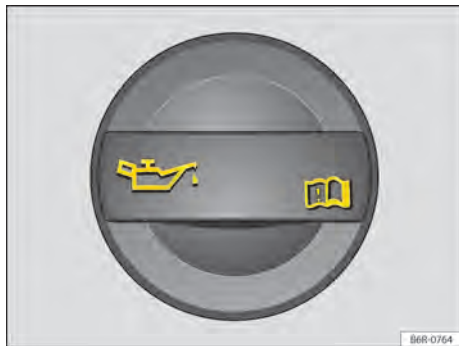
Fig. 134 No compartimento do motor: tampa da abertura para enchimento de óleo do motor.
