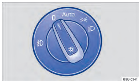
Fig. 64 No painel: interruptor das luzes.
