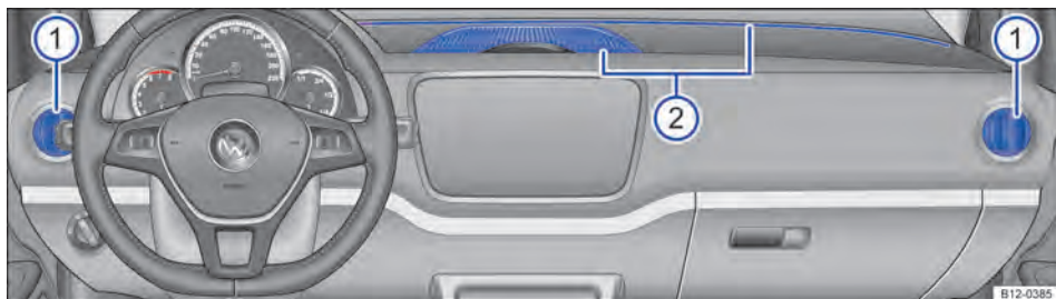
Fig. 75 No painel de instrumentos: difusores de ar.
