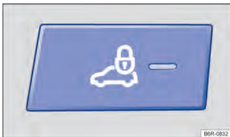
Fig. 46 Luz de controle no painel de instrumentos para indicação do travamento central acionado e/ou indicação do monitoramento do interior do veículo desligado.
