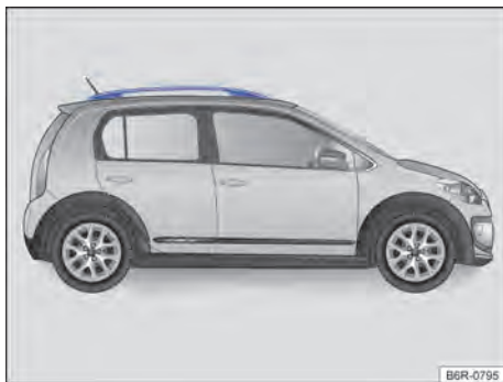
Fig. 107 Suportes longitudinais do bagageiro do teto (ambos os lados).
