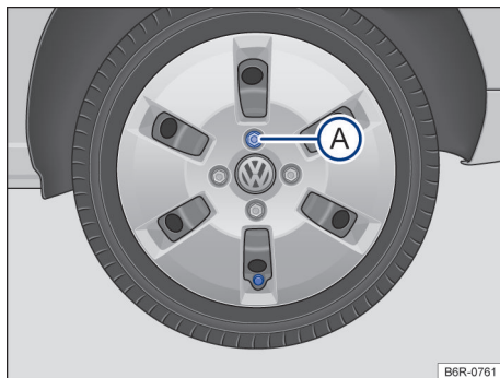
Fig. 143 Retirar a calota integral.
