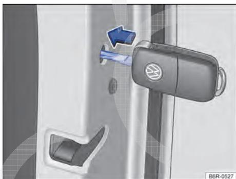
Fig. 131 Travamento de emergência do veículo com a chave do veículo.
