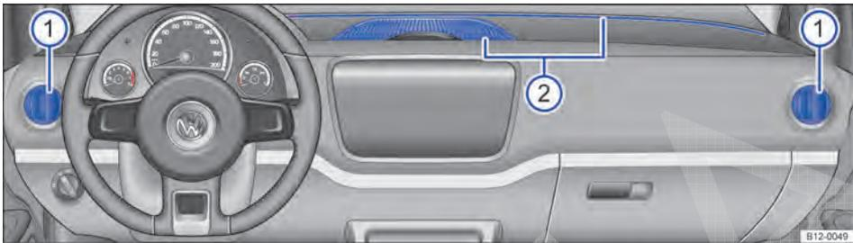
Fig. 98 No painel de instrumentos: difusores de ar.
