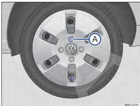
Fig. 136 Retirar a calota integral.
