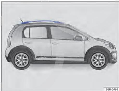
**Fig. 70** Suportes longitudinais do bagageiro do teto (ambos os lados).
