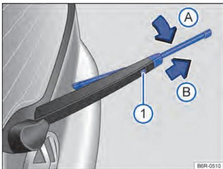
**Fig. 112** Substituir a palheta do limpador do vidro traseiro.
