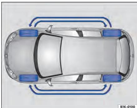
Fig. 115 Esquema para a troca das rodas.
