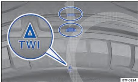
Fig. 117 Perfil do pneu: indicadores de desgaste.
