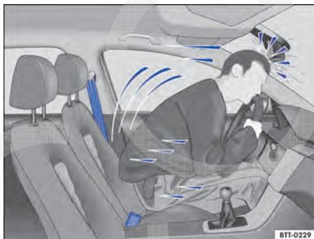
**Fig. 38** O condutor sem cinto de segurança é lançado para frente.
