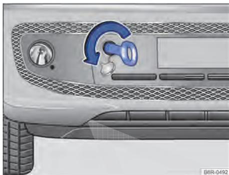
Fig. 155 No para-choque dianteiro à direita: rosquear a argola de reboque.
