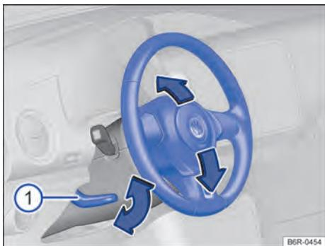
Fig. 34 Ajustar a posição do volante mecanicamente.
