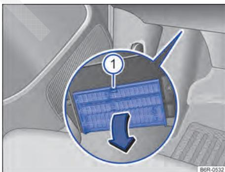
**Fig. 140** No lado do condutor embaixo do painel de instrumentos: abrir a cobertura da caixa de fusíveis. ▶
