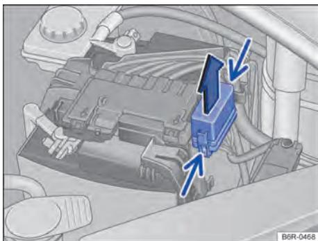
**Fig. 141** No compartimento do motor: retirar cobertura da caixa de fusíveis.
