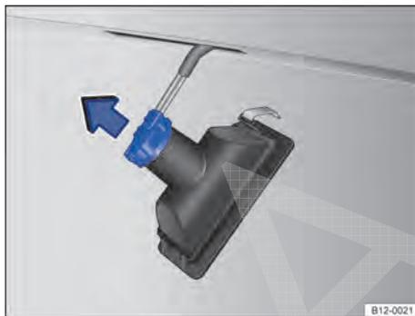
**Fig. 152** Lanterna da placa de licença: remover o soquete da lâmpada.
