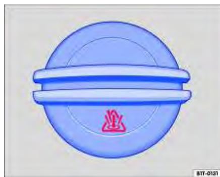
**Fig. 108** No compartimento do motor: tampa do reservatório de expansão do líquido de arrefecimento do motor.
