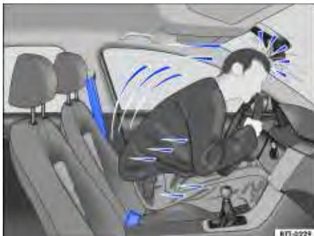
**Fig. 39** O condutor sem cinto de segurança é lançado para frente.
