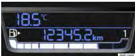
Fig. 100 No display do instrumento combinado: indicador do nível de combustível (variante 1).
