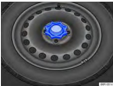
**Fig. 118** No compartimento de bagagem: manípulo para fixação da roda de emergência.
