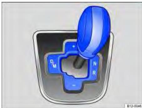
**Fig. 87** Alavanca seletora da transmissão automatizada.
