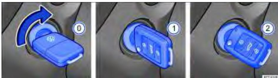
Fig. 83 Ao lado do volante, à direita: posições da chave do veículo no cilindro da ignição.
