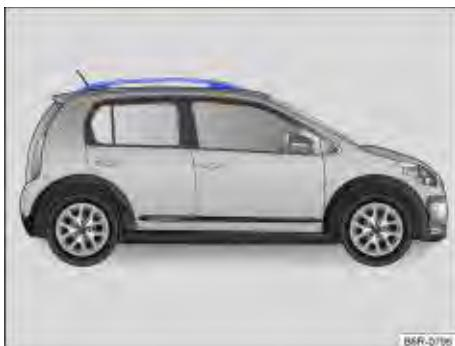
Fig. 71 Suportes longitudinais do bagageiro do teto (ambos os lados).
