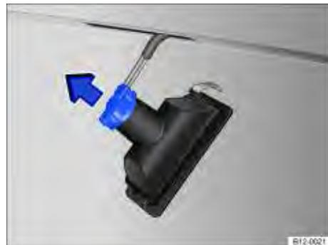
Fig. 154 Lanterna da placa de licença: remover o soquete da lâmpada.
