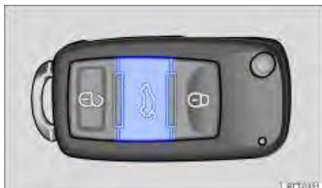
**Fig. 26** Na chave do veículo: botão de destravamento da tampa traseira.
