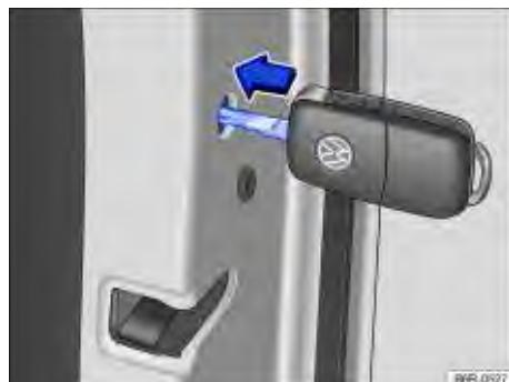
**Fig. 133** Travamento de emergência do veículo com a chave do veículo.
