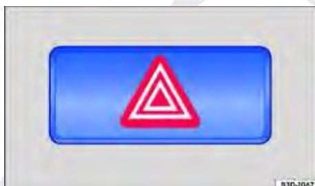
Fig. 126 Na parte superior do console central: interruptor para ligar e desligar as luzes de advertência.
