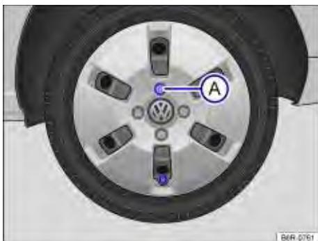
Fig. 138 Retirar a calota integral.
