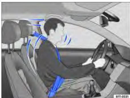
**Fig. 41** Condutor protegido pelo cinto de segurança colocado corretamente em uma manobra de frenagem súbita.
