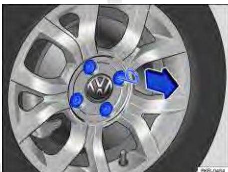
Fig. 139 Retirar as capas de cobertura dos parafusos da roda.
