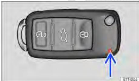
Fig. 17 Luz de controle da chave do veículo com comando remoto.
