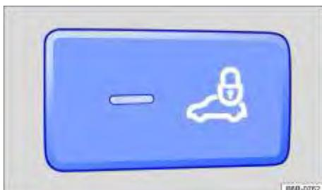
**Fig. 20** Luz de controle no painel de instrumentos para indicação do travamento central acionado e/ou indicação do monitoramento do interior do veículo desligado.
