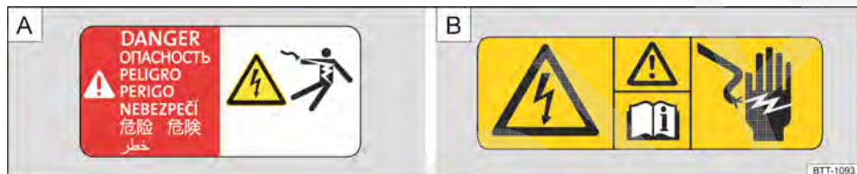
Fig. 268 A Placa de advertência do componente de alta tensão. B Placa de advertência de alta tensão.
