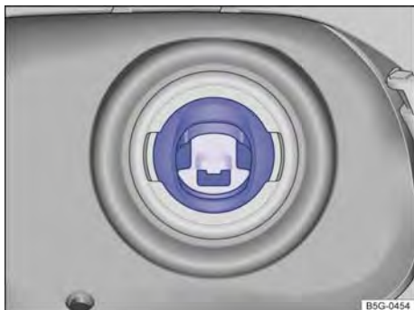
Fig. 229 Representação esquemática: proteção contra abastecimento errado no bocal de abastecimento do tanque.
