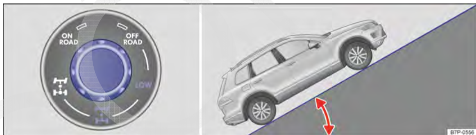
Fig. 155 Posição de marcha LOW engatada com o diferencial central bloqueado.
