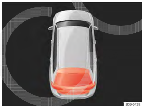
Fig. 84 No display do instrumento combinado: tampa do compartimento de bagagem aberta ou fechada incorretamente.
