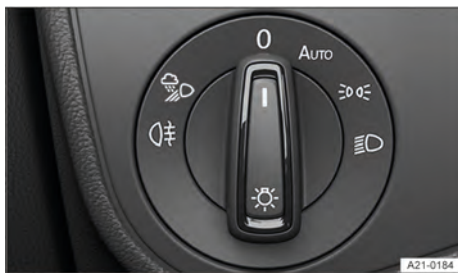
Fig. 114 Ao lado do volante: interruptor de luzes (uma variante).
