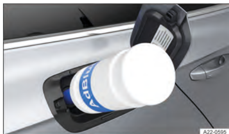
Fig. 229 Atrás da portinhola do tanque: reabastecer o AdBlue® com o frasco de reabastecimento (representação esquemática).
