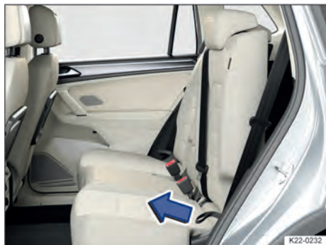
Fig. 95 Banco traseiro: rebater para frente e de volta
