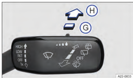
Fig. 122 À direita da coluna de direção: comandar o limpador do vidro traseiro.
