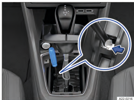
Fig. 146 No console central: destravar emergencialmente o bloqueio da alavanca seletora (variante 1).
