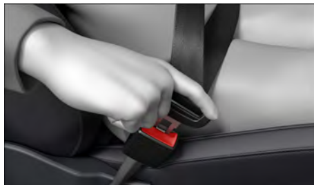
Fig. 36 Introduzir a lingueta do cinto de segurança no fecho do cinto de segurança (representação esquemática).
