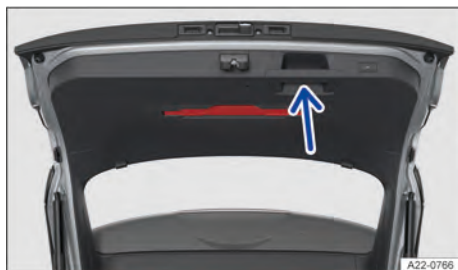
Fig. 77 Na tampa traseira aberta: alça para fechar a tampa traseira (representação esquemática).
