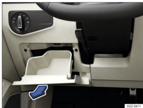
Fig. 239 À esquerda, ao lado do volante: cobertura da caixa de fusíveis no painel de instrumentos (veículo com direção à esquerda).
