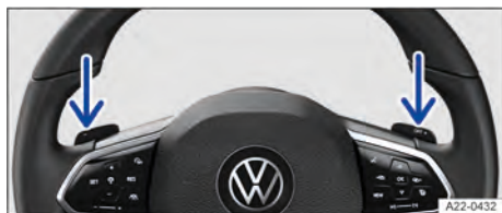
Fig. 145 Atrás do volante: seletores basculantes para o Tiptronic.
