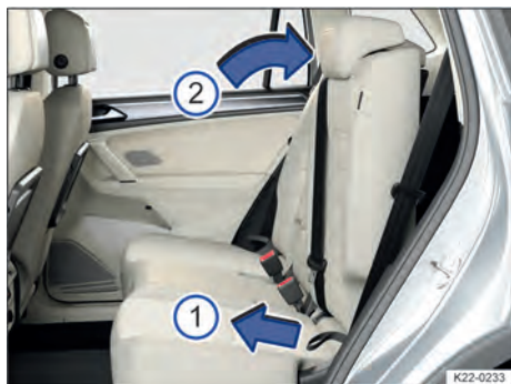
Fig. 94 Banco traseiro: ajustar o encosto do banco traseiro.
