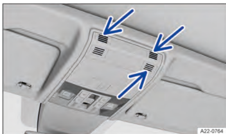
Fig. 75 No console do teto: sensores do monitoramento do interior do veículo (setas).
