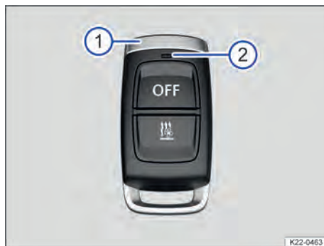
Fig. 133 Controle remoto do aquecimento estacionário.
