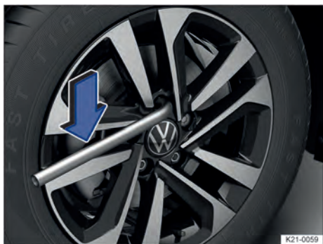
Fig. 279 Remover os parafusos de roda com a chave da roda.
