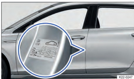
Fig. 264 Na coluna do condutor: etiqueta com as pressões dos pneus (alternativa ao lado interno da portinhola do tanque).
