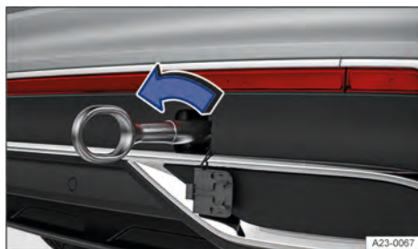
Fig. 250 No para-choque traseiro à direita: rosquear a argola de reboque da variante 1.
