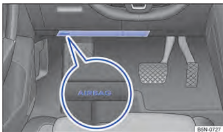
Fig. 50 No lado do condutor: local de instalação do airbag para joelhos (conforme a versão).
