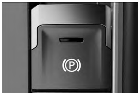
Fig. 174 No console central: botão do freio de estacionamento eletrônico.
