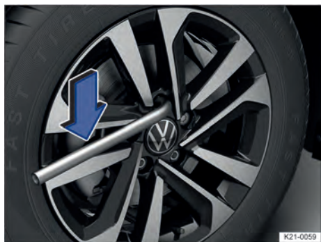
Fig. 275 Soltar os parafusos de roda.
