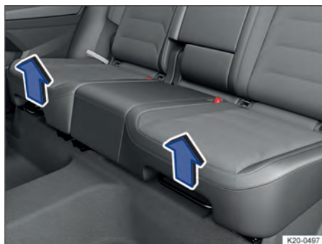
Fig. 93 Sob a superfície do banco traseiro: alavanca de ajuste.
