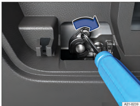
Fig. 83 Na tampa traseira: destravamento de emergência para a tampa traseira.
