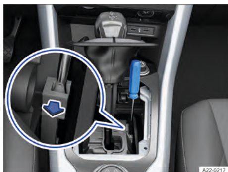
Fig. 147 No console central: destravar emergencialmente o bloqueio da alavanca seletora (variante 2).
