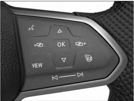
Fig. 20 Lado direito do volante multifunções: operar o instrumento combinado analógico (variante 2).
