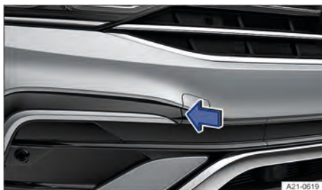
Fig. 246 No para-choque dianteiro à direita: retirar cobertura.
