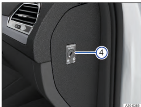
Fig. 9 Com a porta do passageiro aberta (veículo com direção à esquerda): interruptor de chave no painel de instrumentos (em veículos com direção à direita, a disposição dos elementos é espelhada).
