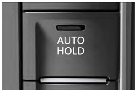
Fig. 175 No console central: botão do Auto Hold.
