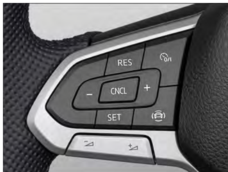
Fig. 162 Lado esquerdo do volante multifunções (variante 1).
