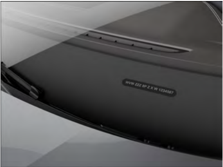
Fig. 326 No para-brisa: número de identificação do veículo.
