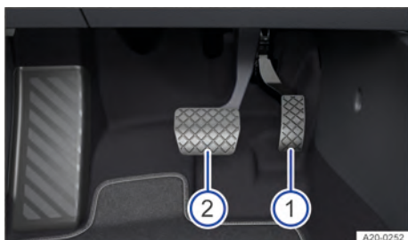
Fig. 137 Na área para os pés: pedais em veículos com transmissão automática.
