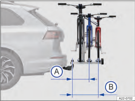
Fig. 220 Representação esquemática da largura máxima de um suporte de bicicletas para duas ou três bicicletas.
