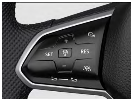
Fig. 167 Lado esquerdo do volante multifunções (variante 2).
