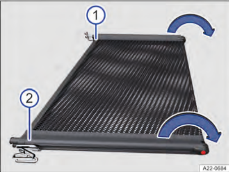
Fig. 207 Abrir a rede divisória.
