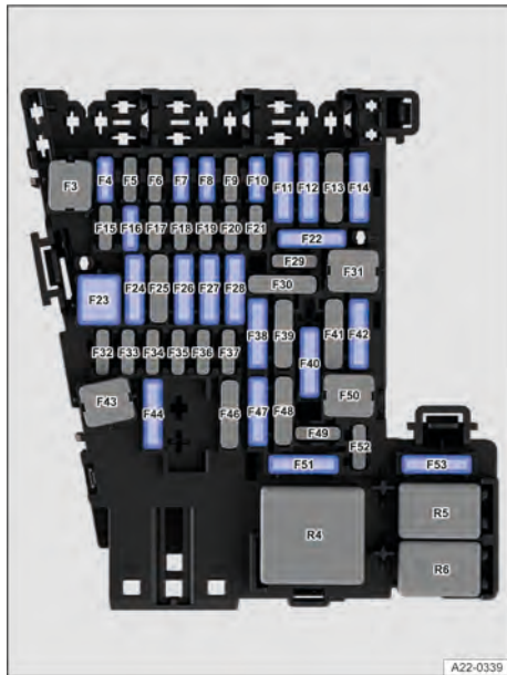
Fig. 241 No painel de instrumentos: disposição dos fusíveis.
