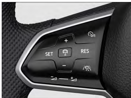
Fig. 172 Lado esquerdo do volante multifunções (variante 2).
