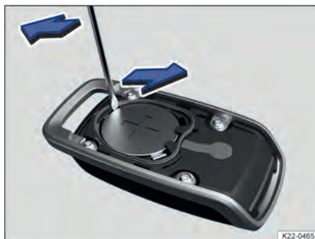
Fig. 135 Substituir a pilha-botão do controle remoto.
