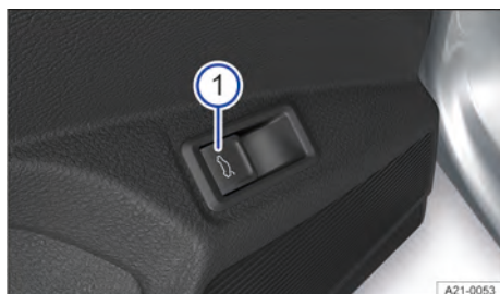
Fig. 71 Na porta do condutor: botão para abertura elétrica da tampa traseira (representação esquemática).
