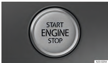
Fig. 139 Na parte inferior do console central: botão de partida.
