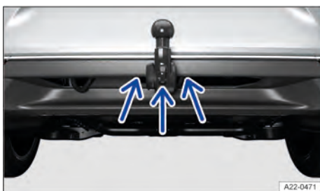
Fig. 216 No dispositivo de reboque: olhal para fixação do cabo de segurança ou de ruptura (representação esquemática).
