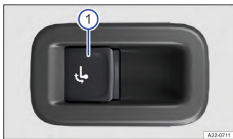
Fig. 217 No compartimento de bagagem, à direita: botão para destravamento do dispositivo de reboque.
