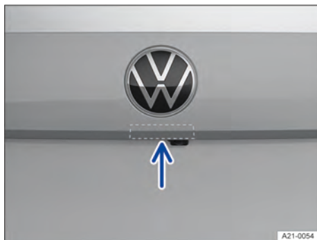
Fig. 76 Na tampa traseira: botão para abrir a tampa traseira (representação esquemática).
