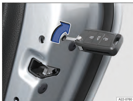
Fig. 73 Na parte dianteira da porta traseira direita: travamento de emergência do veículo com a chave do veículo (representação esquemática).
