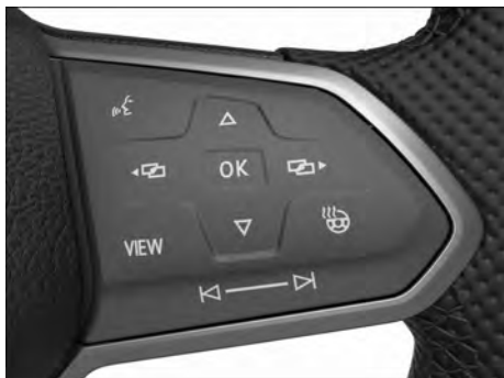
Fig. 12 Lado direito do volante multifunções: operar o instrumento combinado digital Pro (variante 2).
