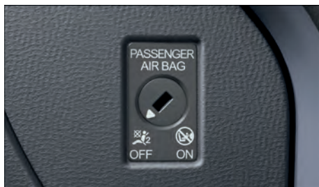
Fig. 43 No painel de instrumentos no lado do passageiro dianteiro: interruptor acionado pela chave para desligar e ligar o airbag frontal do passageiro dianteiro.
