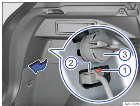
Fig. 236 Lateralmente no compartimento de bagagem: remover a lanterna traseira.
