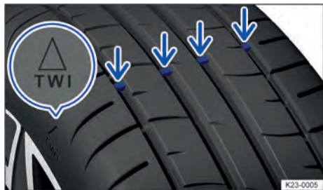
Fig. 268 Nos sulcos do perfil: indicador de desgaste.
