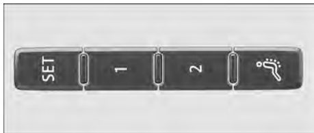
Fig. 111 Parte externa do banco do condutor: botões de memória.
