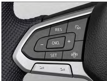
Fig. 160 Lado esquerdo do volante multifunções (variante 1).
