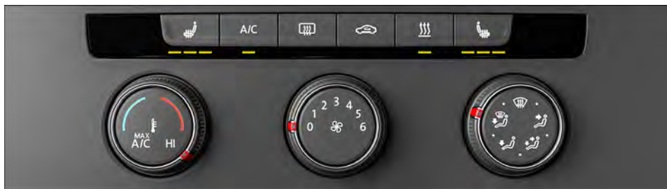
Fig. 132 Na parte superior do console central: painel de comando do ar-condicionado do ar-condicionado manual.
