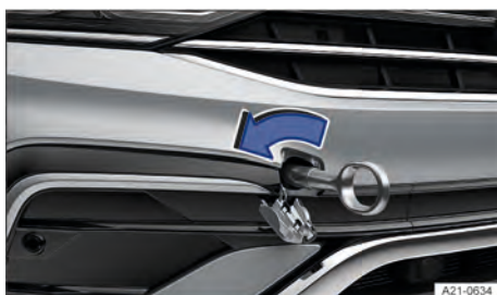
Fig. 247 No para-choque dianteiro à direita: rosquear a argola de reboque.
