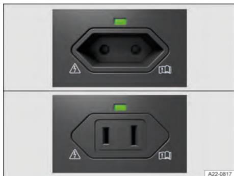
Fig. 196 No compartimento de bagagem do lado esquerdo: tomada 230 V, tomada 115 V ou tomada 100 V (dependendo da versão).
