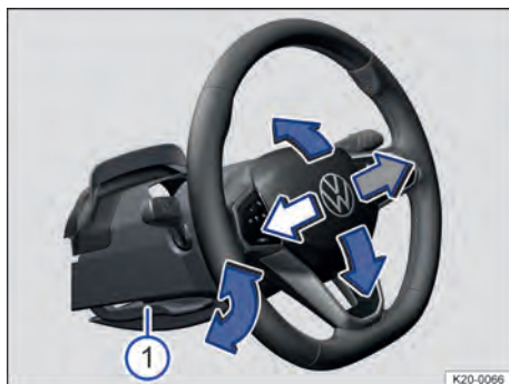
Fig. 85 Embaixo do volante no revestimento da coluna de direção: alavanca de ajuste mecânico da posição do volante (representação esquemática).
