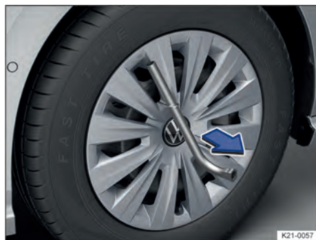
Fig. 273 Retirar a calota integral.
