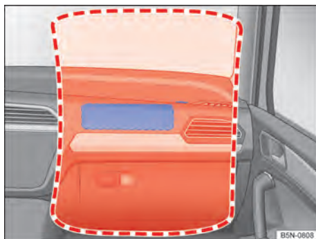
Fig. 44 Local de instalação e área de expansão do airbag frontal do passageiro dianteiro.
