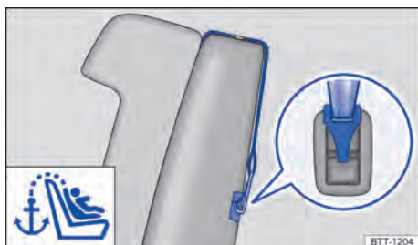
Fig. 59 Na parte traseira da segunda fileira de assentos: olhai de retenção do cinto de fixação superior.
