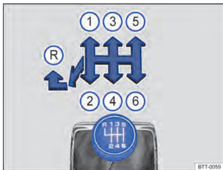
Fig. 134 Esquema de troca de marchas da transmissão manual de 6 marchas.
