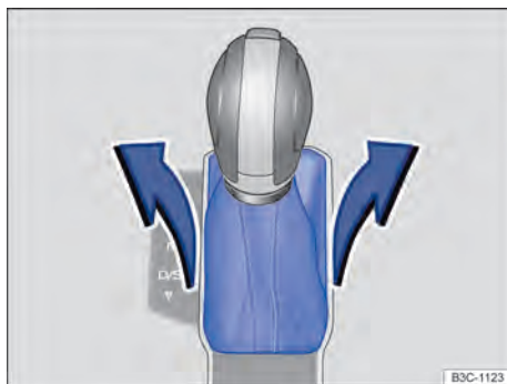
Fig. 137 Desinstalar a cobertura do quadro da alavanca seletora.
