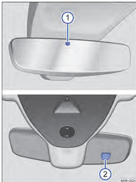
Fig. 117 No para-brisa: espelho retrovisor interno com antiofuscante automático.
