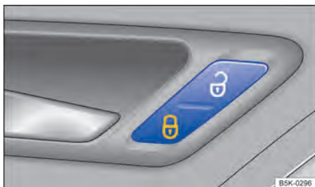
Fig. 70 Na porta do condutor: botão do travamento central.
