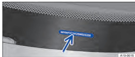
Fig. 268 No para-brisa: número de identificação do veículo.
