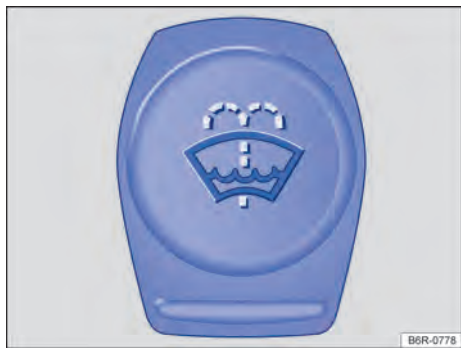
Fig. 236 No compartimento do motor: tampa do reservatório de água dos lavadores do para-brisa.
