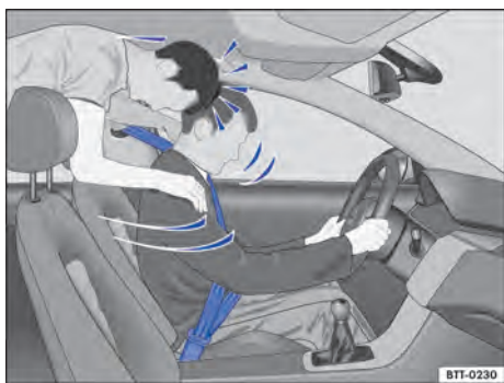
Fig. 34 O passageiro sem cinto de segurança no banco traseiro é lançado para frente sobre o condutor com cinto de segurança.
