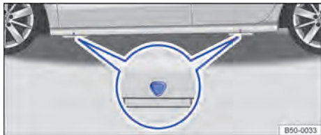
Fig. 258 Pontos de apoio do macaco.
