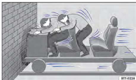
Fig. 32 Um veículo com os ocupantes do veículo sem cintos de segurança colide com um muro.
