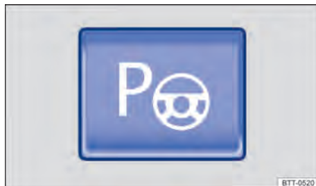
Fig. 167 No console central: botão para ligar o assistente de direção para estacionamento.
