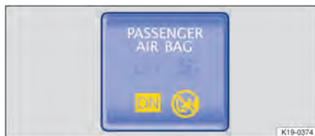
Fig. 42 No console central: luz de controle para airbag frontal do passageiro dianteiro ativado.
