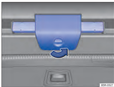
Fig. 60 Na tampa traseira: suporte para o triângulo de segurança.
