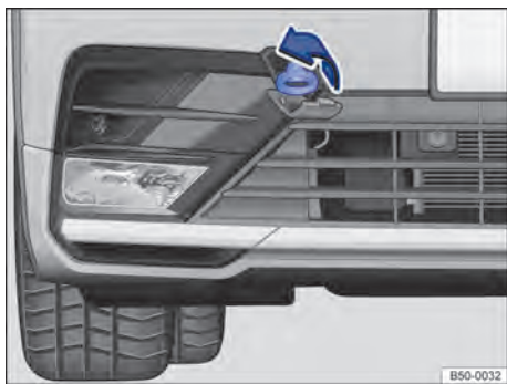
Fig. 231 No para-choque dianteiro à direita: rosquear a argola de reboque.
