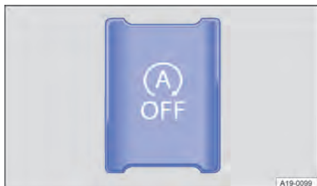
Fig. 133 Na parte inferior do console central: botão do sistema Start-Stop.
