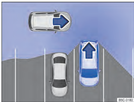
Fig. 174 Representação esquemática do assistente de saída de vaga: área monitorada ao redor do veículo.
