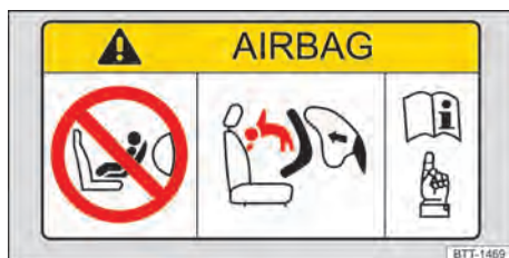
Fig. 53 Representação esquemática: etiqueta do airbag no para-sol.
