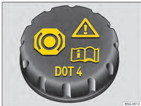
Fig. 241 No compartimento do motor: tampa do reservatório do fluido de freio.
