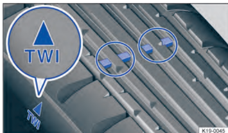
Fig. 248 Perfil do pneu: indicador de desgaste.
