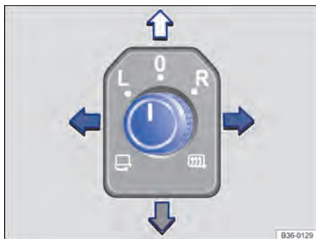
Fig. 119 Na porta do condutor: botão rotativo dos espelhos retrovisores externos.
