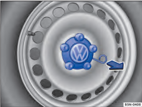
Fig. 250 Retirar a calota central.
