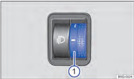
Fig. 112 Ao lado do volante: regulador do alcance do farol ①.
