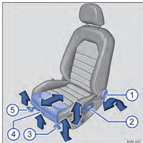
Fig. 87 No banco dianteiro esquerdo: comandos (variante 2).
