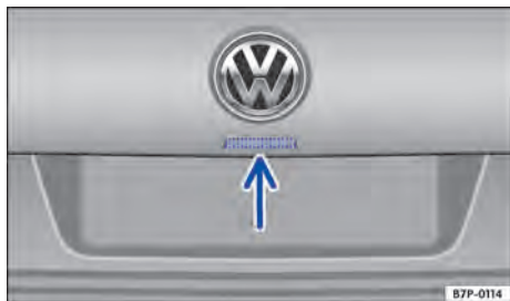
Fig. 76 Na tampa traseira: botão para abrir a tampa traseira.
