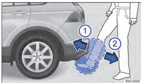
Fig. 80 Tampa traseira com abertura controlada por sensor (Easy Open).
