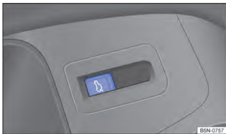
Fig. 78 Na porta do condutor: botão de destravamento da tampa traseira.
