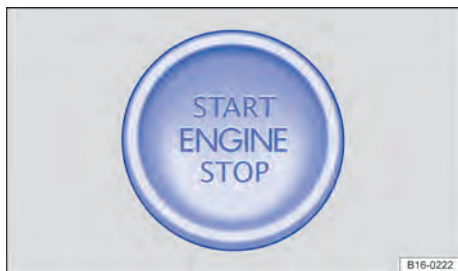
Fig. 131 Na parte inferior do console central: botão de partida para dar partida no motor.
