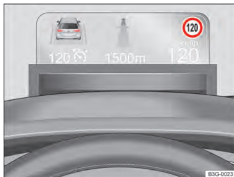
Fig. 19 No painel de instrumentos acima do volante: exemplos de indicações no head-up display.
