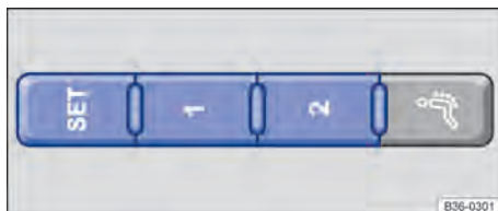
Fig. 102 Parte externa do banco do condutor: botões de memória.
