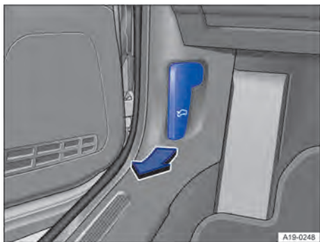
Fig. 233 Na área para os pés no lado do condutor: alavanca de destravamento da tampa dianteira (representação esquemática).
