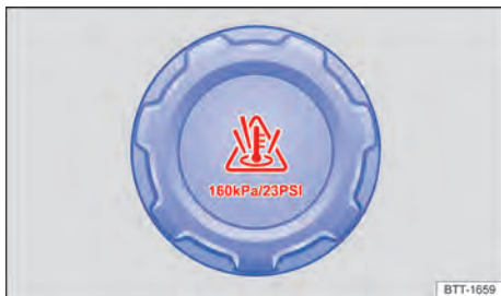
Fig. 240 No compartimento do motor: tampa do reservatório de expansão do líquido de arrefecimento (representação esquemática).
