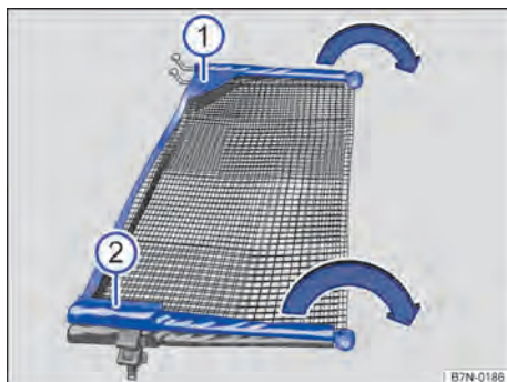
Fig. 193 Abrir a rede divisória.
