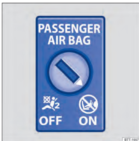
Fig. 44 No painel de instrumentos no lado do passageiro dianteiro ou no porta-objetos: interruptor acionado pela chave para desligar e ligar o airbag frontal do passageiro dianteiro.
