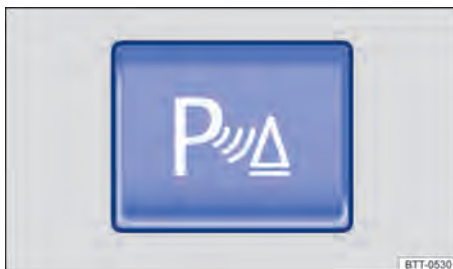
Fig. 147 No console central: botão para ligar e desligar o auxílio de estacionamento (dependendo da versão).
