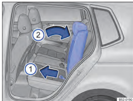
Fig. 83 Ajustar o encosto do banco traseiro.
