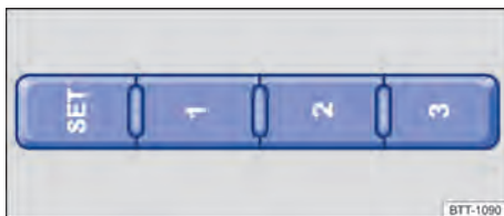
Fig. 92 Parte externa do banco do condutor: botões de memória.
