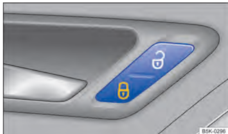
Fig. 61 Na porta do condutor: botão do travamento central.
