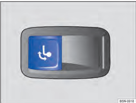
Fig. 187 À esquerda do compartimento de bagagem: botão para destravamento da rótula de engate. A rótula de engate do dispositivo de reboque está localizada no para-choque. A rótula de engate destravável eletricamente é girada para fora mecanicamente para uso e não pode ser removida.
