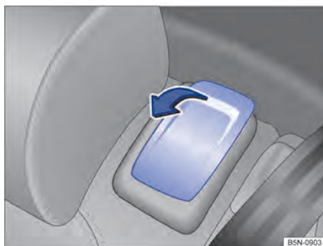
Fig. 95 Segunda fileira de assentos: comandos do auxílio na entrada.
