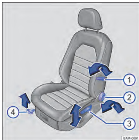
Fig. 77 No banco dianteiro esquerdo: comandos (variante 1).
