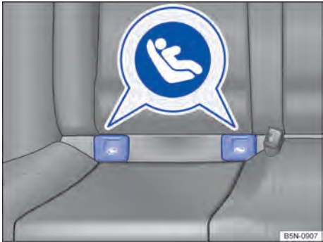
Fig. 54 No banco do veículo: identificação dos pontos de ancoragem ISOFIX para cadeiras de criança.
