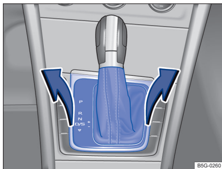
Fig. 128 Desinstalar a cobertura do quadro da alavanca seletora.
