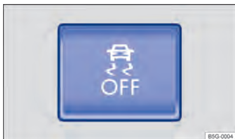
Fig. 195 Na parte inferior do console central: botão para desligar e ligar manualmente o controle de tração, o controle de tração com programa eletrônico de estabilidade ou o ESC Sport.
