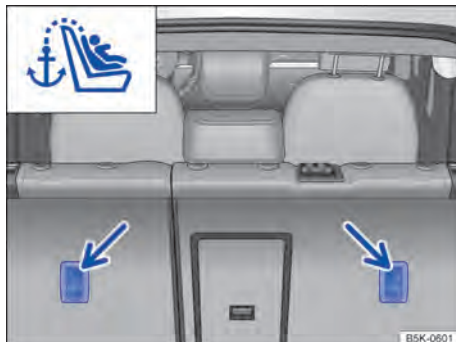
Fig. 28 Olhais de retenção para o cinto de fixação superior no lado de trás do banco traseiro.
