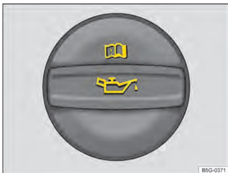
Fig. 258 No compartimento do motor: tampa da abertura para enchimento de óleo do motor (representação esquemática).
