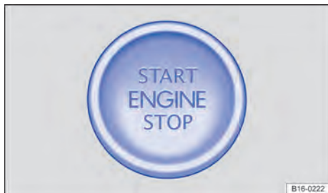
Fig. 134 Na parte inferior do console central: botão de partida para ativação do motor.
