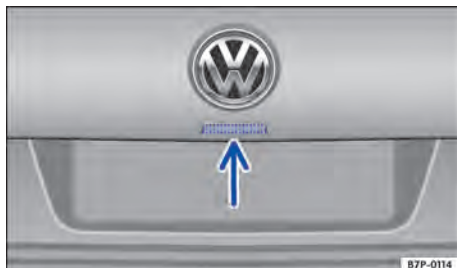
Fig. 82 Na tampa do compartimento de bagagem: botão para abrir a tampa do compartimento de bagagem.
