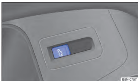
Fig. 70 Na porta do condutor: destravamento da tampa do compartimento de bagagem.
