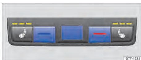
Fig. 123 No console central traseiro: comandos para regular a temperatura para os assentos traseiros.
