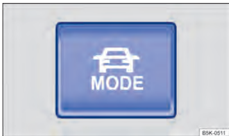
Fig. 144 Na parte inferior do console central: botão de seleção do perfil de condução.
