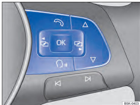
Fig. 59 Lado direito do volante multifunções: botões para comando dos menus e das exibições de informações no display do instrumento combinado.
