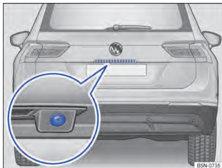
Fig. 186 Na traseira do veículo: local de instalação da câmera de marcha a ré.
