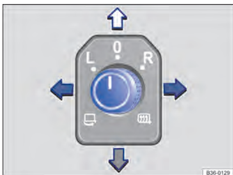
Fig. 117 Na porta do condutor: botão rotativo dos espelhos retrovisores externos.
