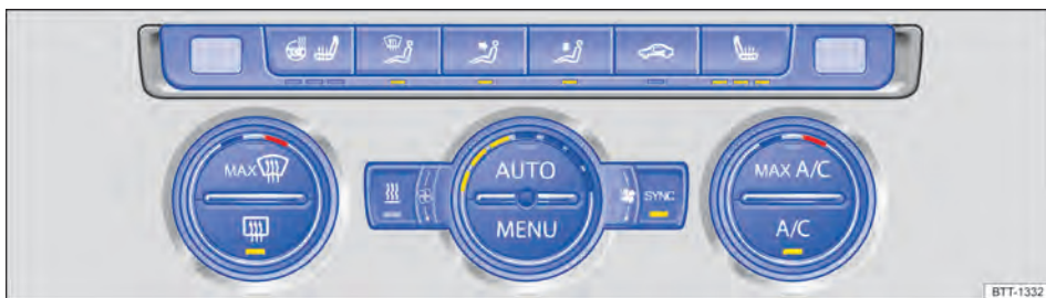
Fig. 122 Na parte superior do console central: comandos do Climatronic.
