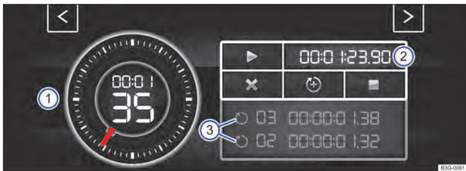
Fig. 62 No display do sistema Infotainment: Laptimer com cronômetro, superfície de função e tempos de voltas.
