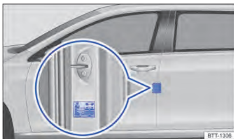
Fig. 267 Na coluna da porta do condutor: etiqueta de pressão dos pneus (alternativamente no lado interno da portinhola do tanque).
