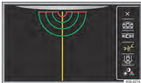
Fig. 185 Exibição do display da câmera de marcha a ré: assistente de reboque.
