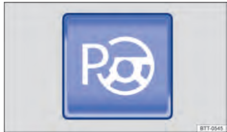
Fig. 187 Na parte inferior do console central: botão para ligar o assistente de direção para estacionamento.
