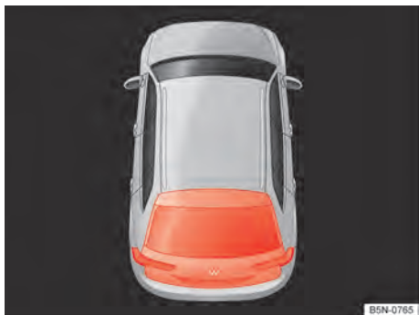
Fig. 80 No display do instrumento combinado: tampa do compartimento de bagagem aberta ou fechada incorretamente.
