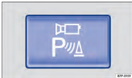
Fig. 191 Na parte superior do console central: botão para ligar manualmente a visão do ambiente.
