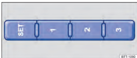
Fig. 102 Na parte externa do banco do condutor: botões da memória.
