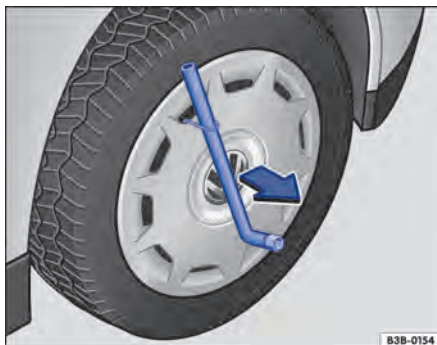
Fig. 272 Retirar a calota integral.
