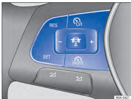
Fig. 159 Lado esquerdo do volante multifunções: botões para comandar a regulação automática de distância.
