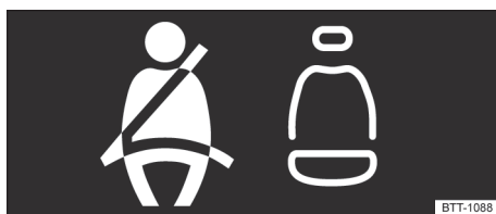
Fig. 3 No display do instrumento combinado: indicador de status do cinto de segurança para os assentos traseiros.
