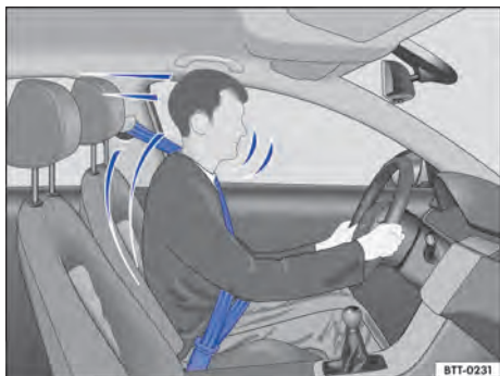
Fig. 8 Conductor protegido pelo cinto de segurança colocado corretamente em uma manobra de frenagem súbita.
