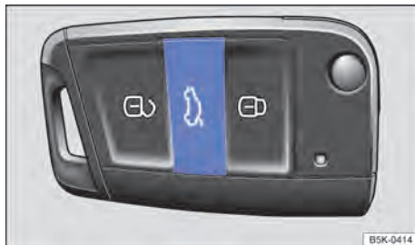
Fig. 81 Na chave do veículo: botão para destravar a tampa do compartimento de bagagem.
