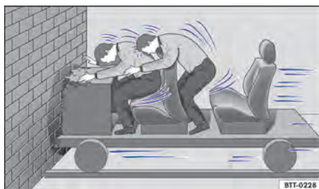
Fig. 5 Um veículo com os ocupantes do veículo sem cintos de segurança colide com o muro.
