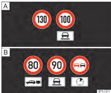
Fig. 53 No display do instrumento combinado: exemplos de limites de velocidade e proibição de ultrapassagem com placas adicionais associadas.
