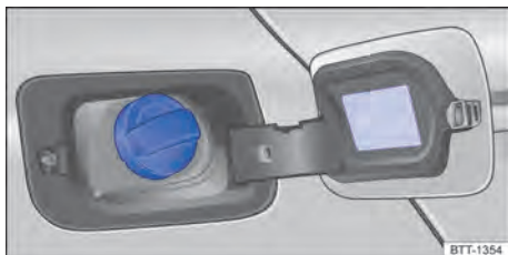
Fig. 228 Representação esquemática: portinhola do tanque aberta com a tampa do tanque.
