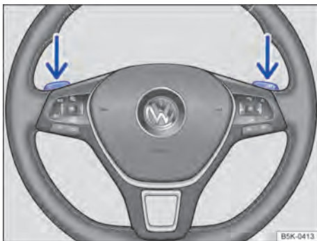
Fig. 141 Volante com seletores basculantes do Tiptronic.
