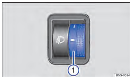
Fig. 110 Ao lado do volante: regulador da regulagem de alcance do farol ①. ▶
