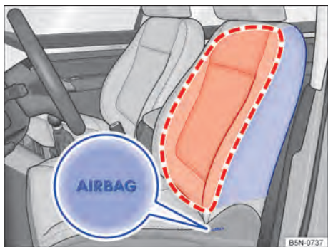
Fig. 19 Lateralmente no assento dianteiro: local de instalação e área de expansão dos airbags laterais.
