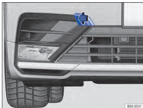
Fig. 250 No para-choque dianteiro à direita: capa de cobertura para o alojamento da argola de reboque.
