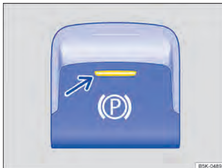
Fig. 173 Na parte inferior do console central: botão do freio de estacionamento eletrônico.
