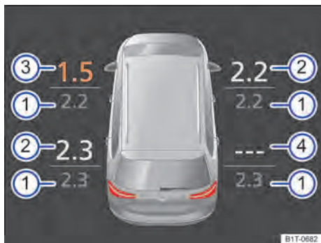
Fig. 264 Representação esquemática da exibição do display do instrumento combinado: pressões dos pneus atuais.
