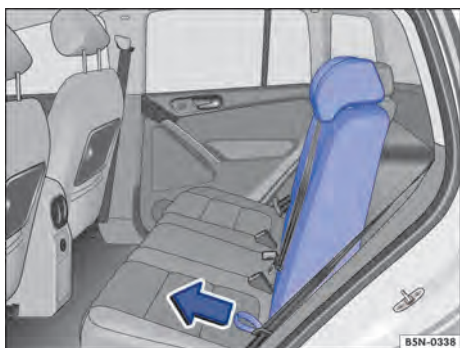
Fig. 96 Rebater o encosto do banco traseiro para frente e de volta.
