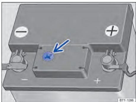
Fig. 263 Visor no lado superior da bateria do veículo (representação esquemática).
