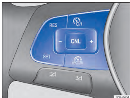
Fig. 153 Lado esquerdo do volante multifunções: botões para comandar o sistema regulador de velocidade. ▶
