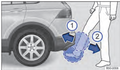
Fig. 84 Tampa do compartimento de bagagem com abertura controlada por sensor (Easy Open).
