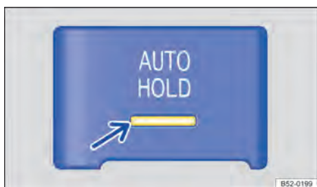
Fig. 174 Na parte inferior do console central: botão do Auto Hold.
