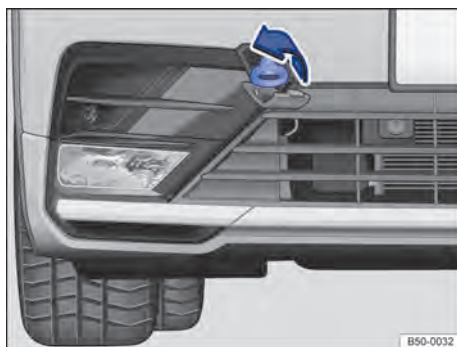
Fig. 251 No para-choque dianteiro à direita: rosquear a argola de reboque.
