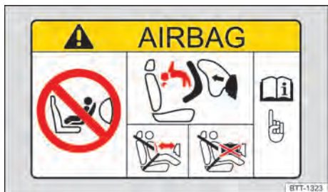
Fig. 24 Representação esquemática: etiqueta de airbag no para-sol.
