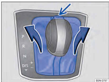
Fig. 142 Desinstalar a cobertura do quadro da alavanca seletora.
