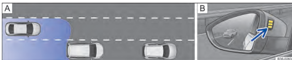
Fig. 170 A) Situação de condução ao ultrapassar com o trânsito traseiro. B) Indicação visual no espelho retrovisor externo esquerdo.
