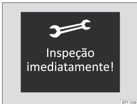
Fig. 56 No display do instrumento combinado: exemplo de indicação para um evento de serviço próximo de vencer (representação esquemática).
