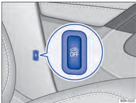
Fig. 31 Ao lado do banco do condutor: botão para desligar o monitoramento do interior do veículo e o alarme antirrebocagem.
