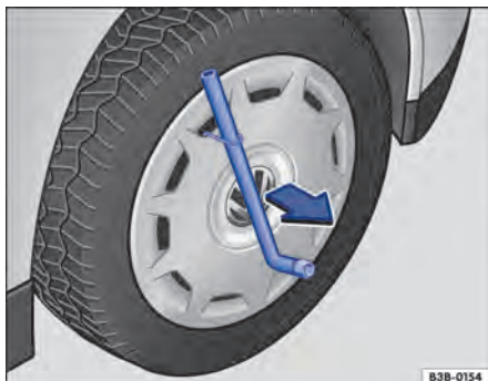
Fig. 230 Retirar a calota integral.
