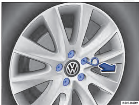
Fig. 231 Remover as capas de cobertura dos parafusos de roda.
