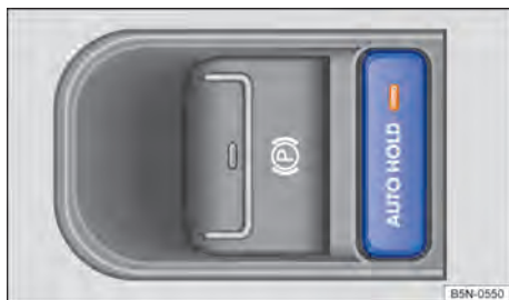
Fig. 153 Na parte inferior do console central: botão para Auto Hold.
