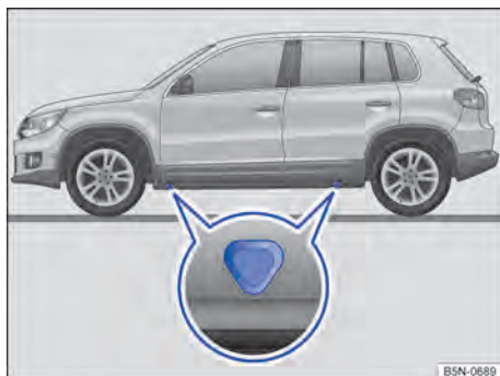
Fig. 234 Pontos de apoio do macaco.
