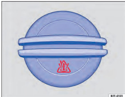
Fig. 200 No compartimento do motor: tampa do reservatório do líquido de arrefecimento do motor.
