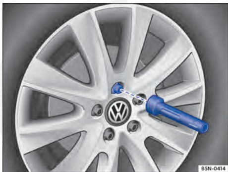
Fig. 236 Troca de roda: desaparafusar os parafusos de roda com o punho da chave de fenda.
