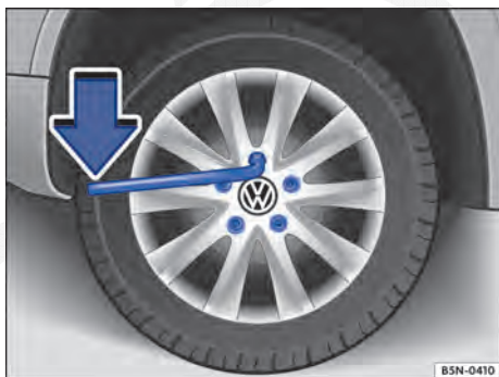
Fig. 232 Troca de roda: Afrouxar os parafusos de roda.
