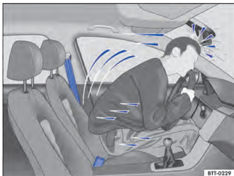
Fig. 62 O condutor sem cinto de segurança é lançado para frente.
