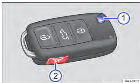
Fig. 22 Chave do veículo com botão do alarme.
