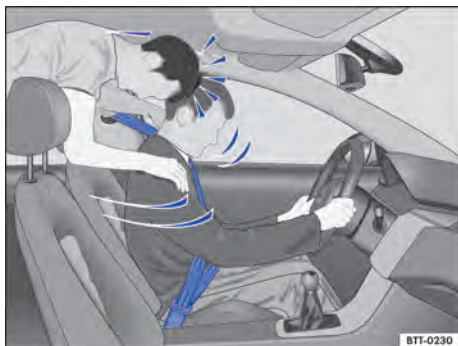
Fig. 63 O passageiro sem cinto de segurança no banco traseiro é lançado para frente sobre o condutor com cinto de segurança.
