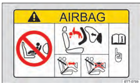
Fig. 77 Representação esquemática: etiqueta de airbag no para-sol.
