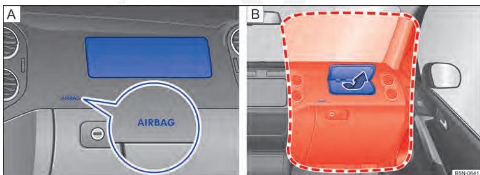
Fig. 72 (A) Local de instalação e (B) área de expansão do airbag frontal do passageiro dianteiro.
