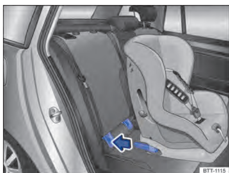
Fig. 81 Representação esquemática: instalar a cadeira de criança ISOFIX com os braços de apoio.
