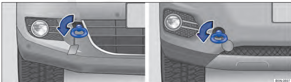
Fig. 254 No para-choque dianteiro à direita: rosquear a argola de reboque.
