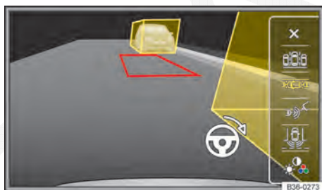
Fig. 162 Exibição do display da câmera de marcha a ré: modo 2 ligado.
