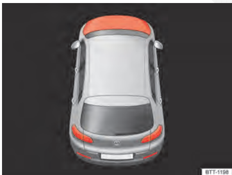
Fig. 193 Representação esquemática no display do instrumento combinado: tampa do compartimento do motor aberta ou fechada incorretamente.
