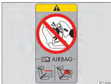
Fig. 78 Representação esquemática: etiqueta de airbag na coluna B.
