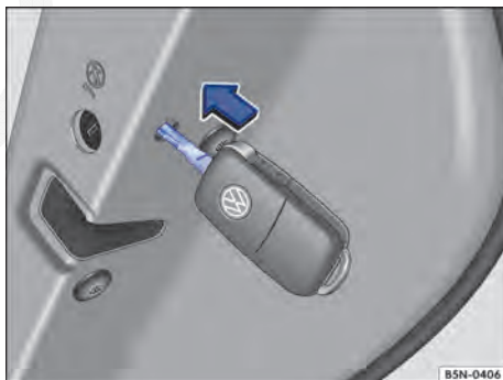
Fig. 221 Travamento de emergência do veículo com a chave do veículo.
