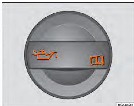
Fig. 197 No compartimento do motor: tampa da abertura para enchimento de óleo do motor.
