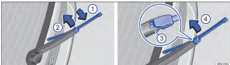
Fig. 211 Substituir a palheta do limpador do vidro traseiro.
