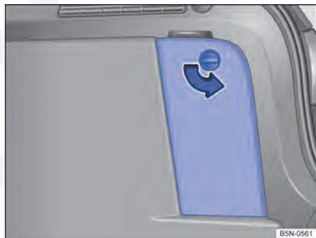
Fig. 126 No compartimento de bagagem à direita: porta-objetos lateral.
