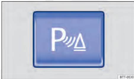
Fig. 155 No console central: botões para ligar e desligar o Park Pilot (dependendo da versão).
