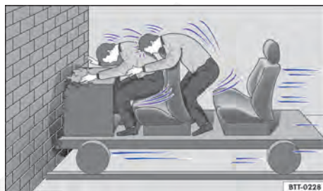
Fig. 61 Um veículo com os ocupantes do veículo sem cintos de segurança colide com o muro.
