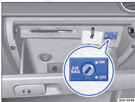
Fig. 73 No porta-luvas: interruptor acionado pela chave para desligar e ligar o airbag frontal do passageiro dianteiro.
