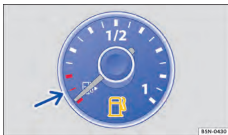
Fig. 184 No instrumento combinado: indicador do nível de combustível para gasolina e óleo diesel.
