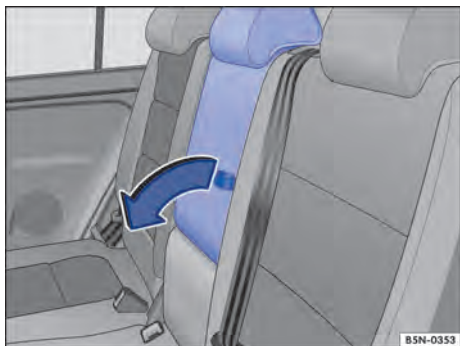
Fig. 98 No encosto do banco traseiro: abrir o dispositivo para transporte de objetos longos.
