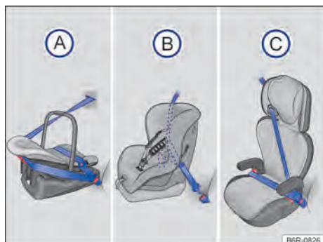
Fig. 38 As ilustrações (A), (B) e (C) mostram a fixação do sistema de retenção para crianças apenas com o cinto de segurança do veículo.
