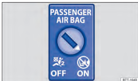
Fig. 34 No painel de instrumentos no lado do passageiro dianteiro: interruptor acionado pela chave para desligar e ligar o airbag frontal do passageiro dianteiro.
