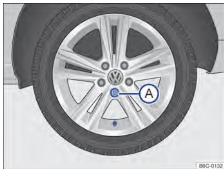
Fig. 163 Troca de roda: sequência de remoção dos parafusos da roda.
