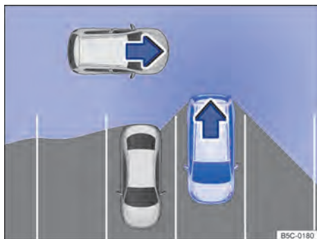
Fig. 102 Área monitorada ao redor do veículo que irá sair da vaga de estacionamento (representação esquemática).
