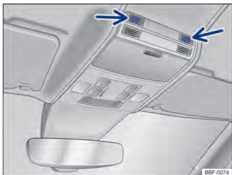
Fig. 56 No console do teto: sensores de monitoramento do interior do veículo (setas).
