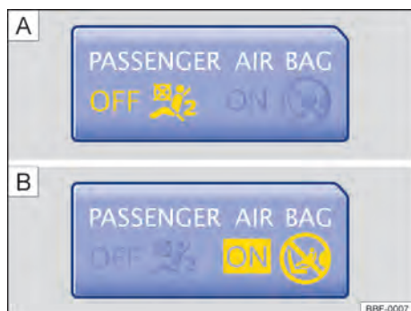
Fig. 31 Na parte superior do console central: luz de controle para o airbag frontal do passageiro dianteiro desligado [A] ou luz de controle para o airbag frontal do passageiro dianteiro ligado [B].
