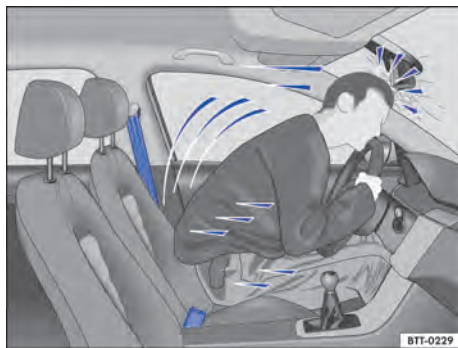
Fig. 23 O condutor sem cinto de segurança é lançado para frente.
