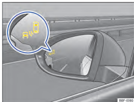
Fig. 114 Nos vidros dos espelhos retrovisores externos: indicador do sensor de “ponto cego”.
