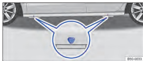
Fig. 183 Pontos de apoio do macaco.
