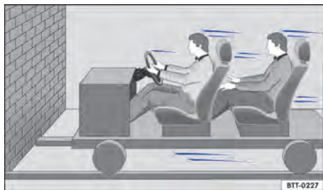
Fig. 21 Um veículo com os ocupantes sem cintos de segurança está em rota de colisão com um muro.
