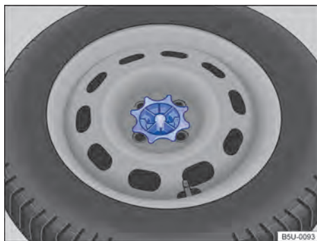
Fig. 180 No compartimento de bagagem: manípulo para fixação da roda de emergência.
