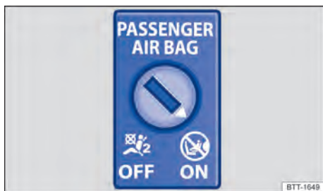
Fig. 34 No painel de instrumentos no lado do passageiro dianteiro: interruptor acionado pela chave para desligar e ligar o airbag frontal do passageiro dianteiro.
