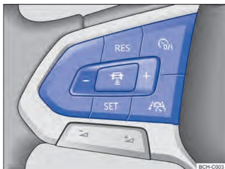
Fig. 109 Lado esquerdo do volante multifunções: botões para comandar o ACC. (variante 2)
