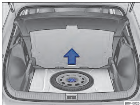
Fig. 149 No compartimento de bagagem, sob o revestimento de assoalho: roda de emergência e ferramentas de bordo.
