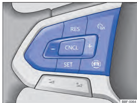
Fig. 102 Lado esquerdo do volante multifunções (variante 2): botões para comandar o GRA.
