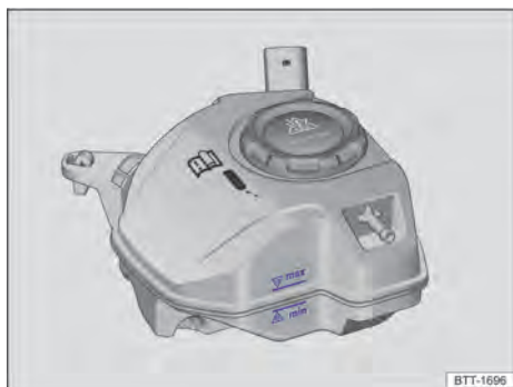
Fig. 172 No compartimento do motor: marcação no reservatório de expansão do líquido de arrefecimento do motor.
