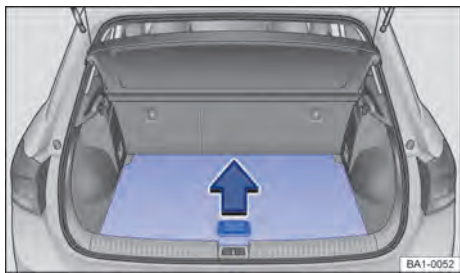
Fig. 144 No compartimento de bagagem: levantar o assoalho do compartimento de bagagem.
