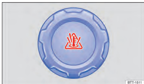
Fig. 173 No compartimento do motor: tampa do reservatório de expansão do líquido de arrefecimento do motor.
