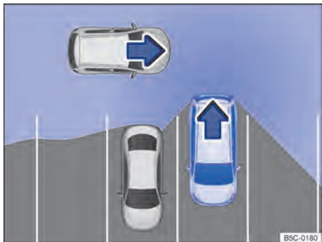
Fig. 123 Área monitorada ao redor do veículo que irá sair da vaga de estacionamento (representação esquemática).
