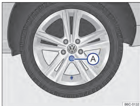
Fig. 185 Retirar a calota integral.
