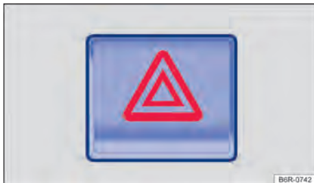
Fig. 42 Na parte superior do console central: interruptor das luzes de advertência.
