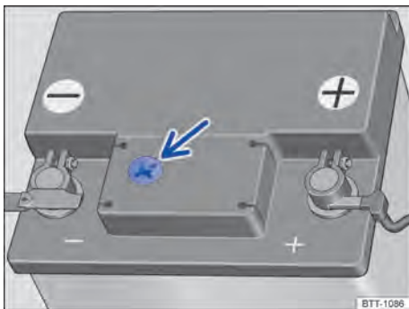
Fig. 175 No compartimento do motor: exemplo de posição do visor no lado superior da bateria do veículo.
