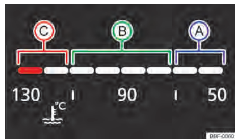
Fig. 13 Indicador de temperatura do líquido de arrefecimento do motor no instrumento combinado digital (variante 2): (A) área fria; (B) área normal; (C) área de alerta.
