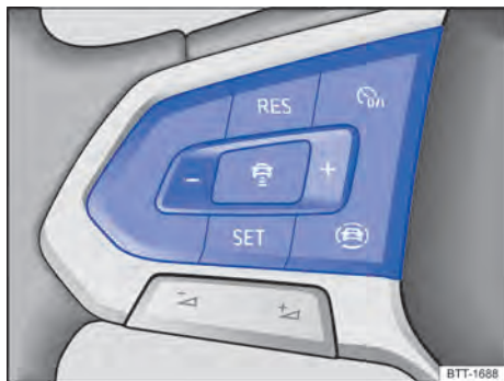
Fig. 108 Lado esquerdo do volante multifunções: botões para comandar o ACC. (variante 1)
