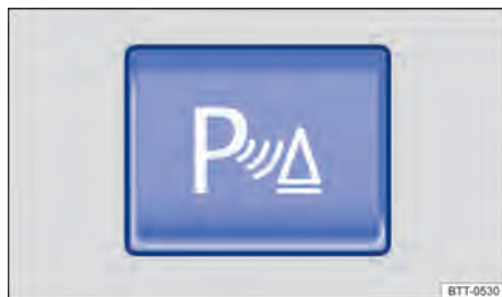
Fig. 116 No console central: botão para ligar e desligar o auxílio de estacionamento.
