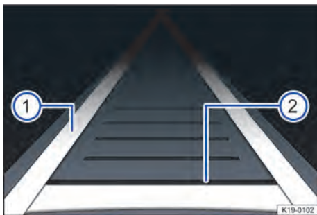
Fig. 112 No display do instrumento combinado: indicador durante o controle ativo.
