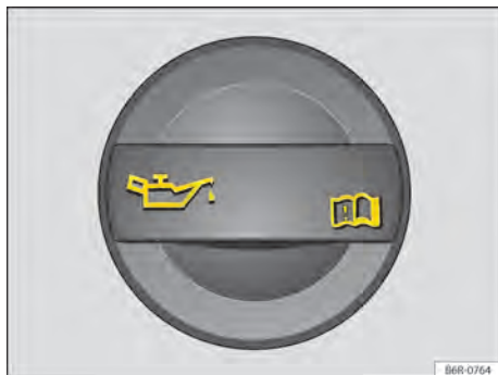
Fig. 171 No compartimento do motor: tampa da abertura para enchimento de óleo do motor.
