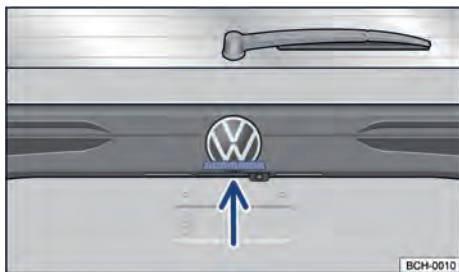
Fig. 57 Na tampa traseira: botão para abrir a tampa traseira.
