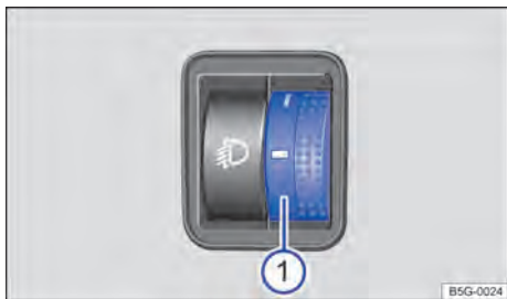
Fig. 75 Ao lado do volante: regulador do alcance do farol ①.
