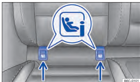
Fig. 40 No banco do veículo: identificação dos pontos de ancoragem inferiores para cadeiras de criança.
