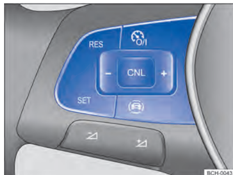
Fig. 101 Lado esquerdo do volante multifunções (variante 1): botões para comandar o GRA
