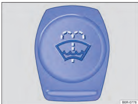
Fig. 169 No compartimento do motor: tampa do reservatório de água dos lavadores dos vidros.
