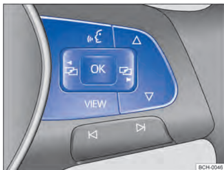
Fig. 15 Lado direito do volante multifunções (variante 1): botões para comando dos menus e exibições de informação do instrumento combinado.
