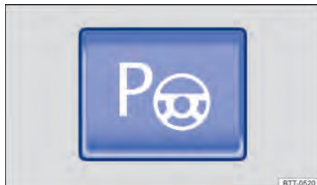
Fig. 119 No console central: botão para ligar o assistente de direção para estacionamento.
