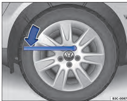
Fig. 182 Troca de roda: soltar os parafusos da roda.
