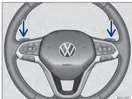
Fig. 96 Volante com seletores basculantes do Tiptronic.
