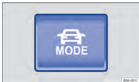
Fig. 98 Na parte superior do console central: botão MODE de seleção do perfil de condução.
