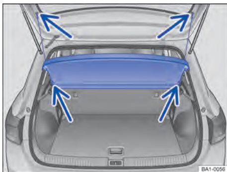
Fig. 143 No compartimento de bagagem: remover e instalar a cobertura do compartimento de bagagem.
