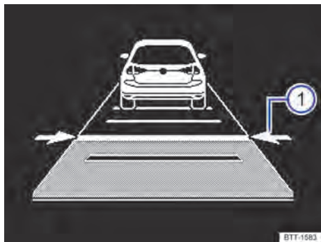
Fig. 110 No display do instrumento combinado: ajustar a distância (representação esquemática, o ACC regula).
