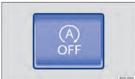
Fig. 93 Na parte superior do console central: botão do sistema Start-Stop.
