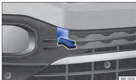
Fig. 159 No para-choque dianteiro à direita: soltar e remover a cobertura.
