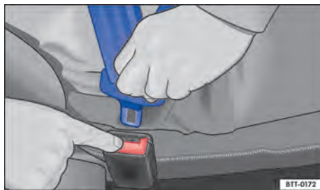
Fig. 28 Solta a lingueta do cinto de segurança do fecho do cinto de segurança.
