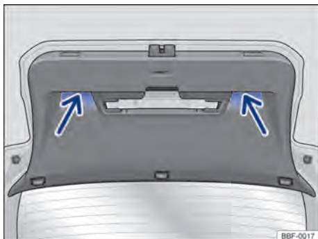
Fig. 59 Tampa traseira aberta: rebaisos (setas) para puxar e fechar.
