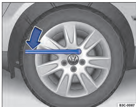
Fig. 217 Troca de roda: soltar os parafusos da roda.
