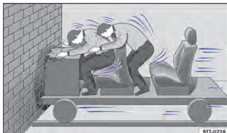
Fig. 26 Um veículo com os ocupantes sem cintos de segurança colide com o muro.
