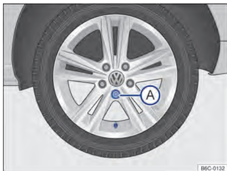
Fig. 216 Retirar a calota integral.
