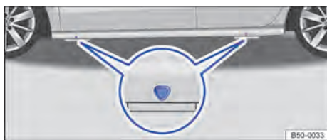
Fig. 218 Pontos de apoio do macaco.
