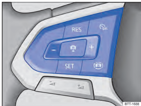
Fig. 107 Lado esquerdo do volante multifunções: botões para comandar o ACC.
