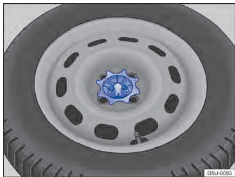
Fig. 214 No compartimento de bagagem: manípulo para fixação da roda de emergência.
