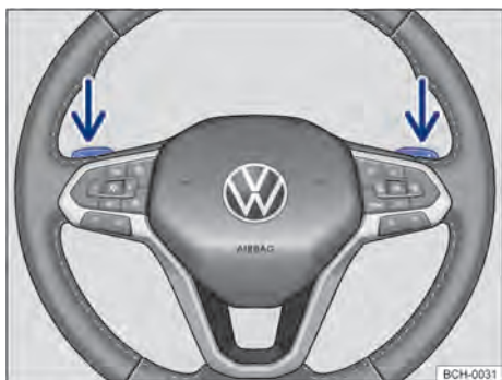
Fig. 98 Volante com seletores basculantes do Tiptronic.
