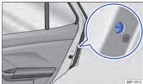
Fig. 58 Na porta traseira: travamento de emergência.
