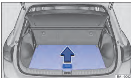
Fig. 176 No compartimento de bagagem: levantar o assoalho do compartimento de bagagem.
