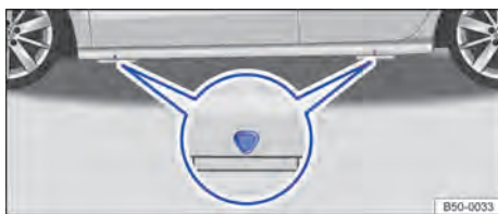
Fig. 221 Pontos de apoio do macaco.
