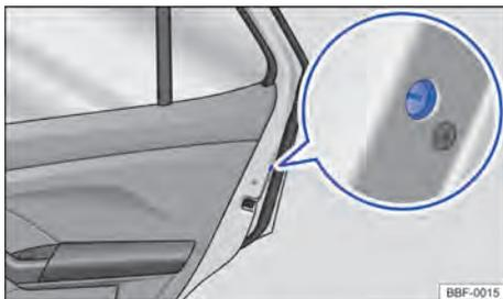
**Fig. 58** Na porta traseira: travamento de emergência.
