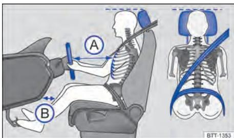
**Fig. 23** Distância correta do condutor em relação ao volante, posição correta do cinto de segurança e ajuste correto do apoio para cabeça.
