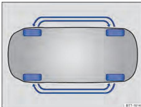
Fig. 206 Esquema para a troca das rodas.
