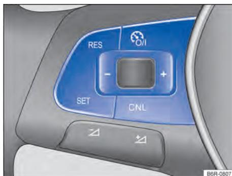
Fig. 103 Lado esquerdo do volante multifunções (variante 1): botões para comandar o GRA.
