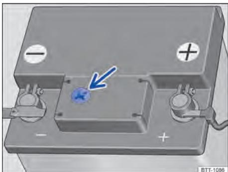
**Fig. 204** No compartimento do motor: exemplo de posição do visor no lado superior da bateria do veículo.
