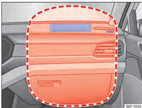
**Fig. 37** Local de instalação e área de expansão do airbag frontal do passageiro dianteiro.
