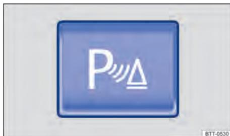
**Fig. 106** No console central: botão para ligar e desligar o auxílio de estacionamento.
