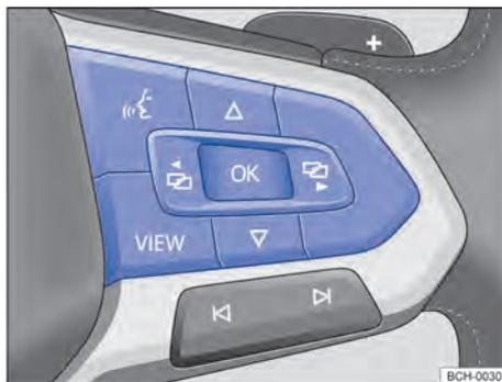
**Fig. 21** Lado direito do volante multifunções (variante 2): botões para comando dos menus e exibições de informação do instrumento combinado.
