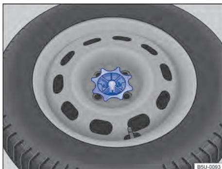
**Fig. 210** No compartimento de bagagem: manipulador para fixação da roda de emergência.
