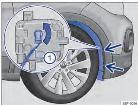
**Fig. 181** Na caixa de roda dianteira: acesso à lâmpada incandescente do farol de neblina.
