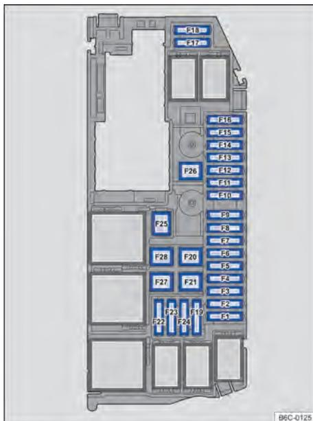
Fig. 187 No compartimento do motor: disposição dos fusíveis.
