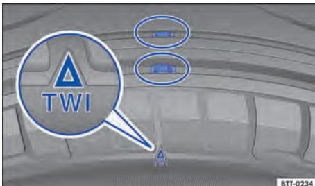
**Fig. 209** Perfil do pneu: indicadores de desgaste.
