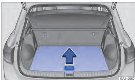
Fig. 169 No compartimento de bagagem: levantar o assoalho do compartimento de bagagem.
