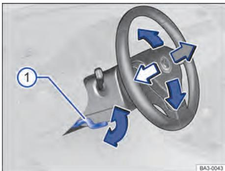
**Fig. 65** Embaixo e a esquerda do volante junto com o revestimento da coluna de direção: alavanca de ajuste da posição do volante.
