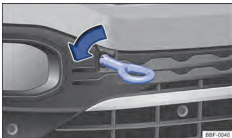
**Fig. 194** No para-choque dianteiro à direita: rosquear a argola de reboque.
