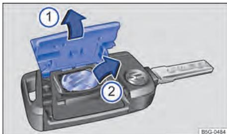
Fig. 52 Chave do veículo: substituir a bateria.
