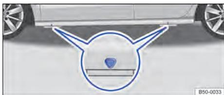
Fig. 214 Pontos de apoio do macaco.
