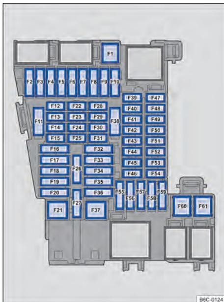
Fig. 185 No painel de instrumentos: disposição dos fusíveis.
