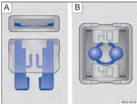
Fig. 189 Fusível queimado: [A] fusível plano, [B] fusível de bloqueio.
