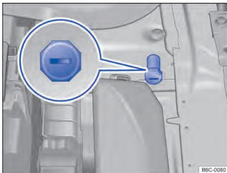
Fig. 191 No compartimento do motor: ponto de auxílio à partida (ponto de aterramento).
