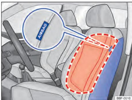
**Fig. 40** Lateralmente no banco dianteiro: localização de instalação e área de expansão dos airbags laterais.
