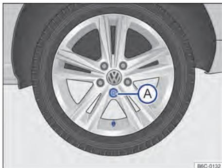
**Fig. 216** Troca de roda: sequência de remoção dos parafusos da roda.
