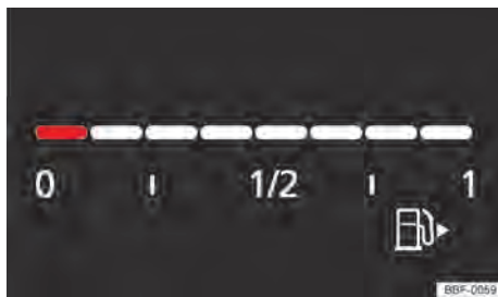
Fig. 14 No instrumento combinado digital: indicador do nível de combustível (variante 2).
