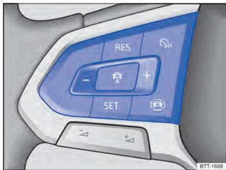
Fig. 110 Lado esquerdo do volante multifunções: botões para comandar o ACC.
