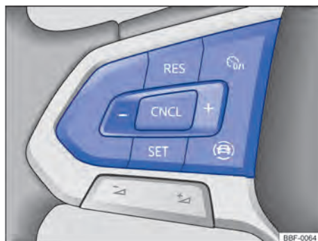
Fig. 106 Lado esquerdo do volante multifunções (variante 2): botões para comandar o limitador de velocidade.
