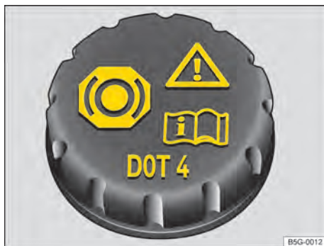
Fig. 210 No compartimento do motor: tampa do reservatório de fluido de freio.
