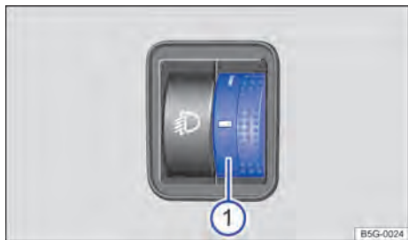
Fig. 78 Ao lado do volante: regulador do alcance do farol ①.
