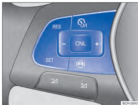
Fig. 103 Lado esquerdo do volante multifunções (variante 1): botões para comandar o GRA
