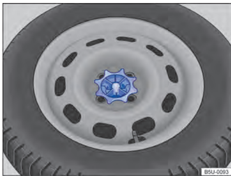
Fig. 217 No compartimento de bagagem: manipulô para fixação da roda de emergência.
