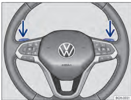
Fig. 98 Volante com seletores basculantes do Tiptronic.
