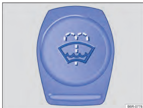
Fig. 205 No compartimento do motor: tampa do reservatório de água dos lavadores dos vidros.
