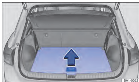
Fig. 128 No compartimento de bagagem: levantar o assoalho do compartimento de bagagem.
