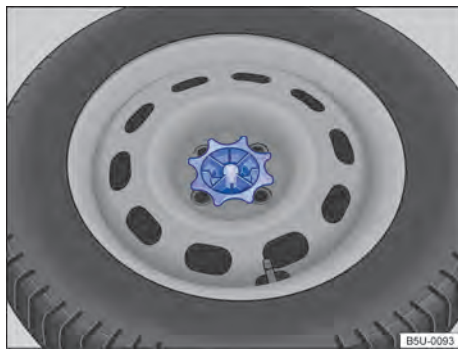
Fig. 169 No compartimento de bagagem: manípulo para fixação da roda de emergência.
