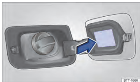
Fig. 167 Na parte interna da portinhola do tanque de combustível: etiqueta com a pressão dos pneus.
