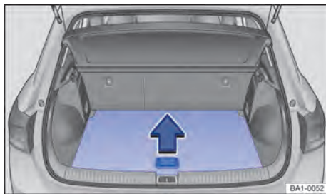
Fig. 119 No compartimento de bagagem: levantar o assoalho do compartimento de bagagem.
