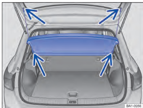
Fig. 118 No compartimento de bagagem: remover e instalar a cobertura do compartimento de bagagem.
