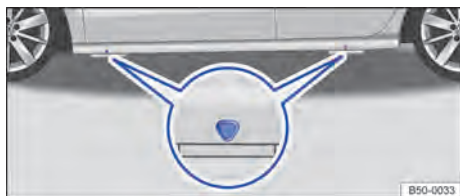
Fig. 164 Pontos de apoio do macaco.
