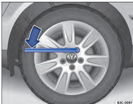
Fig. 162 Troca de roda: soltar os parafusos da roda.
