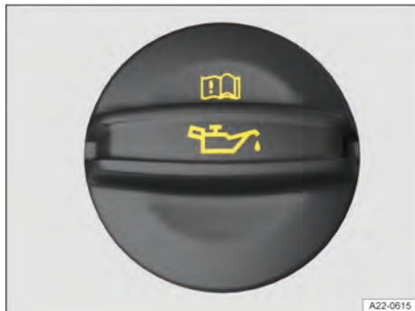
Fig. 176 No compartimento dianteiro: tampa da abertura para enchimento de óleo do motor (representação esquemática).
