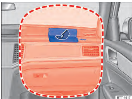
Fig. 29 No lado do passageiro dianteiro: local de instalação e área de expansão do airbag frontal do passageiro dianteiro.
