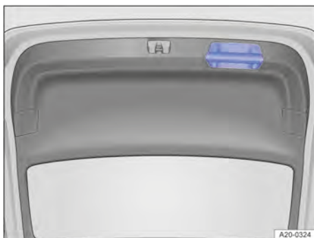
Fig. 56 Na tampa traseira aberta: alça para fechar a tampa traseira.
