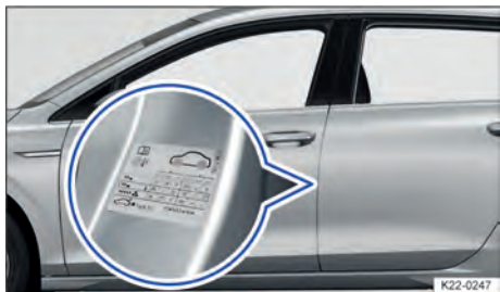
Fig. 183 Na coluna do condutor: etiqueta com as pressões dos pneus (alternativa ao lado interno da portinhola do tanque).
