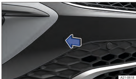
Fig. 165 No para-choque dianteiro à direita: retirar cobertura.
