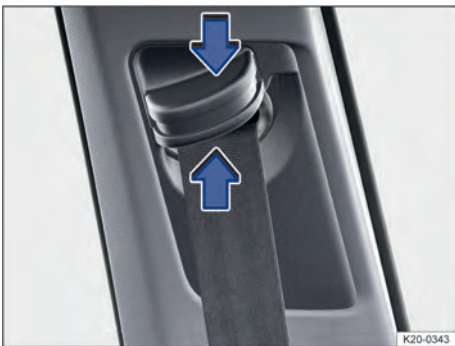
Fig. 27 Ao lado dos bancos dianteiros: regulagem de altura do cinto de segurança.
