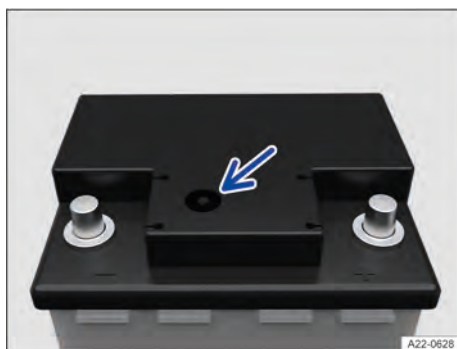
Fig. 181 No lado superior da bateria do veículo 12 V: visor de inspeção da bateria (representação esquemática).
