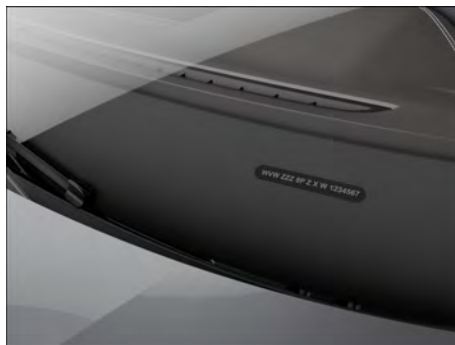
Fig. 246 No para-brisa: número de identificação do veículo.
