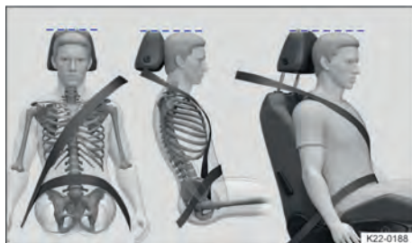
Fig. 25 Posição correta do cadarço do cinto de segurança e ajuste correto do apoio para cabeça (representação esquemática).
