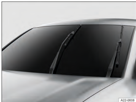
Fig. 153 Limpadores dos vidros na posição de serviço (representação esquemática).
