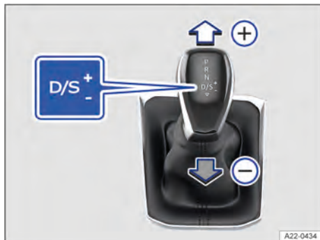
Fig. 94 No console central: alavanca seletora na posição Tiptronic.
