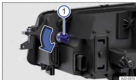
Fig. 156 No compartimento dianteiro à direita: lado de trás do farol.
