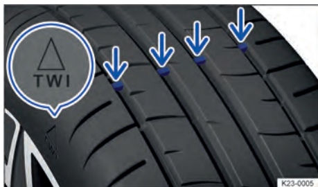
Fig. 187 Nos sulcos do perfil: indicador de desgaste.
