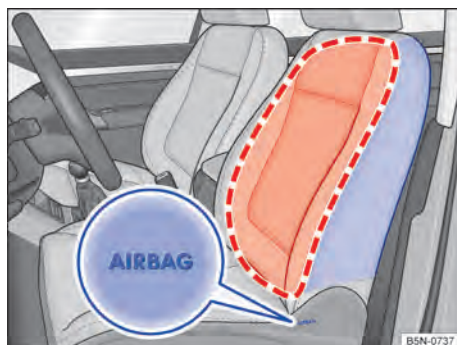
Fig. 33 Lateralmente em ambos os bancos dianteiros: local de instalação e área de expansão do airbag lateral.
