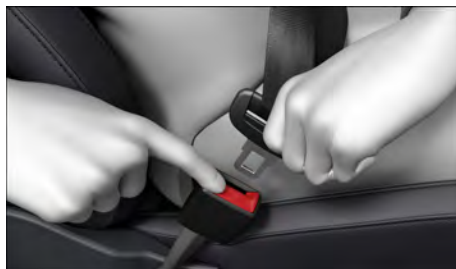
Fig. 24 Soltar a lingueta do cinto de segurança do fecho do cinto de segurança (representação esquemática).
