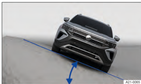
Fig. 100 Representação esquemática: ângulo de inclinação lateral.
