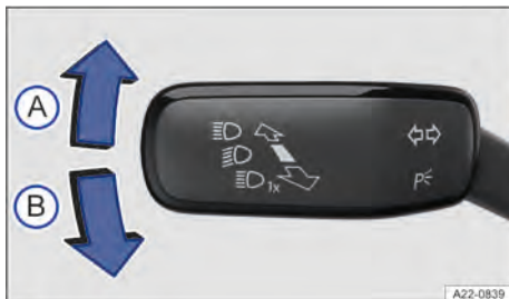
Fig. 78 À esquerda na coluna de direção: alavanca dos indicadores de direção e do farol alto.
