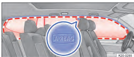
Fig. 35 Em ambos os lados do veículo: local de instalação e área de expansão do airbag para cabeça. <
