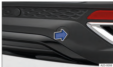
Fig. 167 No para-choque traseiro à direita: remover cobertura.
