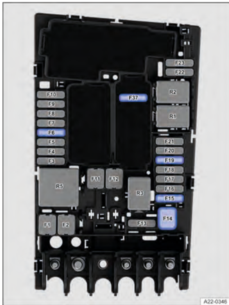
Fig. 158 No compartimento dianteiro: slots para fusíveis.
