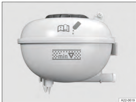
Fig. 179 No compartimento dianteiro: marcas no reservatório de expansão do líquido de arrefecimento (representação esquemática).
