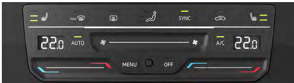
Fig. 87 Na parte superior do console central: painel de comando do ar-condicionado do Climatronic (variante 1).
