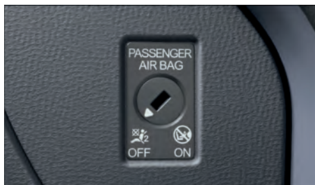
Fig. 30 No painel de instrumentos no lado do passageiro dianteiro: interruptor acionado pela chave para desligar e ligar o airbag frontal do passageiro dianteiro.
