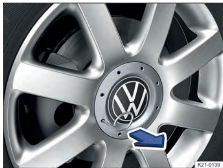
Fig. 191 Retirar a calota central.
