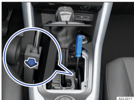
Fig. 97 No console central: destravar emergencialmente o bloqueio da alavanca seletora (variante 2).
