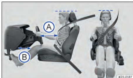
Fig. 21 Distância correta do condutor em relação ao volante, posição correta do cadarço do cinto de segurança e ajuste correto do apoio para cabeça (representação esquemática).
