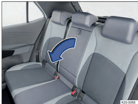
Fig. 73 No encosto do banco central: descansa-braço central traseiro rebatível.
