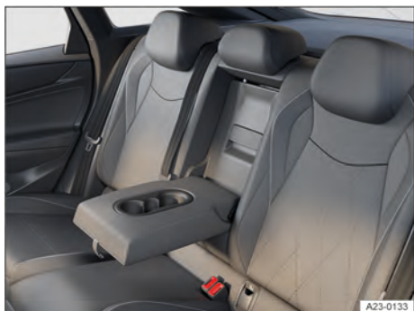
Fig. 130 No descansa-braço central traseiro: porta-copos (representação esquemática).
