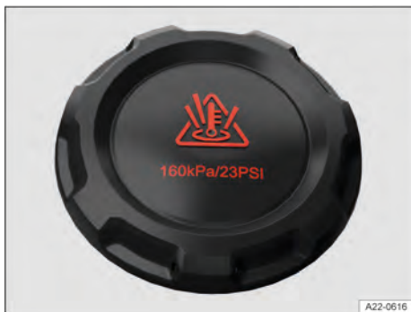
Fig. 178 No compartimento dianteiro: tampa do reservatório de expansão do líquido de arrefecimento (representação esquemática).
