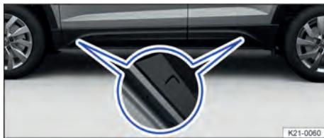
Fig. 195 Na longarina lateral: marcas dos pontos de apoio e do macaco.
