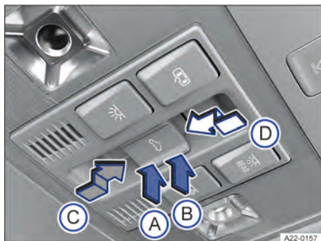
Fig. 60 No revestimento do teto: botão do teto de vidro.
