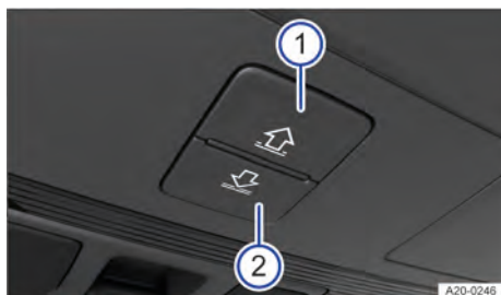
Fig. 86 No revestimento do teto: botões de comando da cortina de proteção solar.
