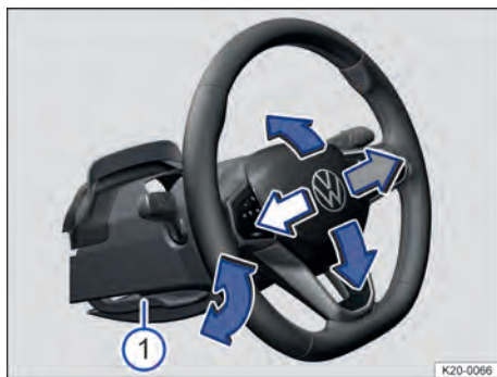
Fig. 61 Embaixo do volante no revestimento da coluna de direção: alavanca de ajuste mecânico da posição do volante (representação esquemática).
