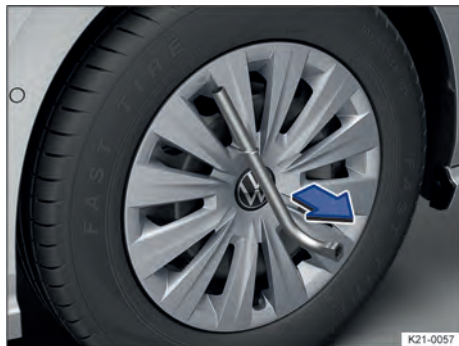
Fig. 192 Retirar a calota integral.
