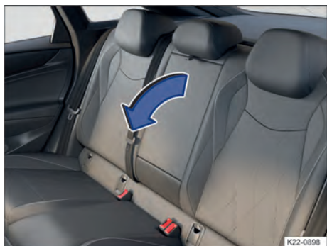
Fig. 129 No encosto do banco do central: descansa-braço central traseiro rebatível para fora (representação esquemática).
