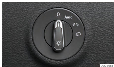
Fig. 75 Ao lado do volante: interruptor das luzes.
