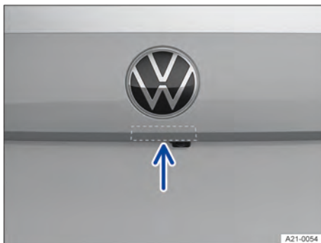
Fig. 55 Na tampa traseira: botão para abrir a tampa traseira (representação esquemática).
