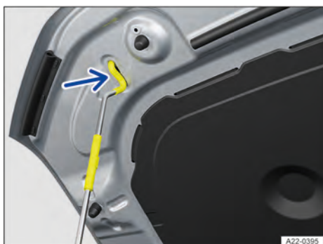
Fig. 172 Na tampa dianteira: alojamento para a haste de sustentação da tampa (representação esquemática).
