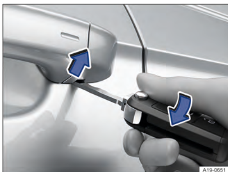
Fig. 51 Maçaneta da porta do condutor: alavancar a capa de cobertura para fora.
