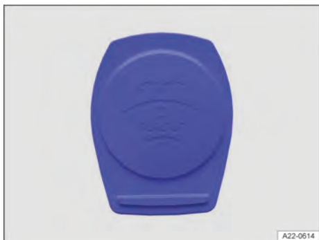
Fig. 173 No compartimento dianteiro: tampa do reservatório de água dos lavadores dos vidros (representação esquemática).
