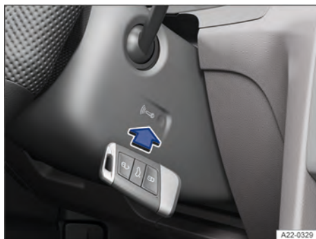
Fig. 91 À direita na coluna de direção: função de partida de emergência em veículos com sistema de travamento e de partida Keyless Access sem chave.
