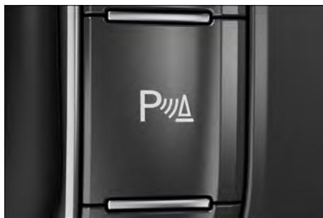
Fig. 121 No console central: botão do auxílio de estacionamento (conforme a versão).
