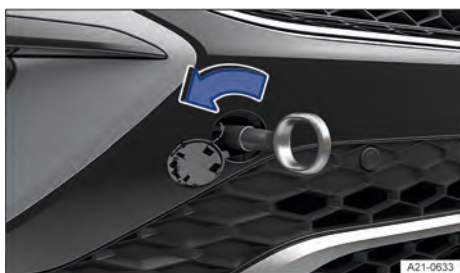
Fig. 166 No para-choque dianteiro à direita: rosquear a argola de reboque.
