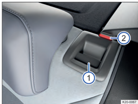
Fig. 66 No encosto do banco traseiro: botão de destravamento.
