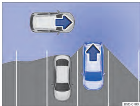
Fig. 127 Área monitorada ao redor do veículo que irá sair da vaga de estacionamento (representação esquemática).
