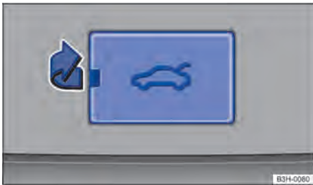
Fig. 57 Na tampa traseira: cobertura do destravamento de emergência da tampa traseira.
