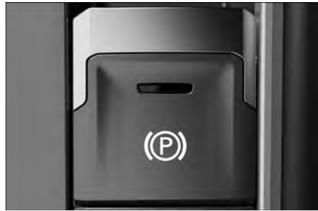
Fig. 119 No console central: botão do freio de estacionamento eletrônico.
