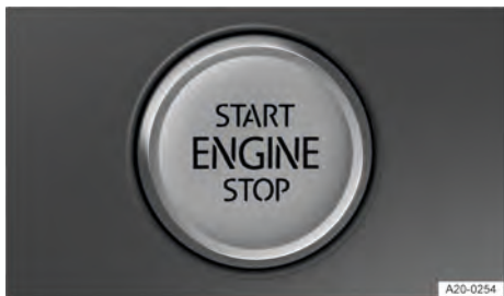
Fig. 90 Na parte inferior do console central: botão de partida.
