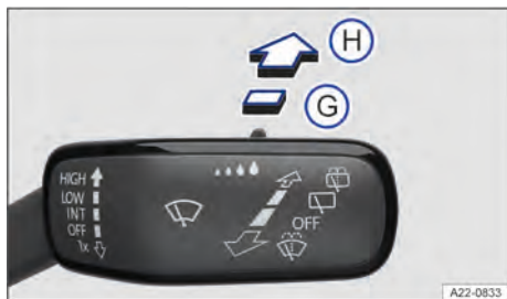
Fig. 80 À direita da coluna de direção: comandar o limpador do vidro traseiro.
