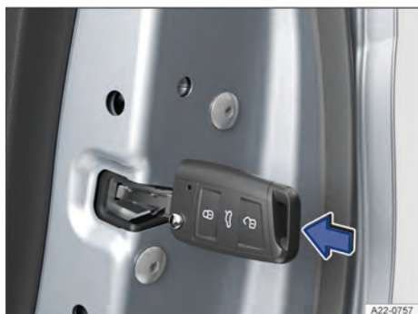
Fig. 53 Na parte dianteira de uma porta: travamento de emergência do veículo com a haste da chave ou a chave de emergência (variante 2).
