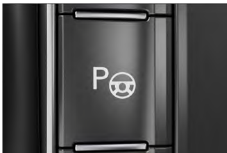
Fig. 123 No console central: botão do Park Assist (conforme a versão).
