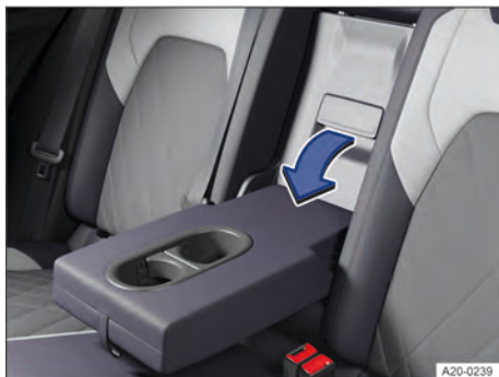
Fig. 139 No encosto do banco traseiro: dispositivo para transporte de objetos longos (representação esquemática).
