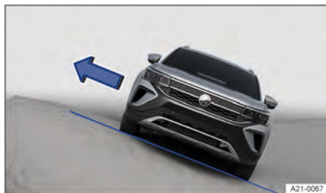
Fig. 102 Representação esquemática: desembarcar do lado do veículo voltado para cima da encosta.
