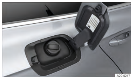
Fig. 150 Atrás da portinhola do tanque: tampa do tanque (representação esquemática).
