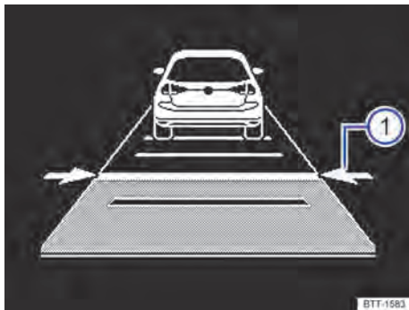
Fig. 116 No display do instrumento combinado: distância ajustada no caso de regulação (representação esquemática).
