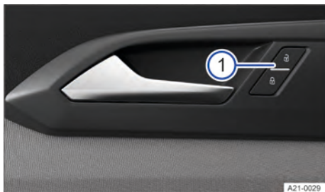
Fig. 50 Na porta do condutor: botão do travamento central (representação esquemática).
