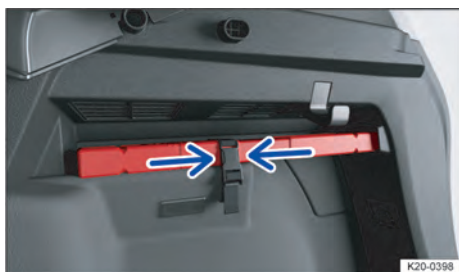
Fig. 42 No compartimento de bagagem do lado direito: suporte do triângulo de segurança.
