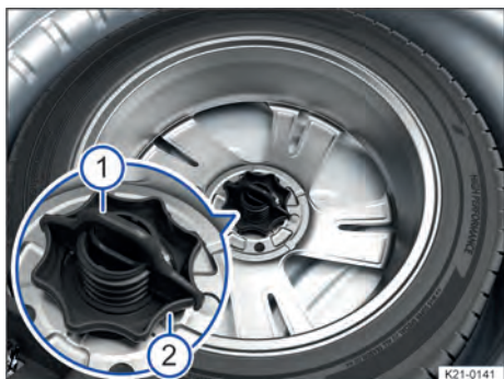
Fig. 190 Sob o assoalho do compartimento de bagagem: manípulo para fixação da roda sobressalente ou da roda de emergência.
