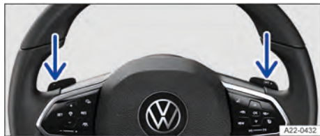
Fig. 95 Atrás do volante: seletores basculantes para o Tiptronic.
