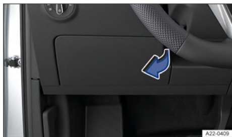
Fig. 159 No lado do condutor no painel de instrumentos: cobertura da caixa de fusíveis (representação esquemática).
