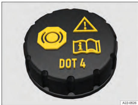
Fig. 180 No compartimento dianteiro: tampa do reservatório do fluido de freio.
