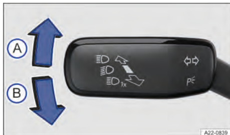
Fig. 74 À esquerda na coluna de direção: alavanca dos indicadores de direção e do farol alto.
