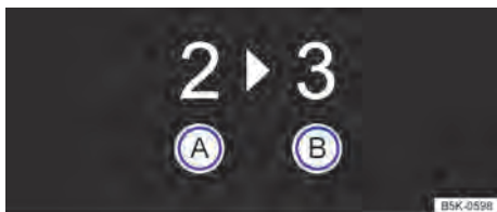
Fig. 103 No display do instrumento combinado: recomendação de marcha.
