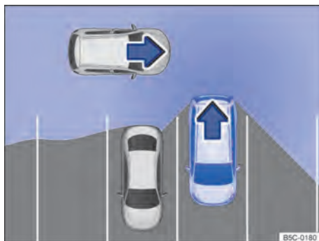
Fig. 113 Representação esquemática do assistente de saída de vaga: área monitorada ao redor do veículo.
