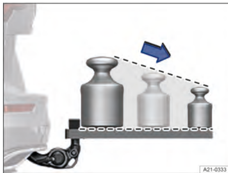
Fig. 126 Distribuição de peso recomendada no sistema de bagageiro traseiro
