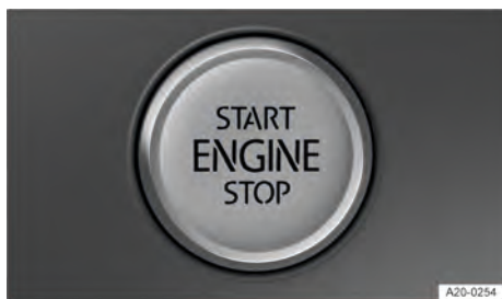
Fig. 87 Na parte inferior do console central: botão de partida para dar partida no motor.
