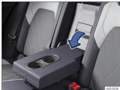
Fig. 123 Dispositivo para transporte de objetos longos no encosto do banco traseiro (representação esquemática).
