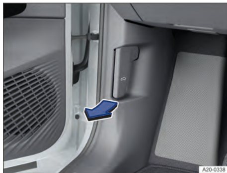
Fig. 149 Na área para os pés do lado do condutor: alavanca de destravamento da tampa dianteira (representação esquemática).
