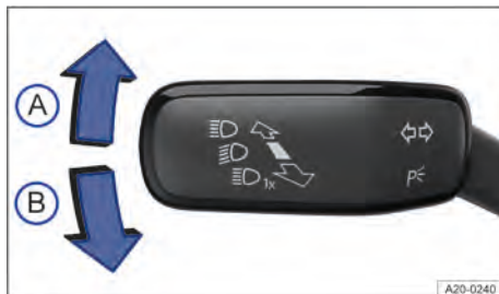
Fig. 70 À esquerda na coluna de direção: alavanca dos indicadores de direção e do farol alto.
