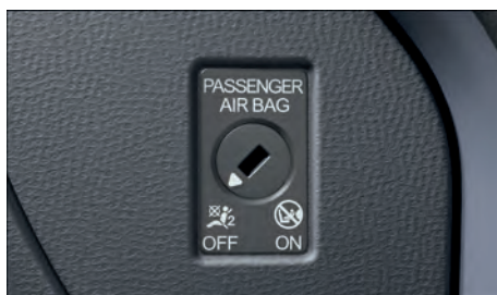
Fig. 30 No painel de instrumentos no lado do passageiro dianteiro: interruptor acionado pela chave para desligar e ligar o airbag frontal do passageiro dianteiro.
