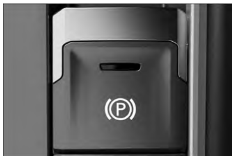
Fig. 110 No console central: botão do freio de estacionamento eletrônico.
