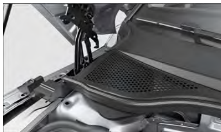
Fig. 180 Entre o compartimento do motor e o para-brisa: caixa de água (representação esquemática).
