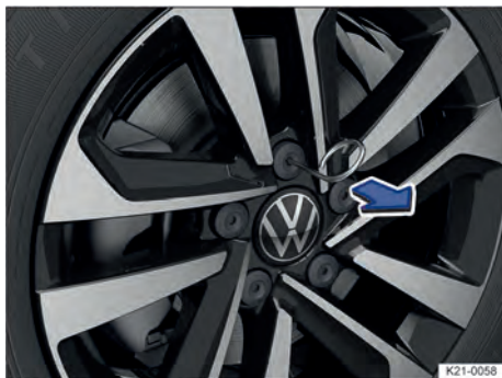
Fig. 170 Remover as capas de cobertura dos parafusos de roda.
