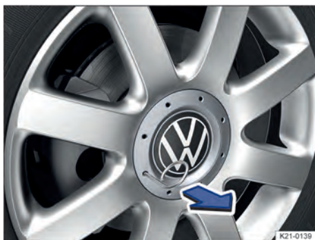
Fig. 168 Retirar a calota central.
