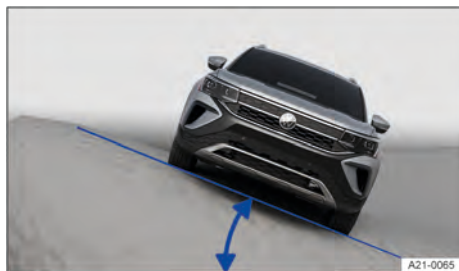
Fig. 97 Representação esquemática: ângulo de inclinação lateral.
