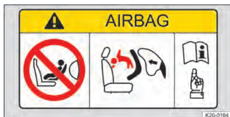
Fig. 34 Representação esquemática: etiqueta do airbag no para-sol.
