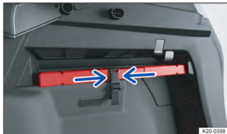
Fig. 38 No compartimento de bagagem do lado direito: suporte do triângulo de segurança.
