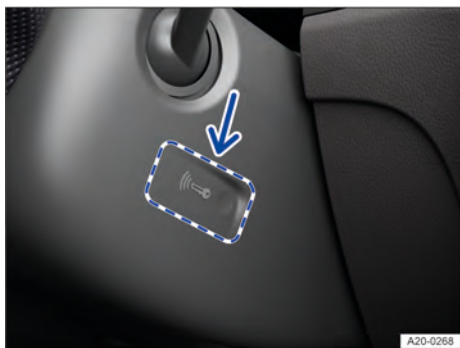
Fig. 88 À direita da coluna de direção: função de partida de emergência.
