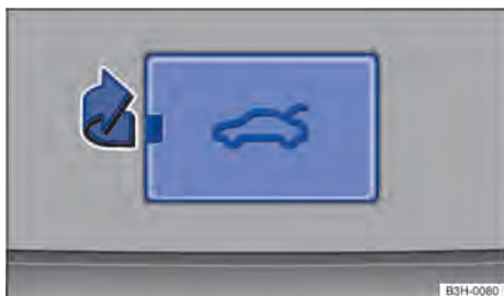
Fig. 53 Na tampa traseira: cobertura do destravamento de emergência da tampa traseira.
