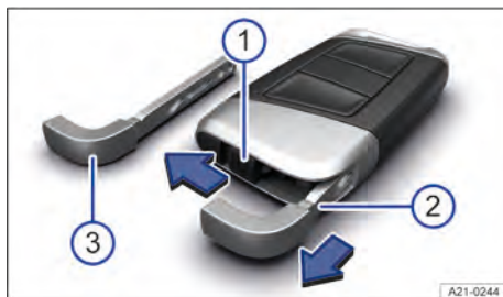
Fig. 40 Chave do veículo: destravamento da chave de emergência (representação esquemática).
