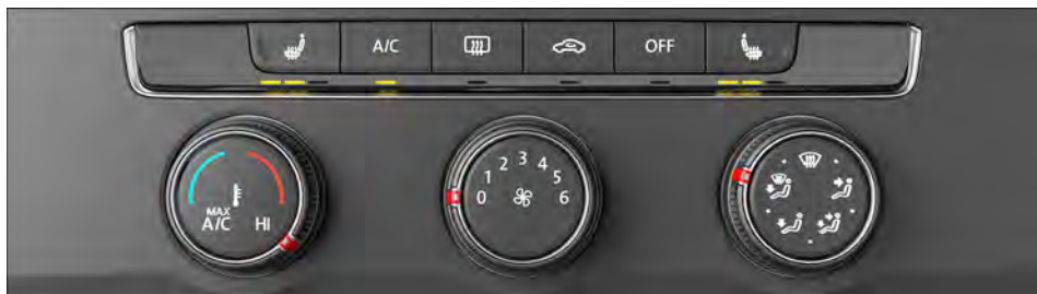
Fig. 83 Na parte superior do console central: painel de comando do ar-condicionado do ar-condicionado manual.
