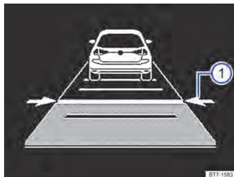
Fig. 108 No display do instrumento combinado: distância regulada ① (representação esquemática, o ACC está regulando).
