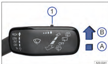
Fig. 76 À direita da coluna de direção: alavanca dos limpadores dos vidros.
