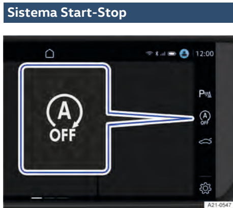
Fig. 89 No sistema Infotainment: superfície de função do sistema Start-Stop.
