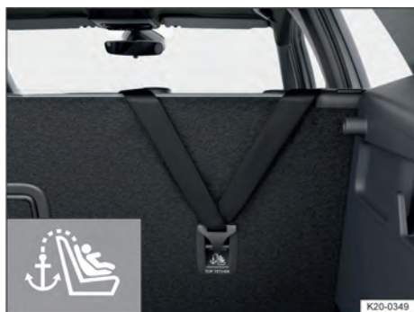
Fig. 37 No compartimento de bagagem: cinto de fixação superior pendurado.
