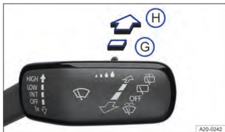
Fig. 75 À direita da coluna de direção: comandar o limpador do vidro traseiro.
