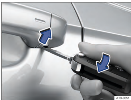
Fig. 47 Maçaneta da porta do condutor: alavancar a capa de cobertura para fora.
