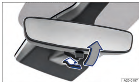
Fig. 78 No para-brisa: espelho retrovisor interno com antiofuscante manual.
