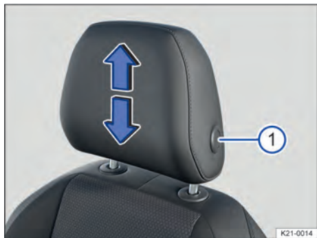
Fig. 63 Representação esquemática: ajustar o apoio para cabeça dianteiro.
