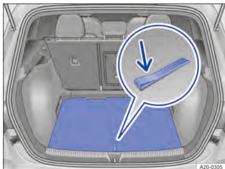
Fig. 120 No compartimento de bagagem: abrir o assoalho do compartimento de bagagem.
