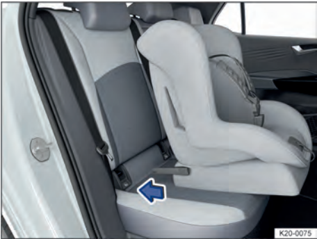
Fig. 36 Representação esquemática: instalar a cadeira de criança com braços de apoio.
