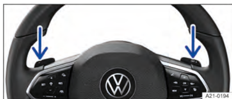
Fig. 92 Volante com seletores basculantes do Tiptronic.
