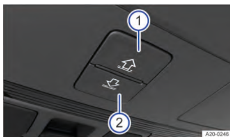
Fig. 81 No revestimento do teto: botões de comando da cortina de proteção solar.
