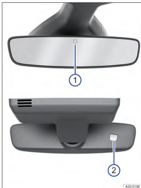
Fig. 77 No para-brisa: espelho retrovisor interno com antiofuscante automático.
