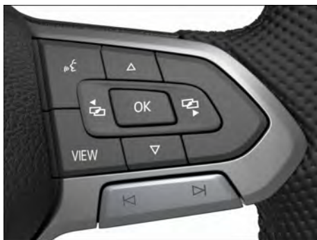
Fig. 12 Lado direito do volante multifunções: botões para comando dos menus e telas de informação do instrumento combinado digital versão Basic.
