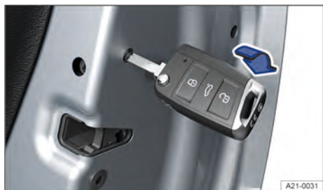
Fig. 48 Na parte dianteira de uma porta: travamento de emergência do veículo com a haste da chave ou a chave de emergência (variante 1).
