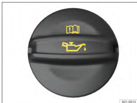
Fig. 157 No compartimento do motor: tampa da abertura para enchimento de óleo do motor (representação esquemática).
