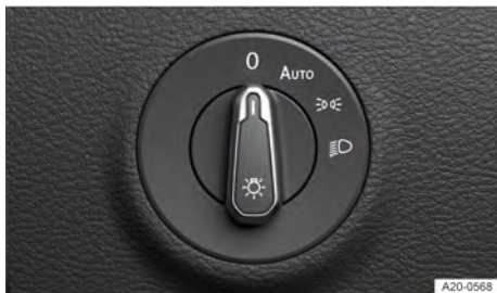
Fig. 71 Ao lado do volante: interruptor das luzes.
