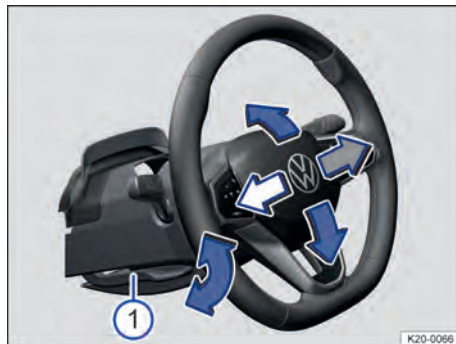
Fig. 57 Embaixo do volante no revestimento da coluna de direção: alavanca de ajuste mecânico da posição do volante (representação esquemática).
