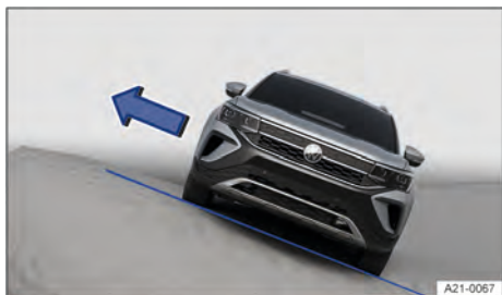
Fig. 99 Representação esquemática: desembarcar do lado do veículo voltado para cima da ladeira.
