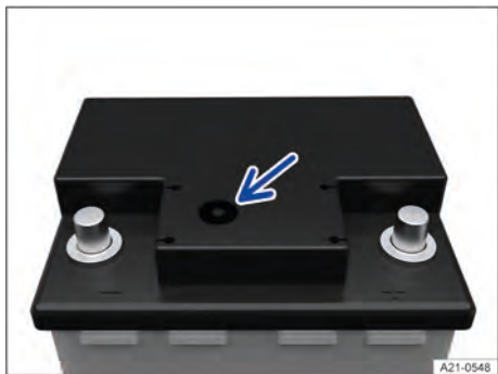
Fig. 162 Visor no lado superior da bateria do veículo 12 V (representação esquemática).
