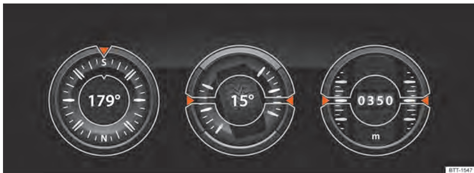
Fig. 95 Indicação no sistema Infotainment: indicação off-road.
