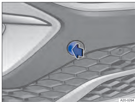
Fig. 145 No para-choque dianteiro à direita: retirar cobertura.
