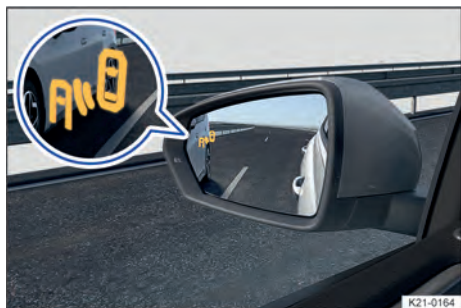
Fig. 109 Nos espelhos retrovisores externos: indicação do sensor de ponto cego.
