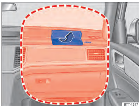
Fig. 29 Local de instalação e área de expansão do airbag frontal do passageiro dianteiro.
