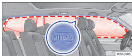
Fig. 32 No lado esquerdo do veículo: local de instalação e área de expansão do airbag para cabeça.
