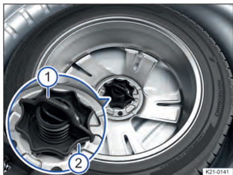
Fig. 175 No compartimento de bagagem: manípulo para fixação da roda sobressalente.
