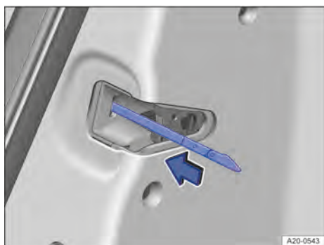
Fig. 49 Na parte dianteira de uma porta: travamento de emergência do veículo com a haste da chave ou a chave de emergência (variante 2).
