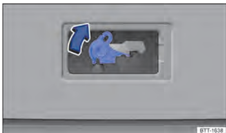
Fig. 54 No compartimento de bagagem: destravamento de emergência para a tampa traseira.
