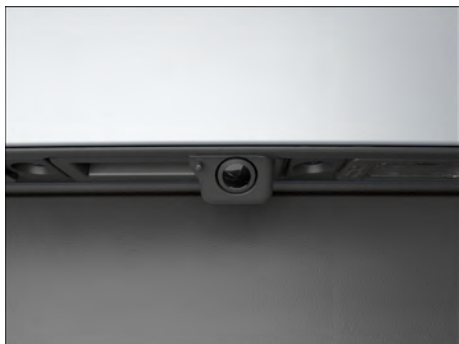
Fig. 181 Na traseira do veículo: câmera de marcha a ré no botão da alça (representação esquemática).
