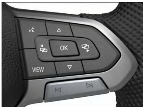
Fig. 10 Lado direito do volante multifunções: botões para comando dos menus e telas de informação do instrumento combinado digital versão Pro.
