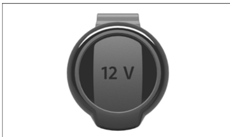
Fig. 115 No porta-objetos dianteiro ou no compartimento de bagagem do lado esquerdo: tomada 12 V articulada (representação esquemática).
