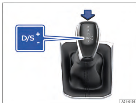
Fig. 90 Alavanca seletora da transmissão automática com botão bloqueador (seta).
