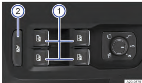
Fig. 55 Na porta do condutor: botões do acionamento dos vidros.
