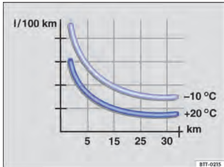
Fig. 86 Consumo de combustível em l/100 km em duas temperaturas ambiente diferentes.
