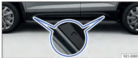
Fig. 176 Pontos de apoio do macaco.
