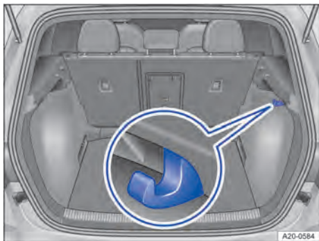
Fig. 122 No compartimento de bagagem à esquerda e à direita: ganchos para sacolas.
