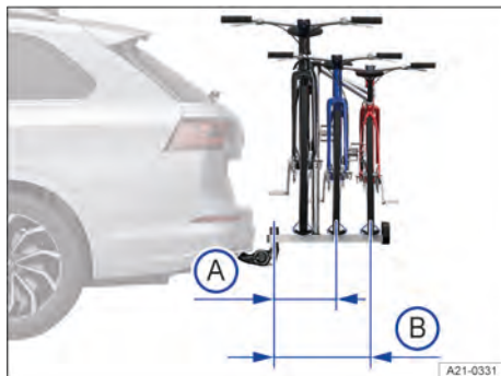
Fig. 127 Representação esquemática da largura máxima de um suporte de bicicletas para duas ou três bicicletas.
