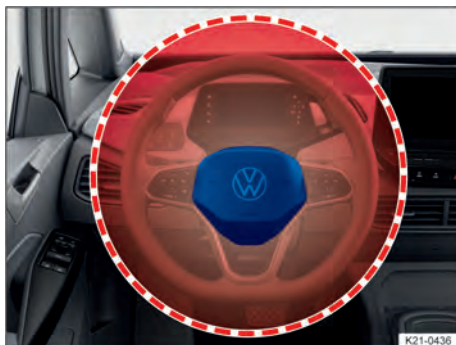
Fig. 28 Local de instalação e área de expansão do airbag frontal do condutor.
