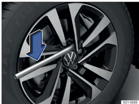
Fig. 179 Troca de roda: desaparafusar os parafusos de roda com a chave de roda.
