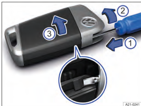
Fig. 42 Chave do veículo: abrir a tampa do compartimento da bateria.
