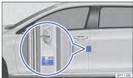
Fig. 165 Na coluna do condutor: etiqueta com as pressões dos pneus (alternativa ao lado interno da portinhola do tanque).
