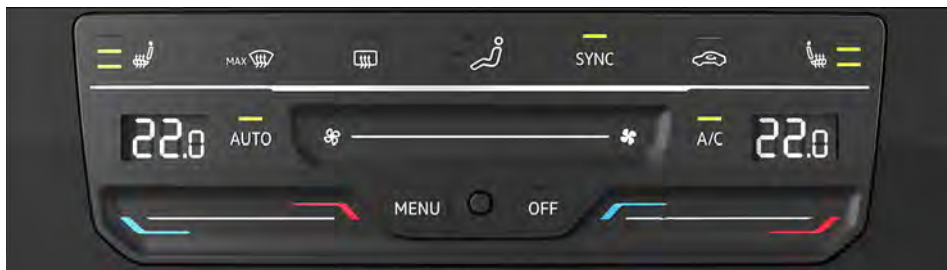
Fig. 82 Na parte superior do console central: painel de comando do ar-condicionado do Climatronic.
