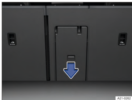
Fig. 124 Dispositivo para transporte de objetos longos no compartimento de bagagem.
