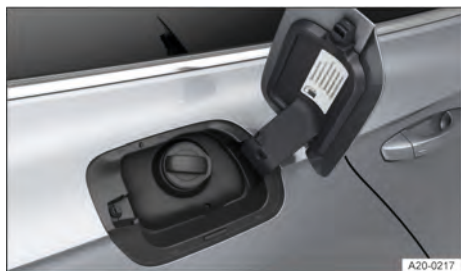
Fig. 131 Atrás da portinhola do tanque: tampa do tanque (representação esquemática).
