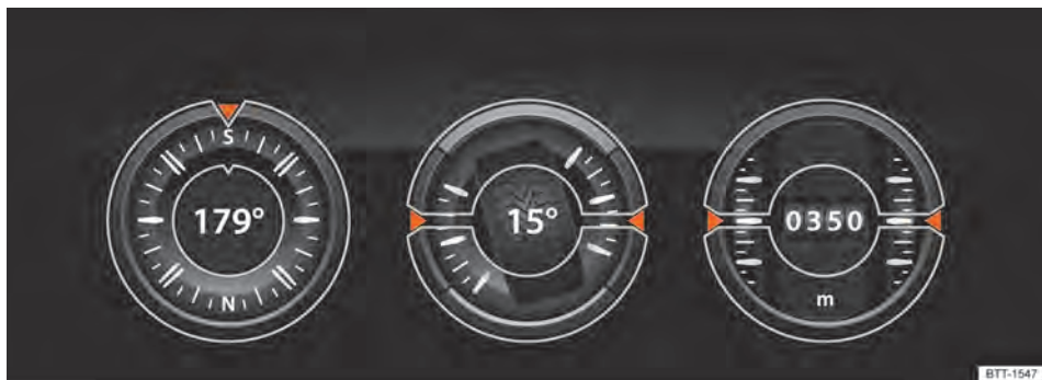
Fig. 89 Indicação no sistema Infotainment: indicação off-road.
