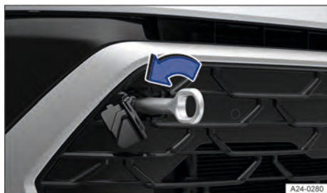
Fig. 156 No para-choque dianteiro à direita: rosquear a argola de reboque.
