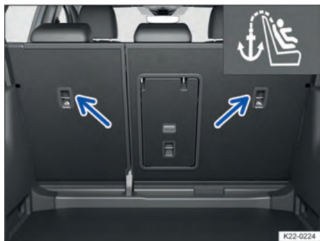
Fig. 34 No lado de trás do banco traseiro: pontos de ancoragem Top Tether do cinto de fixação superior (representação esquemática).
