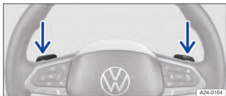
Fig. 86 Atrás do volante: seletores basculantes para o Tiptronic (representação esquemática).
