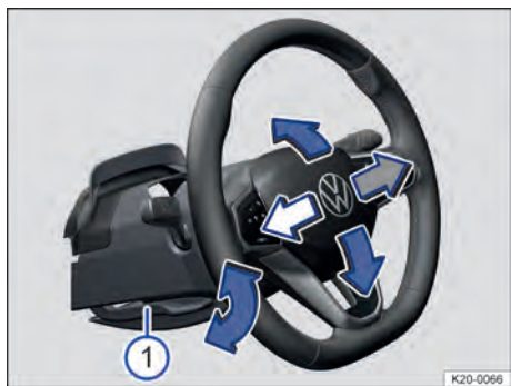
Fig. 53 Embaixo do volante no revestimento da coluna de direção: alavanca de ajuste mecânico da posição do volante (representação esquemática).
