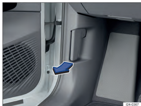
Fig. 159 Na área para os pés no lado do condutor: alavanca de destravamento da tampa dianteira (representação esquemática).
