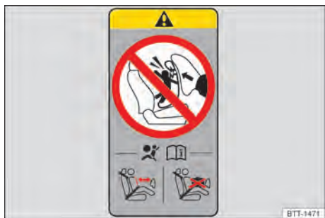
Fig. 32 Na coluna B: etiqueta do airbag (representação esquemática).
