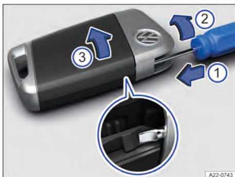
Fig. 40 Chave do veículo: abrir a tampa do compartimento da bateria.
