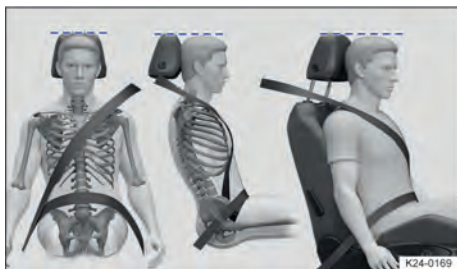
Fig. 22 Posição correta do cadarço do cinto de segurança e ajuste correto do apoio para cabeça (representação esquemática).
