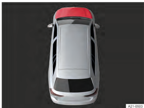
Fig. 163 No display do instrumento combinado: tampa dianteira aberta ou não fechada corretamente (representação esquemática).
