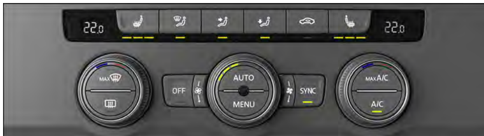
Fig. 79 Na parte superior do console central: painel de comando do ar-condicionado do Climatronic (variante 2).
