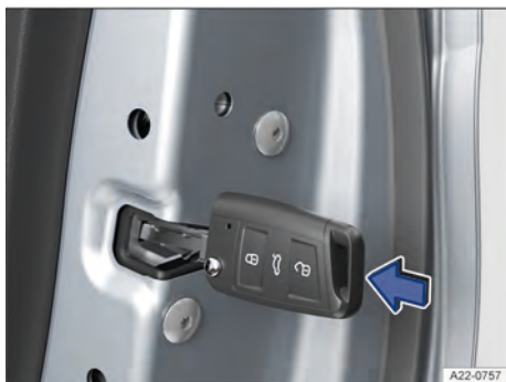
Fig. 47 Na parte dianteira da porta traseira: travamento de emergência do veículo com a haste da chave (variante 2).
