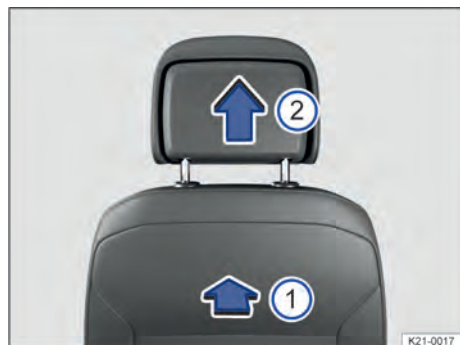
Fig. 61 Desinstalar o apoio para cabeça dianteiro (representação esquemática).
