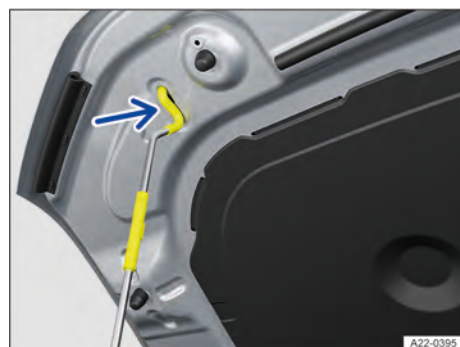
Fig. 162 Na tampa dianteira: alojamento para a haste de sustentação da tampa (representação esquemática).
