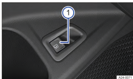
Fig. 138 Na porta do condutor: botão do destravamento da portinhola do tanque (representação esquemática).
