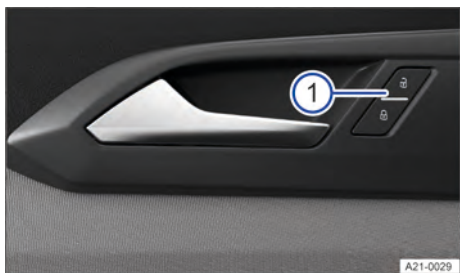
Fig. 44 Na porta do condutor: botão do travamento central (representação esquemática).
