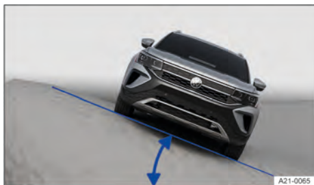
Fig. 91 Representação esquemática: ângulo de inclinação lateral.
