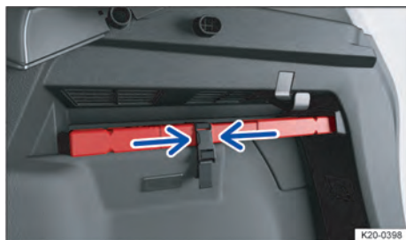
Fig. 36 No compartimento de bagagem do lado direito: suporte do triângulo de segurança.
