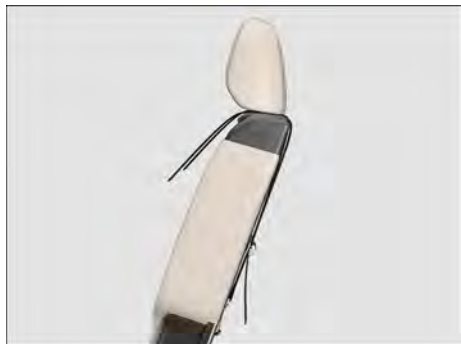
Fig. 35 No lado de trás dos bancos traseiros externos: cinto de fixação superior preso.
