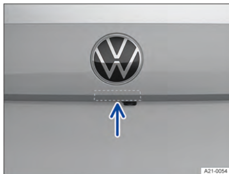
Fig. 49 Na tampa traseira: botão para abrir a tampa traseira (representação esquemática).
