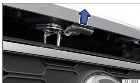
Fig. 160 Acima da grade do radiador: alavanca de comando da tampa dianteira (representação esquemática).
