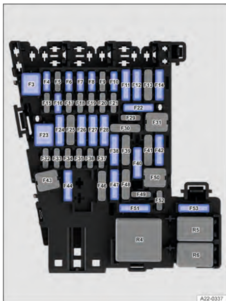
Fig. 149 No painel de instrumentos: disposição dos fusíveis.
