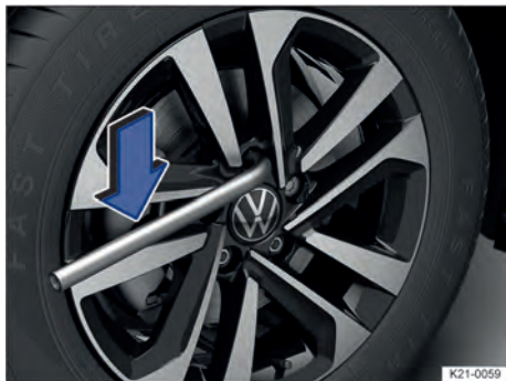
Fig. 185 Remover os parafusos de roda com a chave da roda.
