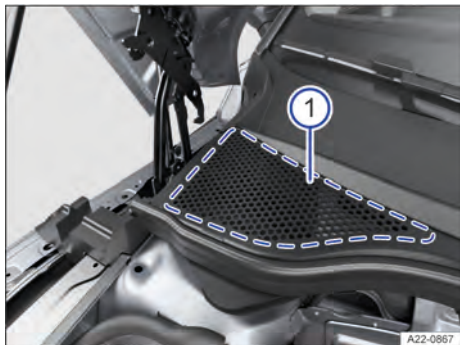
Fig. 188 Entre o compartimento dianteiro e o para-brisa: caixa coletora de água (representação esquemática).
