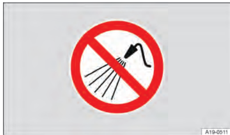
Fig. 187 No compartimento dianteiro: não usar lavador de alta pressão.
