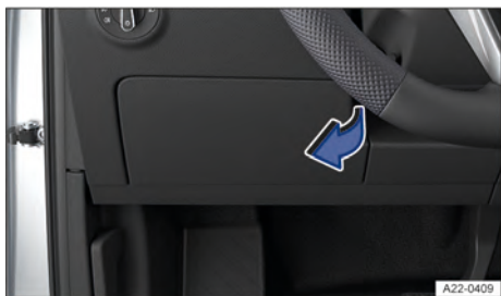
Fig. 148 No lado do condutor no painel de instrumentos: cobertura da caixa de fusíveis (representação esquemática).
