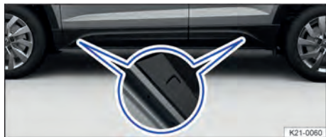
Fig. 182 Na longarina lateral: marcas dos pontos de apoio e do macaco.
