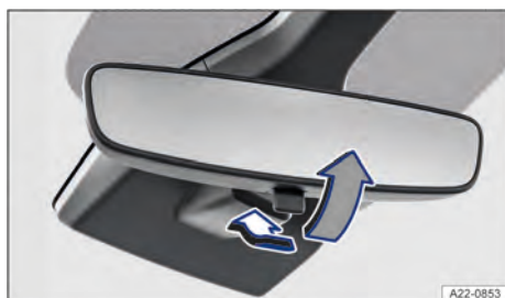
Fig. 74 No para-brisa: espelho retrovisor interno com antiofuscante manual.
