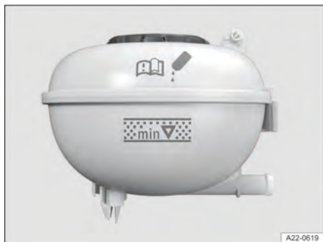
Fig. 170 No compartimento dianteiro: marcas no reservatório de expansão do líquido de arrefecimento (representação esquemática).
