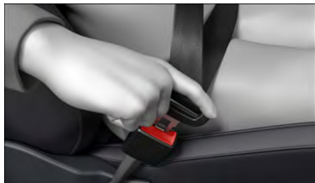
Fig. 20 Introduzir a lingueta do cinto de segurança no fecho do cinto de segurança (representação esquemática).
