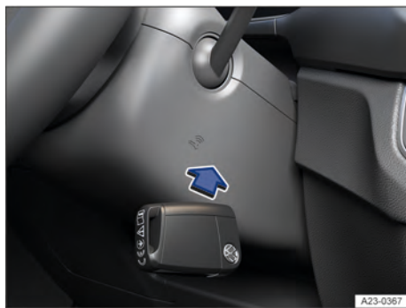
Fig. 82 À direita na coluna de direção: função de partida de emergência em veículos com sistema de travamento e de partida Keyless Access sem chave (representação esquemática).
