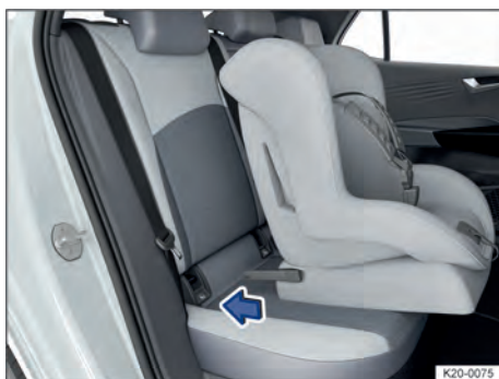
Fig. 33 Instalar a cadeira de criança com braços de apoio (representação esquemática).
