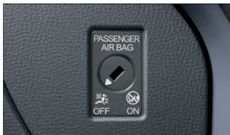
Fig. 26 No painel de instrumentos no lado do passageiro dianteiro: interruptor acionado pela chave para desligar e ligar o airbag frontal do passageiro dianteiro.
