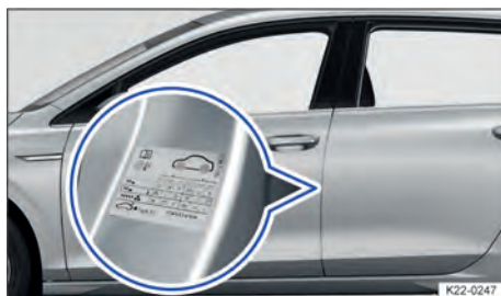
Fig. 173 Na coluna do condutor: etiqueta com as pressões dos pneus (alternativa ao lado interno da portinhola do tanque).
