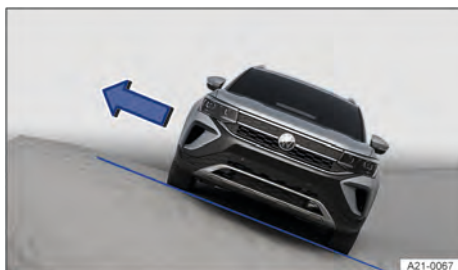
Fig. 93 Representação esquemática: desembarcar do lado do veículo voltado para cima da encosta.
