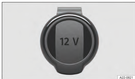
Fig. 118 No porta-objetos no console central dianteiro: tomada 12 V articulada (representação esquemática).
