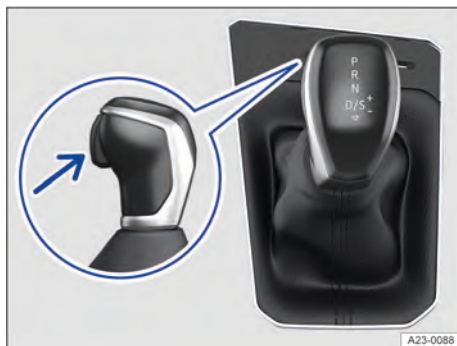
Fig. 84 No console central: alavanca seletora da transmissão automática (representação esquemática).
