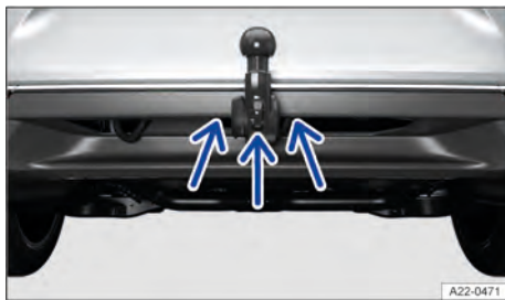
Fig. 128 No dispositivo de reboque: olhal para fixação do cabo de segurança ou de ruptura (representação esquemática).
