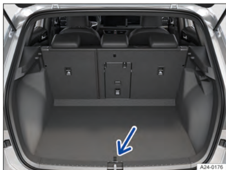
Fig. 123 No compartimento de bagagem: abrir o assoalho do compartimento de bagagem.
