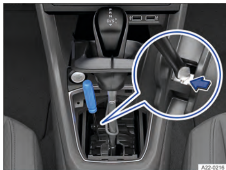
Fig. 87 No console central: destravar emergencialmente o bloqueio da alavanca seletora (variante 1).
