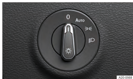
Fig. 67 Ao lado do volante: interruptor das luzes.
