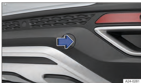
Fig. 157 No para-choque traseiro à direita: remover cobertura.
