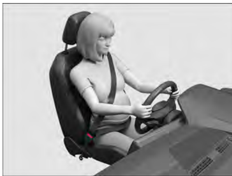
Fig. 23 Posição correta do cadarço do cinto de segurança para mulheres grávidas (representação esquemática).
