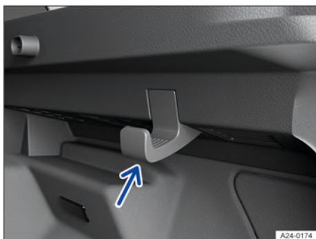
Fig. 125 No compartimento de bagagem à esquerda e à direita: ganchos para sacolas.
