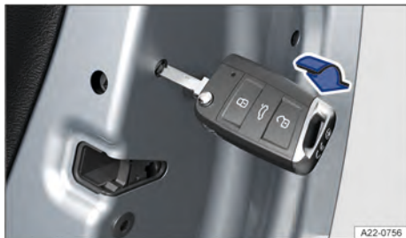
Fig. 46 Na parte dianteira da porta traseira: travamento de emergência do veículo com a haste da chave (variante 1).
