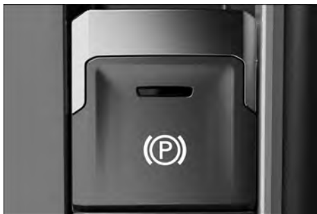
Fig. 107 No console central: botão do freio de estacionamento eletrônico.
