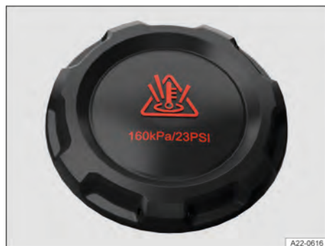
Fig. 169 No compartimento dianteiro: tampa do reservatório de expansão do líquido de arrefecimento (representação esquemática).
