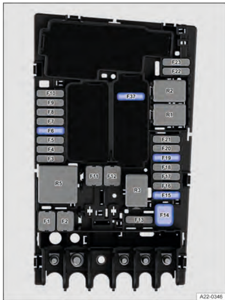
Fig. 147 No compartimento dianteiro: slots para fusíveis.
