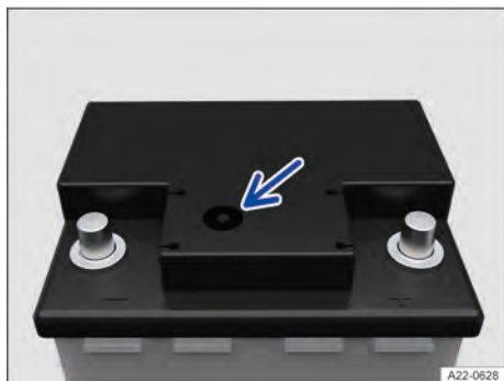
Fig. 172 No lado superior da bateria do veículo 12 V: visor de inspeção da bateria (representação esquemática).
