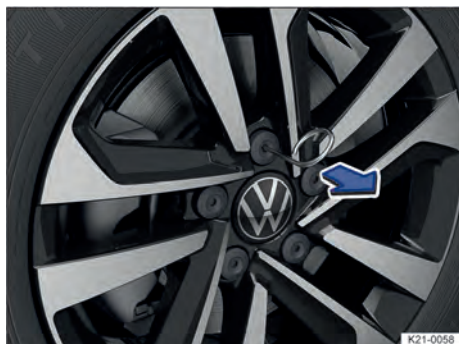
Fig. 180 Remover as capas de cobertura dos parafusos de roda.
