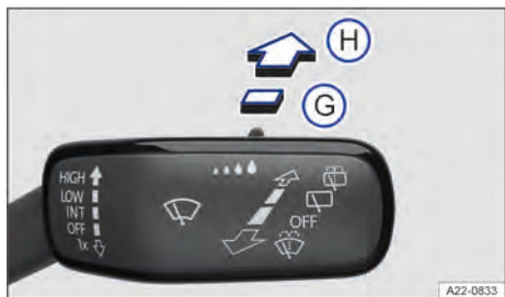
Fig. 71 À direita da coluna de direção: comandar o limpador do vidro traseiro.
