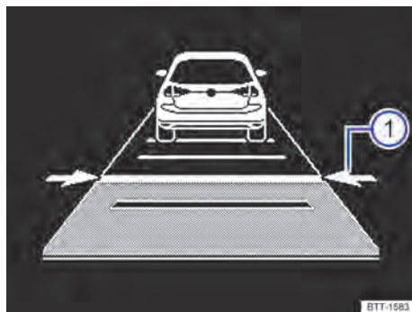
Fig. 104 No display do instrumento combinado: distância ajustada no caso de regulação (representação esquemática).
