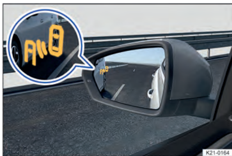
Fig. 106 Nos vidros dos espelhos retrovisores externos: indicador do sensor de “ponto cego”.
