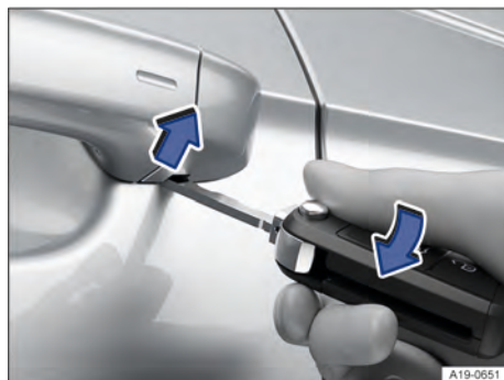
Fig. 45 Maçaneta da porta do condutor: alavancar a capa de cobertura para fora.
