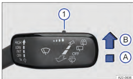
Fig. 72 À direita da coluna de direção: alavanca dos limpadores dos vidros.
