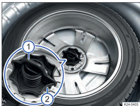
Fig. 179 Sob o assoalho do compartimento de bagagem: manipulador para fixação da roda sobressalente ou da roda de emergência.
