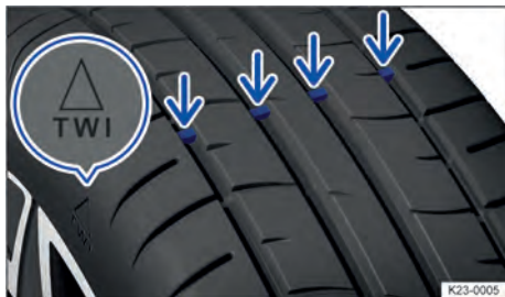
Fig. 178 Nos sulcos do perfil: indicador de desgaste.
