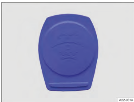
Fig. 164 No compartimento dianteiro: tampa do reservatório de água dos lavadores dos vidros (representação esquemática).
