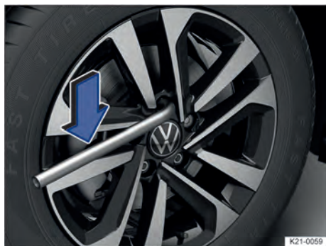
Fig. 181 Soltar os parafusos de roda.
