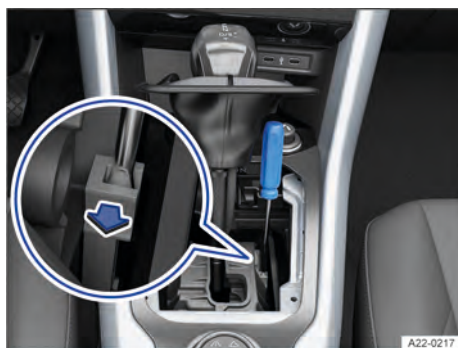
Fig. 88 No console central: destravar emergencialmente o bloqueio da alavanca seletora (variante 2).
