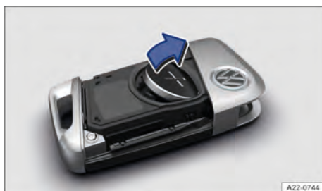
Fig. 41 Chave do veículo: trocar a pilha-botão.
