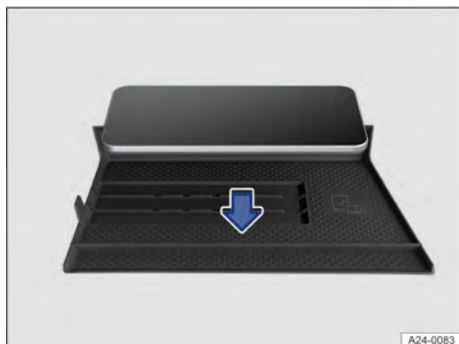
Fig. 119 No console central: tapete de revestimento da função de carregamento sem fio (representação esquemática).
