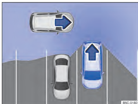
Fig. 114 Área monitorada ao redor do veículo que irá sair da vaga de estacionamento (representação esquemática).
