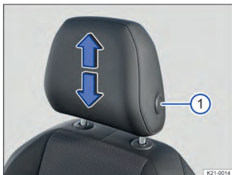
Fig. 59 Ajustar o apoio para cabeça dianteiro (representação esquemática).
