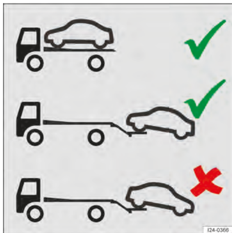
Fig. 154 Remoção com um veículo rebocador.
