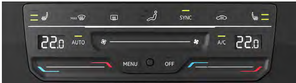
Fig. 78 Na parte superior do console central: painel de comando do ar-condicionado do Climatronic (variante 1).
