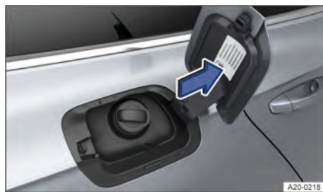
Fig. 132 No lado interno da portinhola do tanque: placa de indicação de combustível (representação esquemática).
