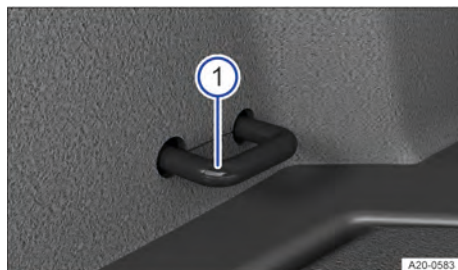
Fig. 124 No compartimento de bagagem: olhal de amarração (representação esquemática).
