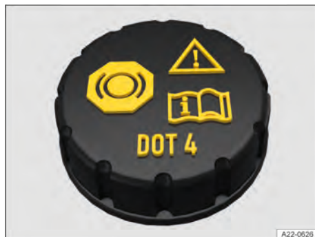
Fig. 171 No compartimento dianteiro: tampa do reservatório do fluido de freio.
