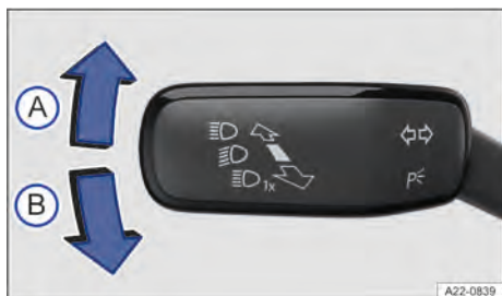
Fig. 66 À esquerda na coluna de direção: alavanca dos indicadores de direção e do farol alto.
