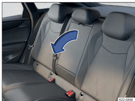
Fig. 116 No encosto do banco do central: descansa-braço central traseiro rebatível para fora (representação esquemática).
