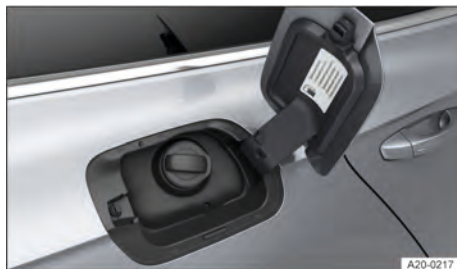
Fig. 137 Atrás da portinhola do tanque: tampa do tanque (representação esquemática).
