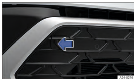
Fig. 155 No para-choque dianteiro à direita: retirar cobertura.
