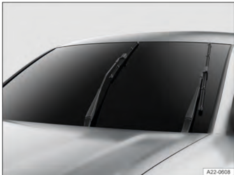
Fig. 142 Limpadores dos vidros na posição de serviço (representação esquemática).
