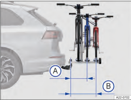
Fig. 131 Representação esquemática da largura máxima de um suporte de bicicletas para duas ou três bicicletas.
