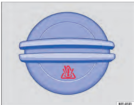
Fig. 133 No compartimento do motor: tampa do reservatório de expansão do líquido de arrefecimento do motor.
