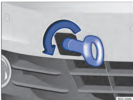
Fig. 188 No para-choque dianteiro à direita: rosquear a argola de reboque.
