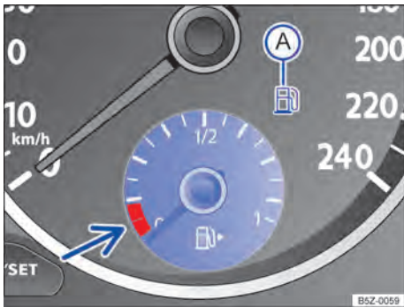
Fig. 125 No instrumento combinado: indicador do nível de combustível.
