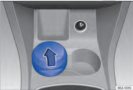
Fig. 90 No console central dianteiro: abrir o cinzeiro.
