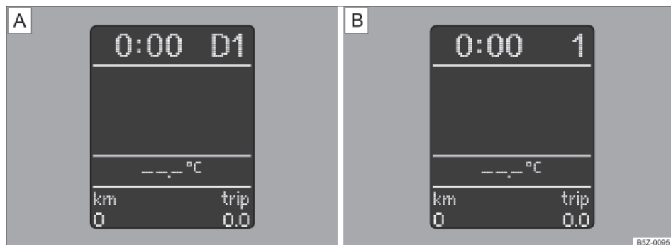
Fig. 102 (A) Posições da alavanca seletora no display: indicação da alavanca no modo de condução automatizada (Modo normal), com a 1ª marcha engatada. (B) Posições da alavanca seletora no display: modo de condução manual, com a 1ª marcha selecionada.
