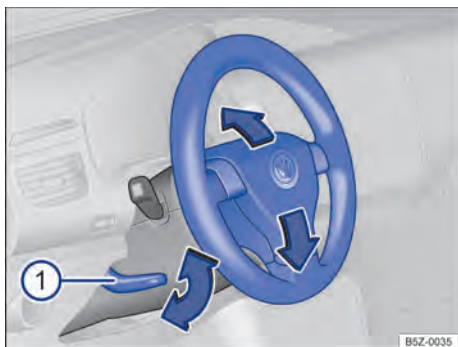
Fig. 42 Ajustar a posição do volante mecanicamente.
