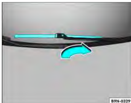
Fig. 143 Levantamento do braço do limpador do para-brisa
