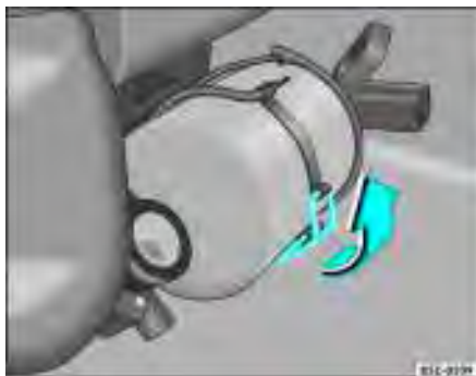
Fig. 31 Extintor de incêndio no banco do passageiro dianteiro
