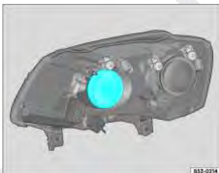
Fig. 181 Localização da lâmpada do farol alto / lanterna dianteira (luz de posição)
