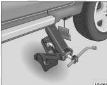
Fig. 166 Macaco colocado na parte traseira, lado esquerdo
