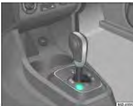
Fig. 125 Detalhe do console central: tecla para acionamento do modo esportivo
