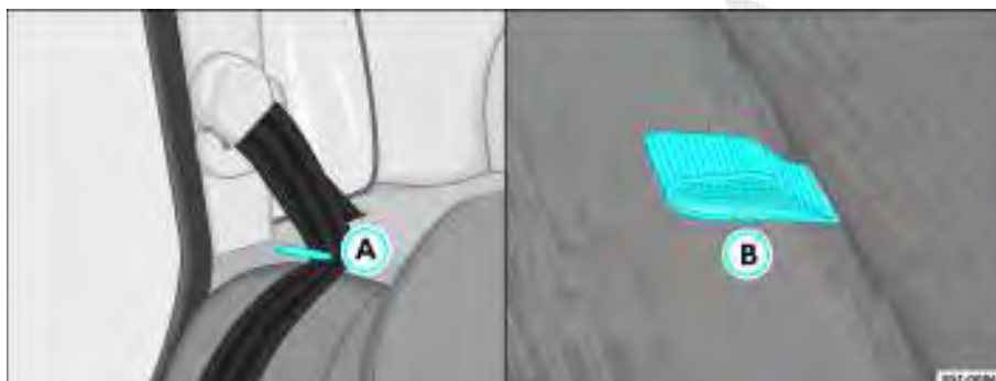
Fig. 89 Posicionador do cinto para rebatimento do banco / alça para desbloqueio do encosto
