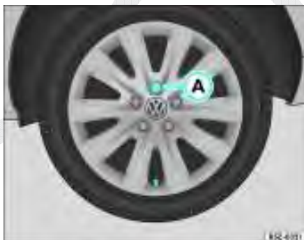
Fig. 167 Sequência de remoção dos parafusos da roda
