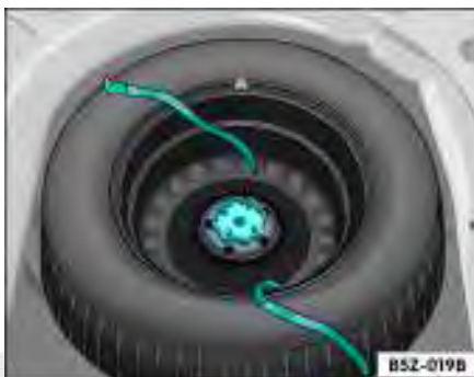
Fig. 158 Manípulo de fixação da roda de emergência
