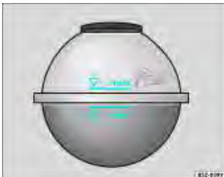
Fig. 140 Reservatório de expansão do líquido de arrefecimento
