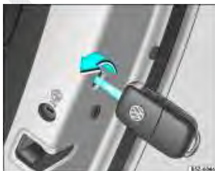
Fig. 169 Acionamento da trava de emergência com o auxílio da chave do veículo
