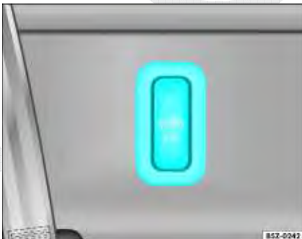
Fig. 61 Botão para desativação do sistema de monitoramento do compartimento interno
