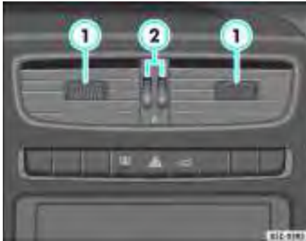
Fig. 109 Difusores de ar: distribuição
