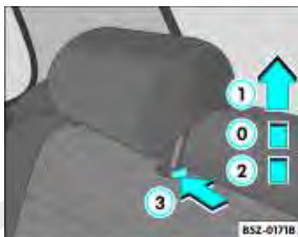
Fig. 84 Regular ou remover os apoios para cabeça traseiros
