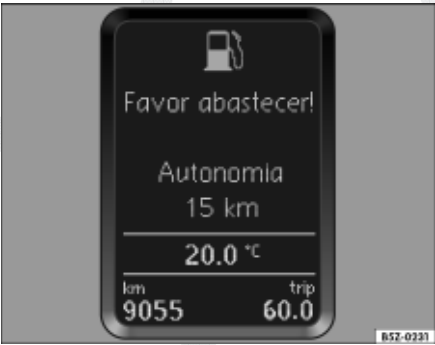
Fig. 50 Luz indicadora do nível de combustível e texto de alerta no display
