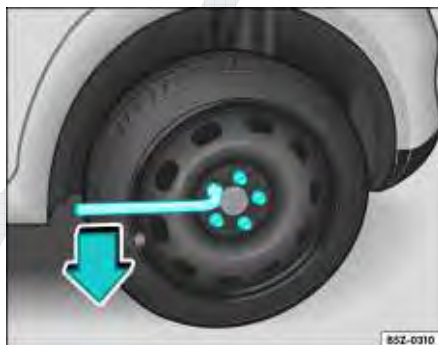
Fig. 163 Desaperto dos parafusos da roda
