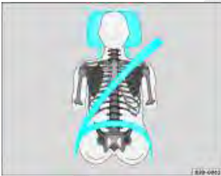
Fig. 15 Posições corretas do cinto de segurança e do apoio para cabeça, vistas de frente
