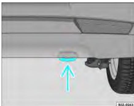
Fig. 198 Argola de rebocagem traseira - SpaceFox
