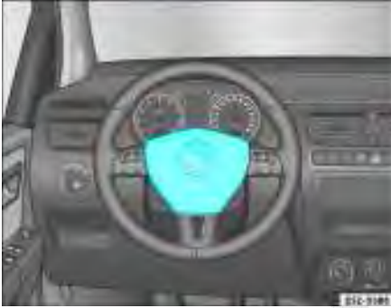
Fig. 21 Localização do airbag do condutor: no volante
