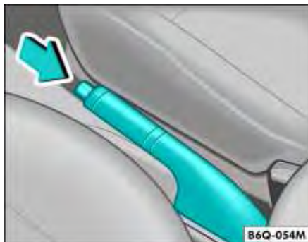
Fig. 130 Alavanca do freio de estacionamento localizada entre os bancos dianteiros
