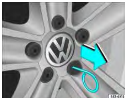
Fig. 162 Retirar os protetores dos parafusos
