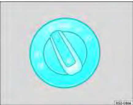
Fig. 67 Interruptor das luzes no painel de instrumentos, ao lado do volante
