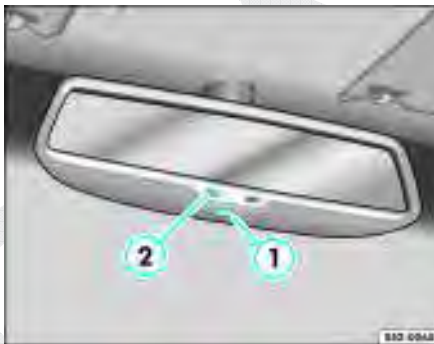
Fig. 79 Detalhe do interruptor do espelho com antiofuscante automático
