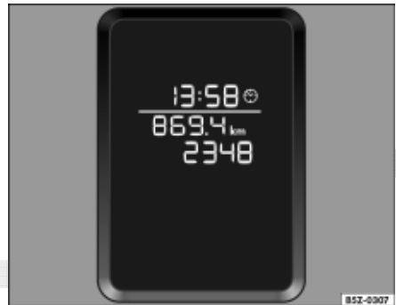
Fig. 40 Relógio no display do instrumento combinado: veículos sem computador de bordo ou sem sistema de informações Volkswagen
