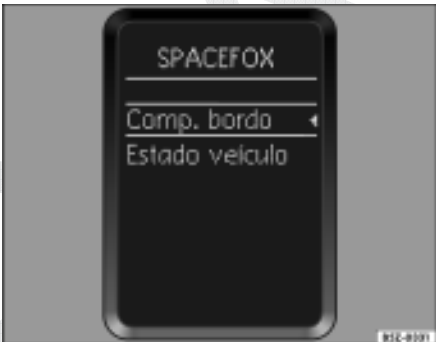
Fig. 44 Display do menu principal - veículos com computador de bordo e sem sistema de informações Volkswagen
