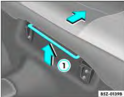
Fig. 86 Alavanca para regulagem longitudinal
