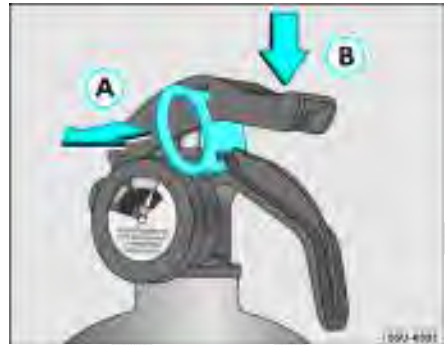
Fig. 33 Sequência de utilização do extintor de incêndio
