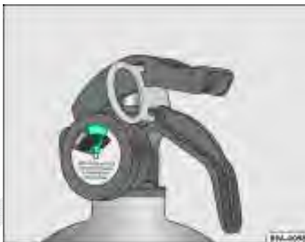
Fig. 154 Manômetro: indicador de carga
