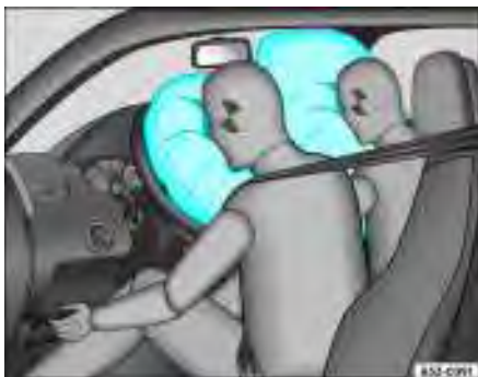
Fig. 24 Ilustração do funcionamento: airbags insuflados
