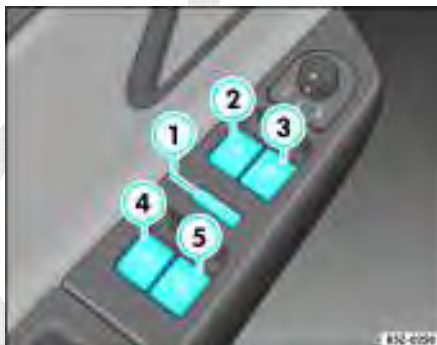
Fig. 65 Detalhe do descanso-brança da porta do condutor: teclas de comando dos vidros e interruptor de segurança dos vidros traseiros
