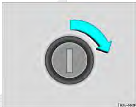
Fig. 62 Tampa do compartimento de bagagem: abertura
