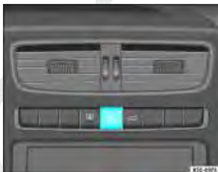
Fig. 68 Detalhe no painel: interruptor da luz de advertência
