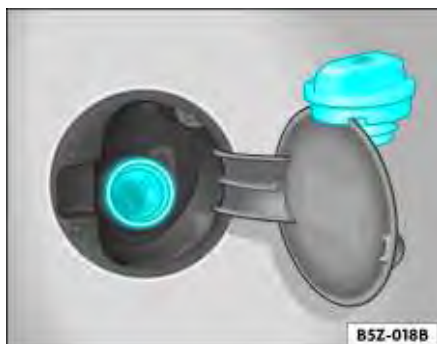
Fig. 134 Bocal e tampa do reservatório de combustível
