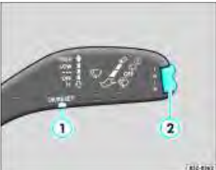
Fig. 43 Alavanca do limpador do para-brisa: tecla ① para confirmar itens do menu e tecla basculante ② para mudar de menu
