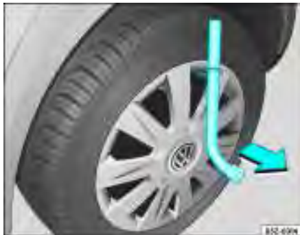
Fig. 159 Remover a supercalota
