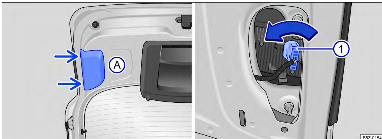
Fig. 144 Na tampa traseira: remover a cobertura e lâmpada da lanterna direita e/ou da lanterna esquerda - para veículos sem lanterna de neblina.
