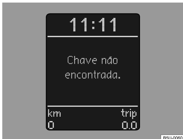
Fig. 96 No instrumento combinado: display com indicação do imobilizador ativado - veículos com Sistema de Informações Volkswagen.
