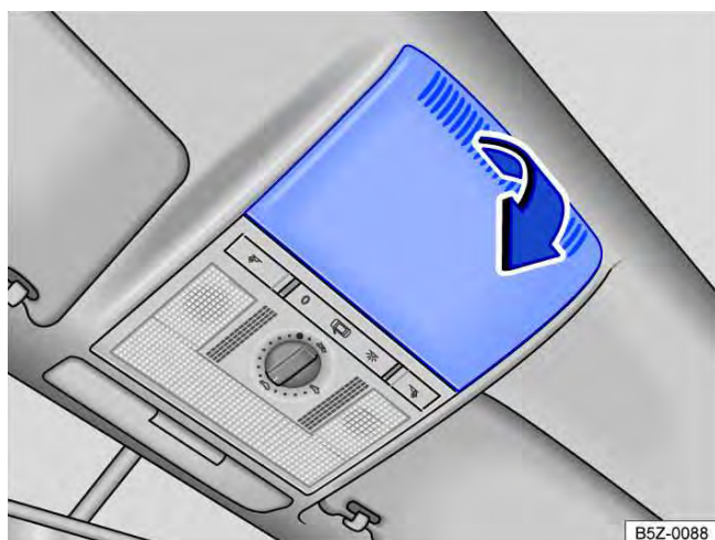
Fig. 63 No revestimento do teto: remover a cobertura.
