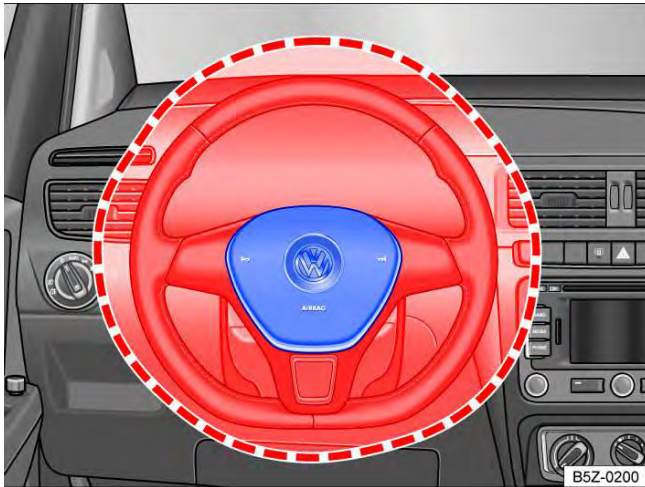
Fig. 15 Local de instalação e área de expansão do airbag frontal do condutor.
