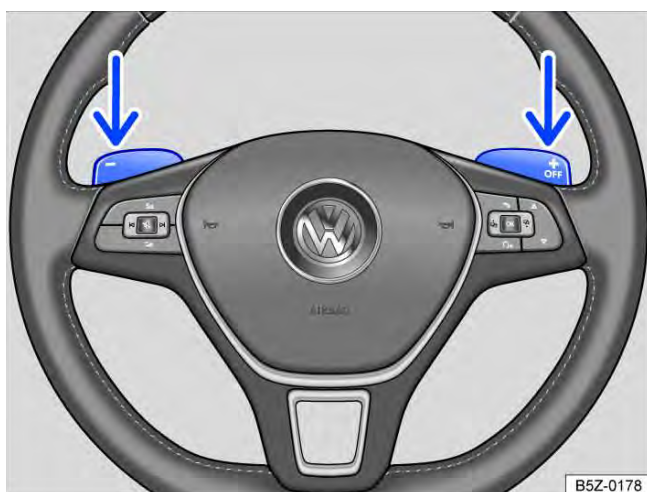
Fig. 102 Volante com dois seletores para troca de marcha no modo manual.
