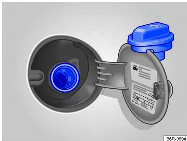
Fig. 130 Portinhola do tanque de combustível aberta com a tampa do tanque de combustível pendurada.
