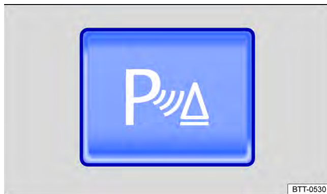
Fig. 109 Na parte superior do console central: botão para ligar e desligar o controle de distância de estacionamento (Park Pilot).
