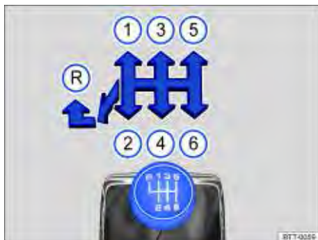
Fig. 99 Esquema de troca de marchas da transmissão manual de 6 marchas.
