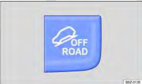
Fig. 113 No console central: botão para ligar e desligar o modo off-road manualmente.
