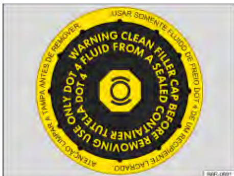
Fig. 111 No compartimento do motor: tampa do reservatório de fluido de freio.
