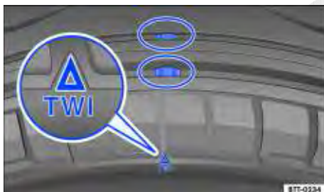
Fig. 142 Perfil do pneu: indicadores de desgaste.
