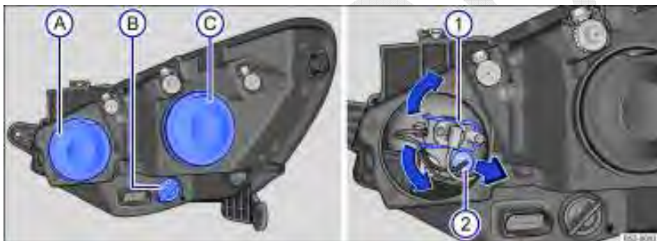
Fig. 174 No compartimento do motor: vista traseira do farol dianteiro direito com cobertura de borracha (esquerda): (A) farol alto e luz de posição, (B) indicadores de direção e (C) farol baixo. Vista traseira do farol dianteiro direito sem cobertura de borracha (direita): (1) farol alto, (2) luz de posição.
