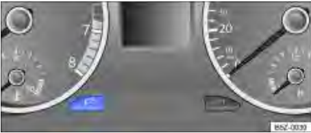
Fig. 62 No instrumento combinado: tecla de regulação da iluminação dos instrumentos e dos interruptores.
