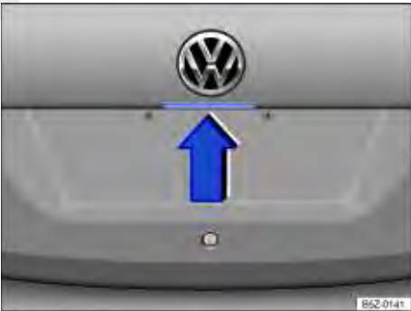
Fig. 31 No rebaixo acima da placa de licença: botão de abertura da tampa do compartimento de bagagem.
