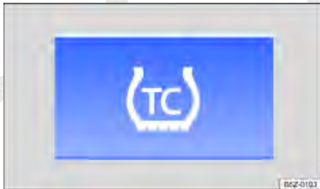
Fig. 110 No console central: botão para desligar e ligar TC (controle de tração) manualmente.
