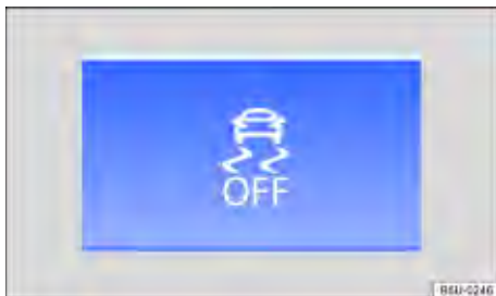
Fig. 109 No console central: botão para desligar e ligar ASR manualmente.
