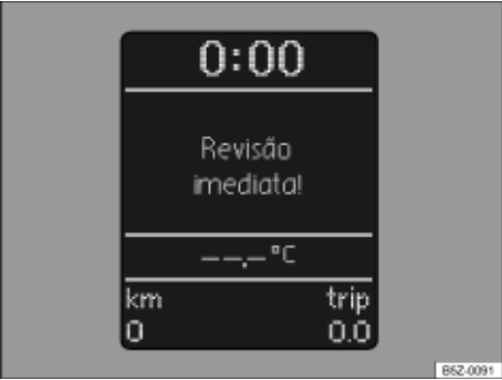
Fig. 10 Display do instrumento combinado: indicador do intervalo de serviço.
