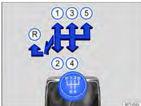
Fig. 98 Esquema de troca de marchas da transmissão manual de 5 marchas.
