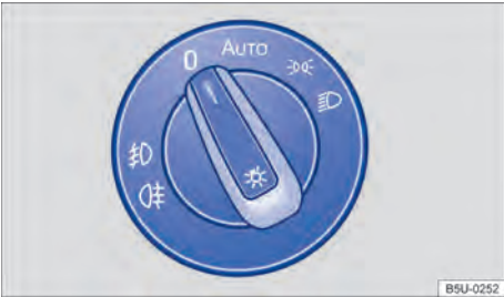
Fig. 61 No painel: interruptor das luzes.
