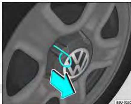
Fig. 161 Retirar a calota central com o gancho metálico
