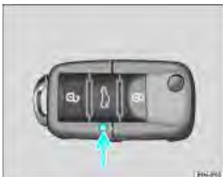
Fig. 59 Luz piloto da bateria na chave com comando remoto
