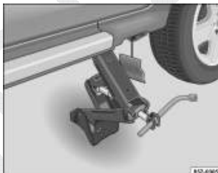
Fig. 166 Macaco colocado na parte traseira, lado esquerdo
