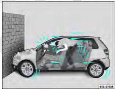
Fig. 8 Um veículo no qual os passageiros não colocaram o cinto de segurança, colidindo em uma parede
