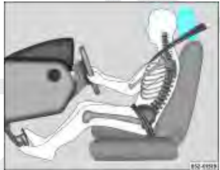
Fig. 82 Vista lateral: apoio para cabeça corretamente ajustado e o cadoarço do cinto corretamente colocado
