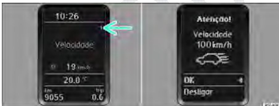
Fig. 47 Display do instrumento combinado: computador de bordo e alerta de velocidade
