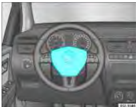
Fig. 21 Localização do airbag do condutor: no volante
