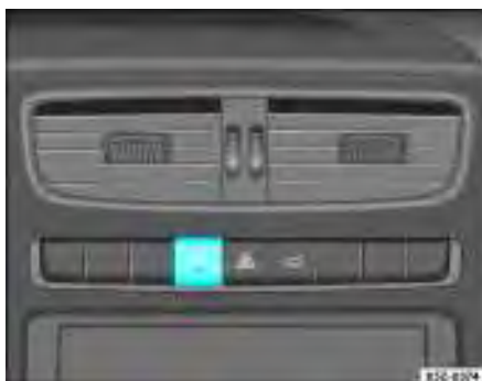
Fig. 69 Detalhe no painel de instrumentos: interruptor do desembaçador traseiro
