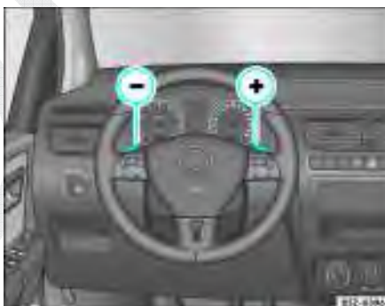
Fig. 127 Volante multifunções com seletores basculantes para a troca de marchas
