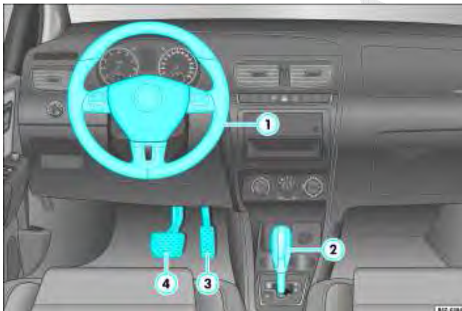
Fig. 121 Volante multifunções ①, alavanca seletora de marchas ②, acelerador ③ e pedal do freio ④
