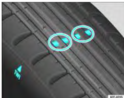
Fig. 151 Representação do perfil do pneu: indicadores de desgaste
