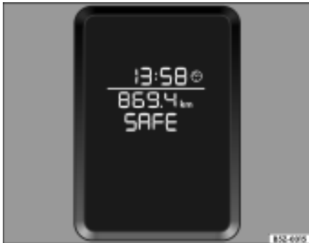
Fig. 116 Texto de advertência no display: veículos sem computador de bordo ou sem sistema de informações Volkswagen
