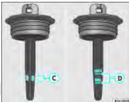
Fig. 148 Marcações para controle do nível do fluido da direção hidráulica
