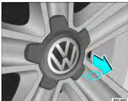
Fig. 160 Retirar a calota central com o gancho metálico
