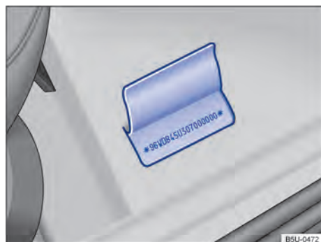
Fig. 175 Em frente ao banco do passageiro: número de identificação do veículo (número do chassi) no assoalho, em frente ao banco do passageiro dianteiro.
