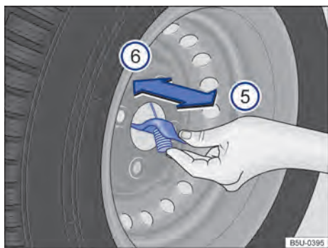
Fig. 165 Na roda de emergência: remover o cabo da roda de emergência.
