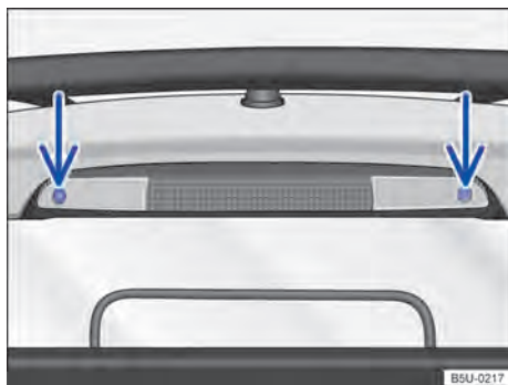
Fig. 141 No compartimento de carga: remover a lanterna de freio elevada.
