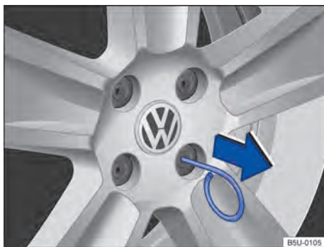
Fig. 168 Retirar as capas de cobertura dos parafusos da roda.
