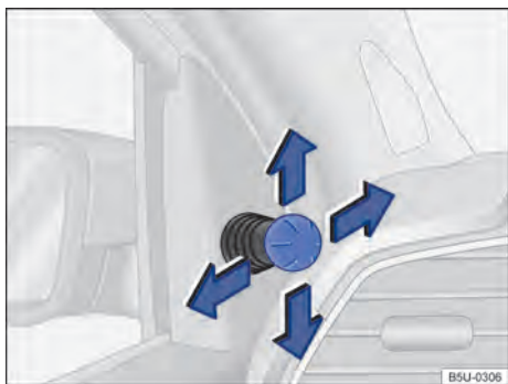
Fig. 71 Nas portas dianteiras: interruptor de ajuste dos espelhos retrovisores externos mecânicos.
