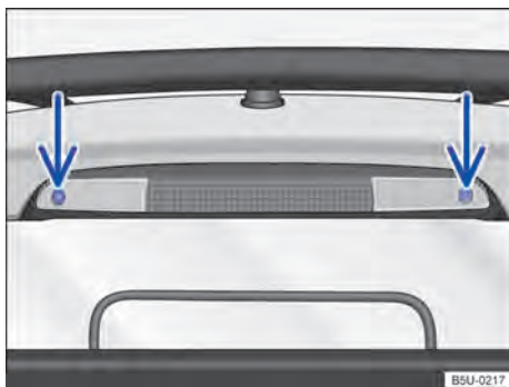
Fig. 141 No compartimento de carga: remover a lanterna de freio elevada.
