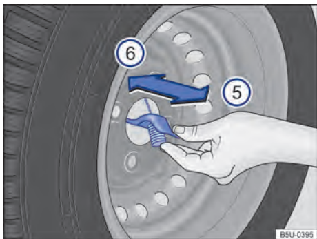
Fig. 166 Na roda de emergência: remover o cabo da roda de emergência.
