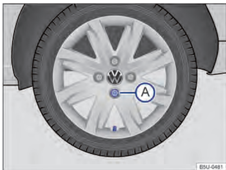
Fig. 169 Retirar a supercalota.
