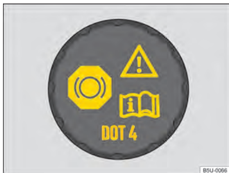
Fig. 158 No compartimento do motor: tampa do reservatório de fluido de freio.
