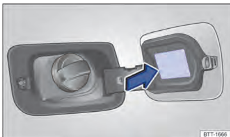
Fig. 163 Na parte interna da portinhola do tanque de combustível: etiqueta com a pressão dos pneus.
