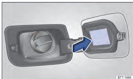
Fig. 198 Na parte interna da portinhola do tanque de combustível: etiqueta com a pressão dos pneus.
