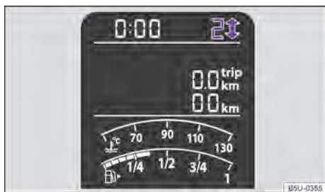
Fig. 79 No instrumento combinado: indicador de troca de marcha (variante 1).
