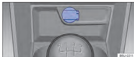
Fig. 104 No console central dianteiro: tomada 12 V.
