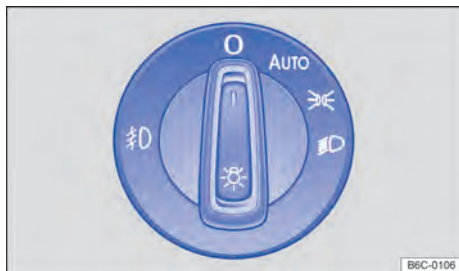
Fig. 62 Ao lado do volante: interruptor de luzes.
