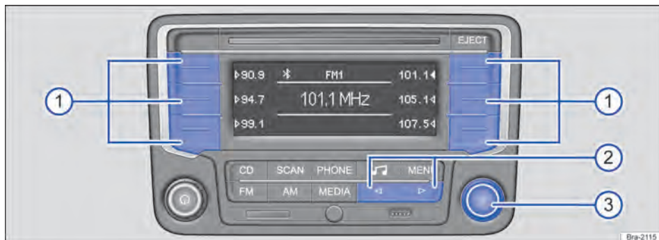
Fig. 139 Troca de estação por meio dos botões de função ou dos botões do aparelho.
