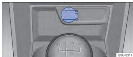
Fig. 106 No console central dianteiro: tomada 12 V.
