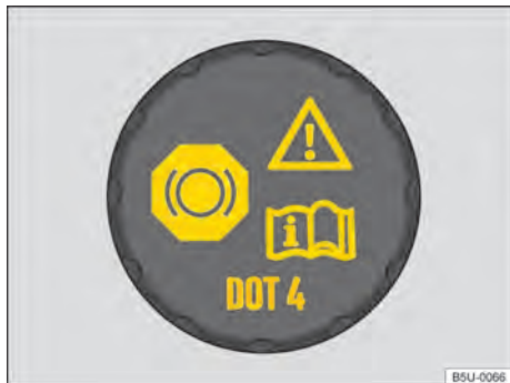
Fig. 193 No compartimento do motor: tampa do reservatório de fluido de freio.
