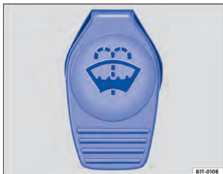
Fig. 188 No compartimento do motor: tampa do reservatório de água dos lavadores do para-brisa.
