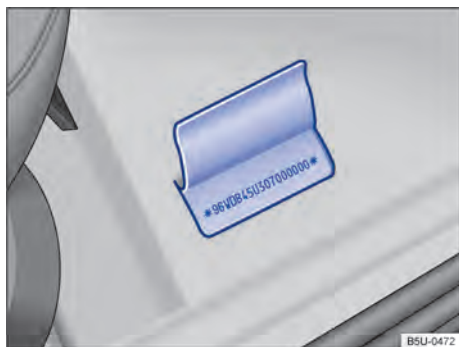
Fig. 211 Em frente ao banco do passageiro: número de identificação do veículo (número do chassi) no assoalho, em frente ao banco do passageiro dianteiro.
