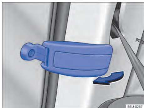
Fig. 54 Abrir o vidro basculante traseiro.
