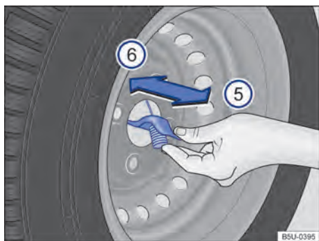
Fig. 201 Na roda de emergência: remover o cabo da roda de emergência.
