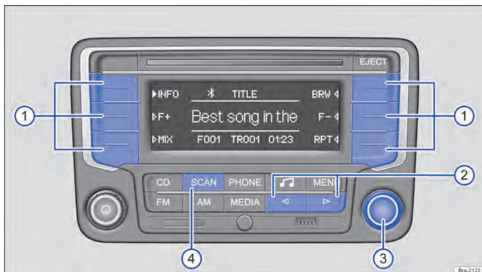
Fig. 146 Exemplo de exibição na operação de mídia: exibição do local de armazenamento de um MP3 na troca de faixa.
