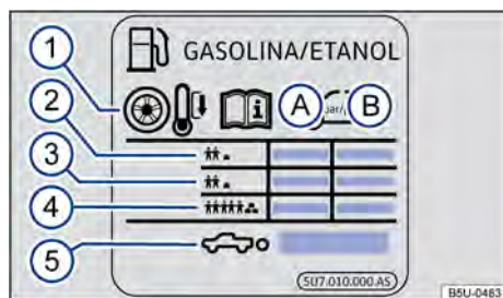
Fig. 197 Etiqueta com as pressões dos pneus.
