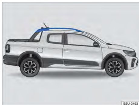
Fig. 158 Suportes longitudinais do bagageiro do teto (ambos os lados).
