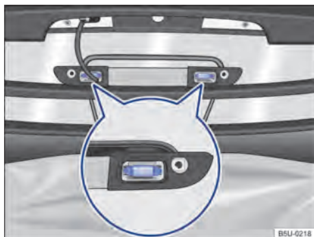
Fig. 177 Lanterna de freio elevada: remover a lâmpada incandescente da iluminação do compartimento de carga.
