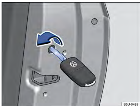
Fig. 46 Travação de emergência do veículo com a chave do veículo.
