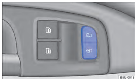
Fig. 43 Na porta do condutor: botão do travamento central.
