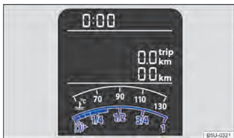
Fig. 12 No display do instrumento combinado: indicador do nível de combustível (variante 1).
