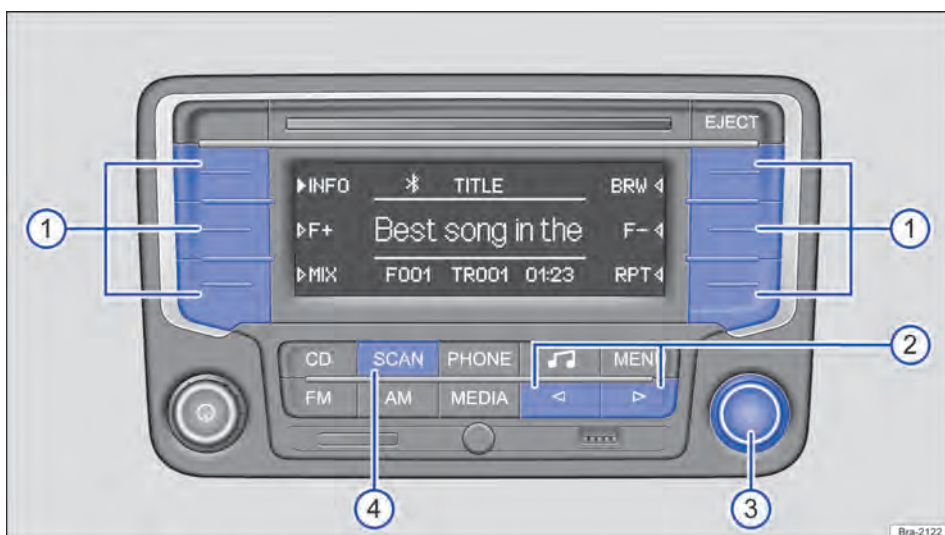
Fig. 148 Exemplo de exibição na operação de mídia: selecionar os modos de reprodução.
