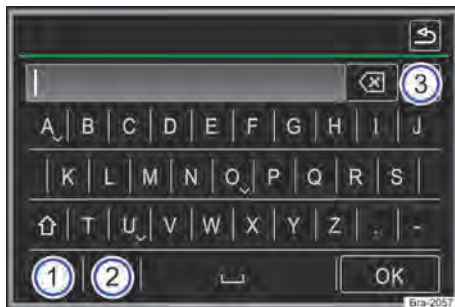
Fig. 119 Representação do princípio: máscara de inserção com teclado de display.
