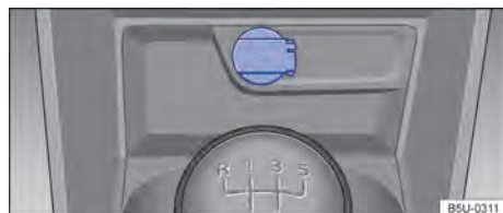
Fig. 110 No console central dianteiro: tomada 12 V.
