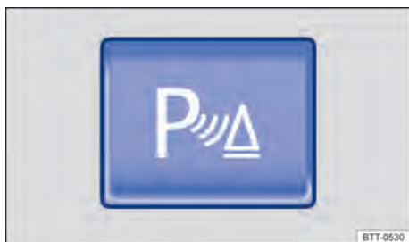
Fig. 93 Na parte superior do console central: botão para ligar e desligar o controle de distância de estacionamento (Park Pilot).
