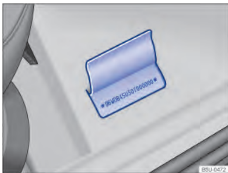
Fig. 224 Em frente ao banco do passageiro: número de identificação do veículo (número do chassi) no assoalho, em frente ao banco do passageiro dianteiro.
