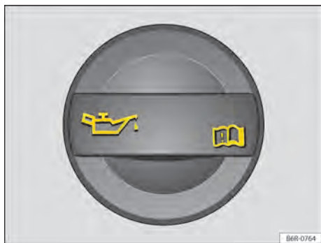
Fig. 203 No compartimento do motor: tampa da abertura para enchimento de óleo do motor.
