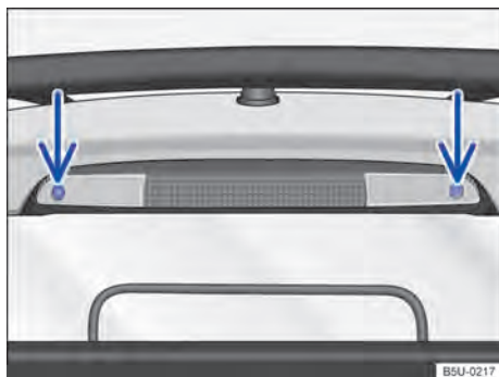
Fig. 191 No compartimento de carga: remover a lanterna de freio elevada.
