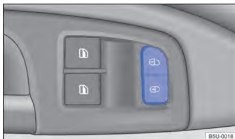
Fig. 43 Na porta do condutor: botão do travamento central.
