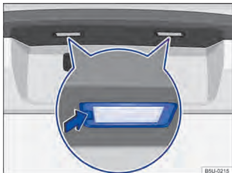
Fig. 189 No para-choque traseiro: remover a lanterna da placa de licença.
