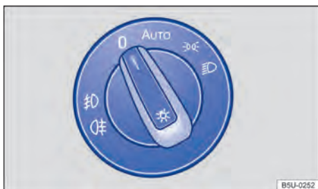
Fig. 66 No painel: interruptor das luzes.
