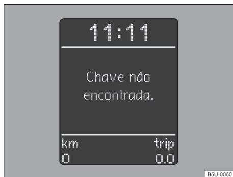
Fig. 86 No instrumento combinado: display com indicação do imobilizador ativado - veículos com Sistema de Informações Volkswagen.
