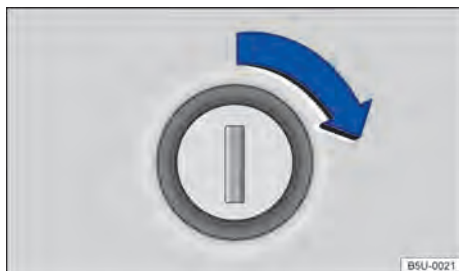
Fig. 49 Cilindro da fechadura para trancar e destrancar a tampa do compartimento de carga.
