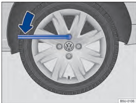
Fig. 220 Troca de roda: soltar os parafusos da roda.
