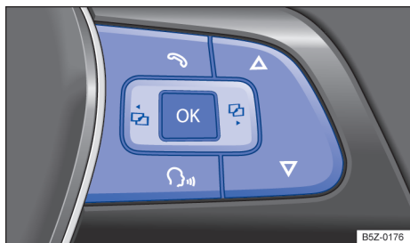
Fig. 25 Lado direito do volante multifunções: teclas de comando dos menus do instrumento combinado.
