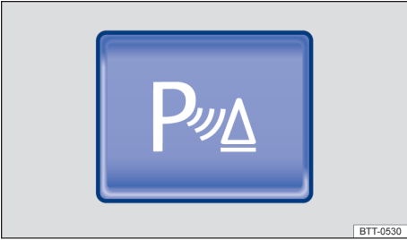
Fig. 110 Na parte superior do console central: botão para ligar e desligar o controle de distância de estacionamento (Park Pilot).
