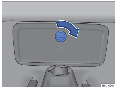
Fig. 153 No assoalho do banco traseiro: acesso à caixa de fixação das ferramentas de bordo.
