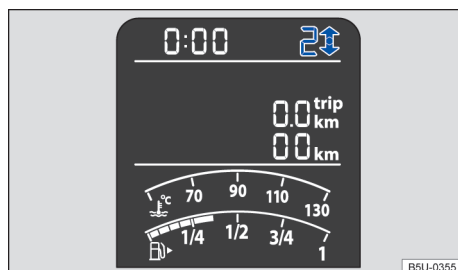
Fig. 98 No instrumento combinado: indicador de troca de marcha (variante 1).
