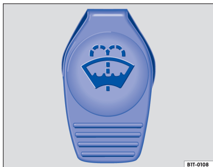
Fig. 180 No compartimento do motor: tampa do reservatório de água dos lavadores do para-brisa.
