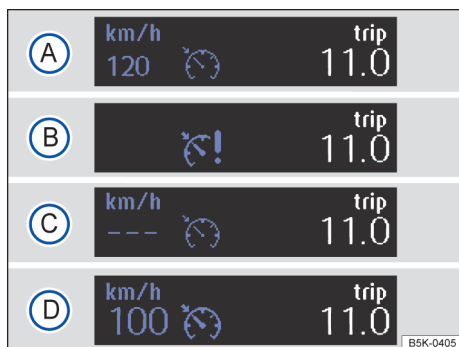
Fig. 107 No display do instrumento combinado: indicadores de status do GRA.
