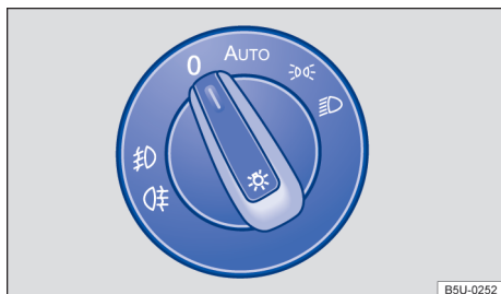
Fig. 79 No painel: interruptor das luzes.
