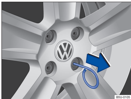
Fig. 195 Retirar as capas de cobertura dos parafusos da roda.
