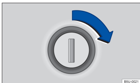
Fig. 63 Cilindro da fechadura para trancar e destrancar a tampa do compartimento de carga.
