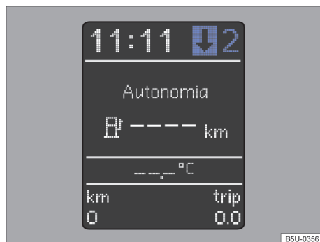
Fig. 99 No instrumento combinado: indicador de troca de marcha (variante 2).
