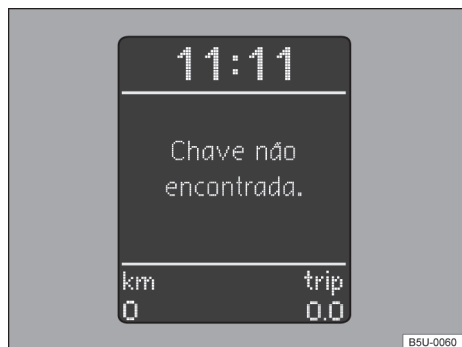
Fig. 102 No instrumento combinado: display com indicação do imobilizador ativado - veículos com Sistema de Informações Volkswagen.
