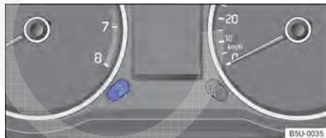
Fig. 86 No instrumento combinado (Nova Saveiro Robust): tecla de regulagem da iluminação dos instrumentos e dos interruptores.
