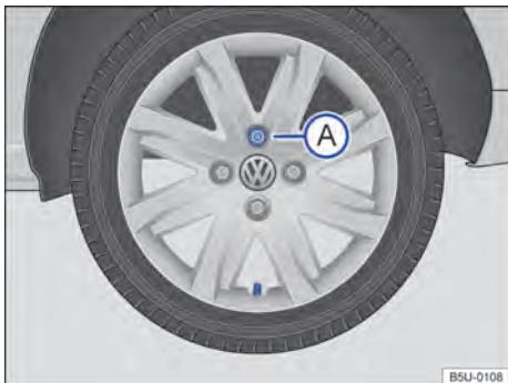
Fig. 205 Troca de roda: sequência de remoção dos parafusos da roda.
