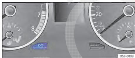
Fig. 85 No instrumento combinado: tecla de regulagem da iluminação dos instrumentos e dos interruptores.
