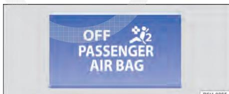
**Fig. 15** Luz de controle no painel de instrumentos para o airbag frontal do passageiro desligado.
