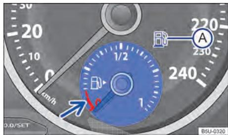
Fig. 44 No instrumento combinado: indicador do nível de combustível (variante 2).
