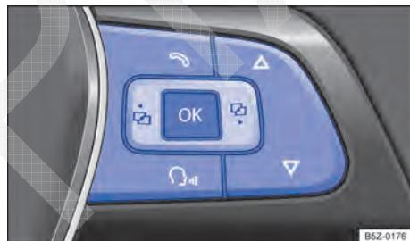
Fig. 53 Lado direito do volante multifunções: teclas de comando.
