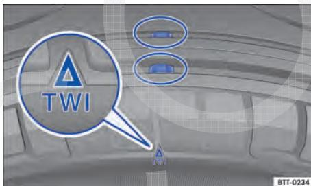
**Fig. 196** Perfil do pneu: indicadores de desgaste.
