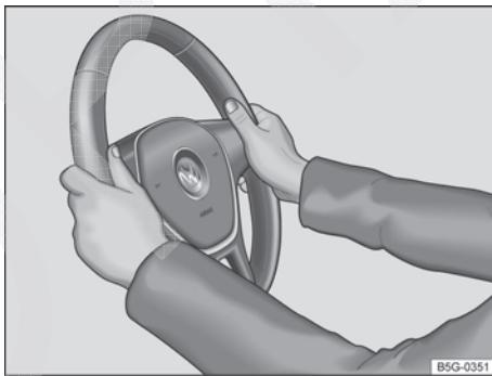
Fig. 76 No volante: posição 9 e 3 horas.
