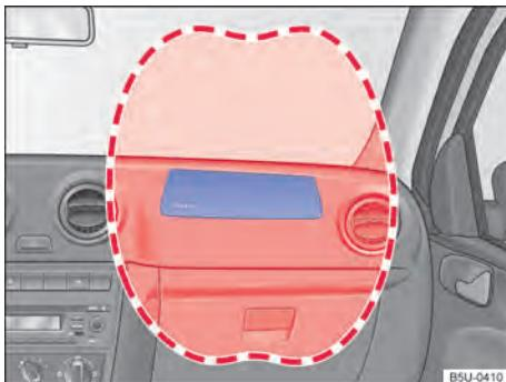
Fig. 19 Local de instalação e área de expansão do airbag frontal do passageiro.
