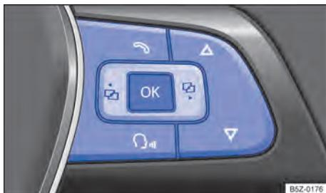
Fig. 51 Lado direito do volante multifunções: teclas de comando dos menus do instrumento combinado.
