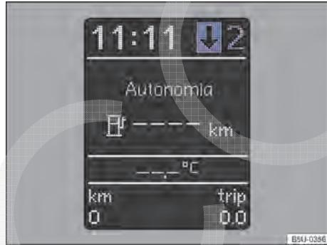
Fig. 104 No instrumento combinado: indicador de troca de marcha (variante 2).
