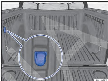
**Fig. 144 Compartimento de carga: tomada 12 V.**
