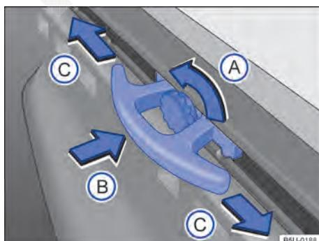
**Fig. 149** No compartimento de carga: suporte deslizante para veículos com capota marítima.
