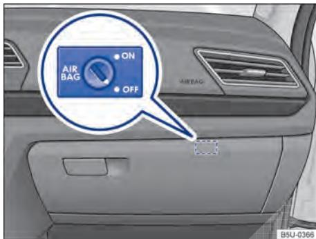
**Fig. 20** No porta-luvas: interruptor desacionado pela chave para desligar e ligar o airbag frontal do passageiro.
