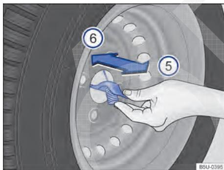
Fig. 198 Na roda de emergência: remover o cabo da roda de emergência.
