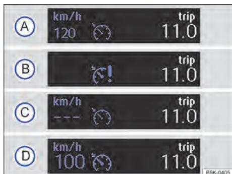
Fig. 112 No display do instrumento combinado: indicadores de status do GRA.
