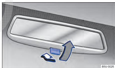
**Fig. 90** No para-brisa: espelho retrovisor interno com antifuscante manual.
