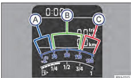
**Fig. 46** Indicador de temperatura do líquido de arrefecimento do motor no instrumento combinado (variante 1): **(A)** área fria; **(B)** área normal; **(C)** área de alerta.
