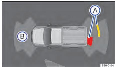
**Fig. 117** Exibição do display do controle de distância de estacionamento (display colorido): **(A)** obstáculo reconhecido no segmento. **(B)** área examinada à frente do veículo.
