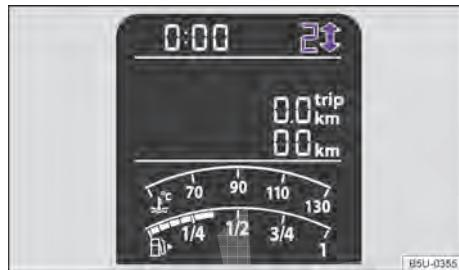
Fig. 103 No instrumento combinado: indicador de troca de marcha (variante 1).
