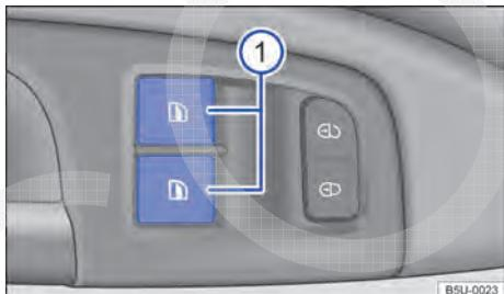
Fig. 73 Na porta do condutor: teclas dos vidros elétricos.
