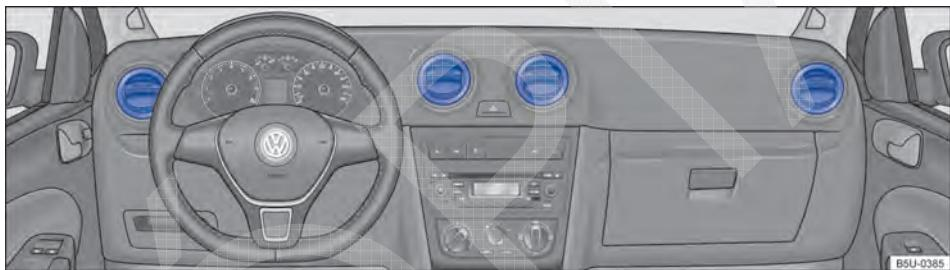
Fig. 99 No painel de instrumentos (Nova Saveiro Robust): difusores de ar.
