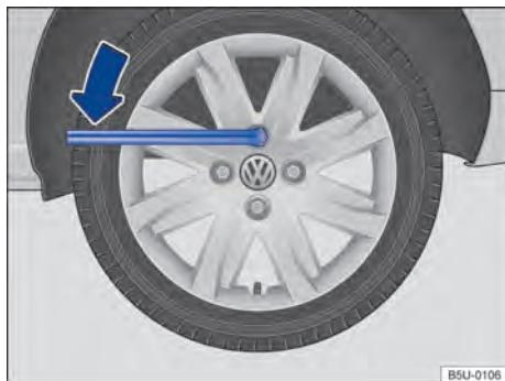
Fig. 202 Troca de roda: soltar os parafusos da roda.
