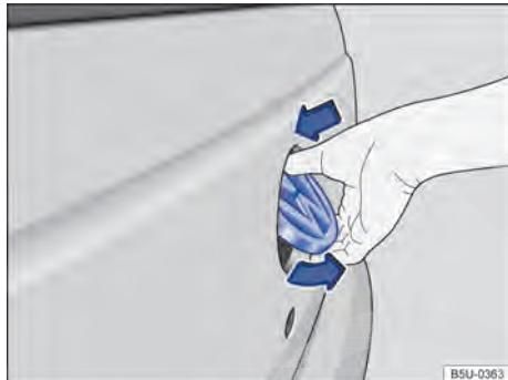
Fig. 65 Abrir a tampa do compartimento de carga.
