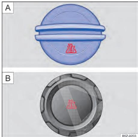
Fig. 189 No compartimento do motor: **A** tampa do reservatório de expansão do líquido de arrefecimento do motor (variante 1) ou **B** tampa do reservatório de expansão do líquido de arrefecimento do motor (variante 2).
