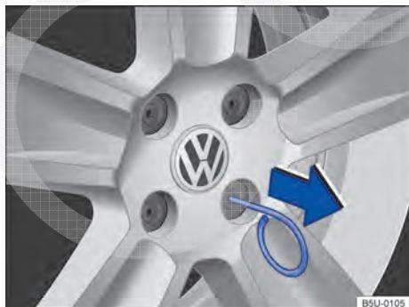
Fig. 200 Retirar as capas de cobertura dos parafusos da roda.
