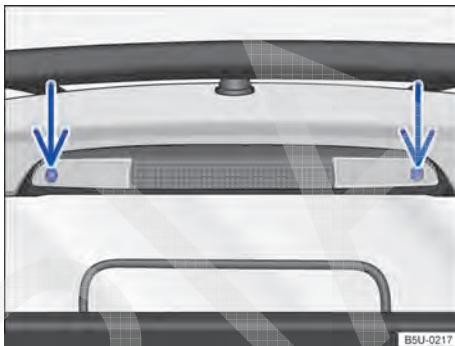
Fig. 173 No compartimento de carga: remover a lanterna de freio elevada.
