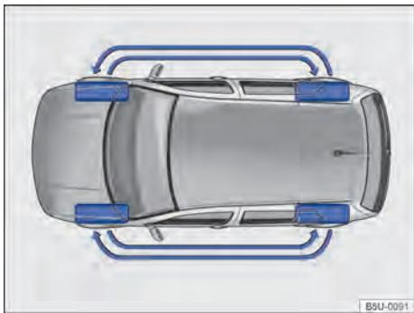
Fig. 194 Esquema para a troca das rodas.
