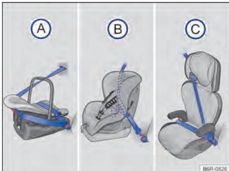
Fig. 22 As ilustrações (A), (B) e (C) mostram a fixação do sistema de retenção para crianças apenas com o cinto de segurança do veículo.
