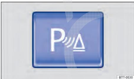
**Fig. 115** Na parte superior do console central: botão para ligar e desligar o controle de distância de estacionamento (Park Pilot).
