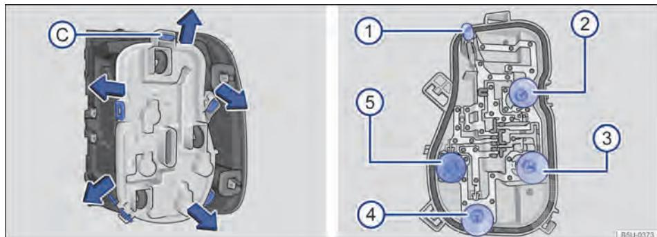
**Fig. 170 Lanterna traseira:** C desinstalar o suporte das lâmpadas e ①, ②, ③, ④ e ⑤ desinstalar as lâmpadas.
