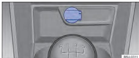
Fig. 140 No console central dianteiro: tomada 12 V. ▶
