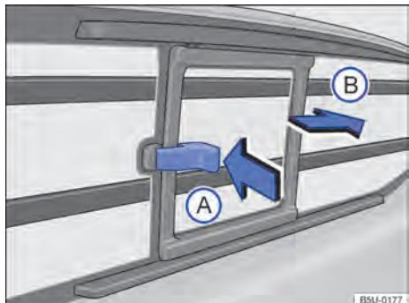
Fig. 74 No compartimento de carga: abertura do vidro corrediço.
