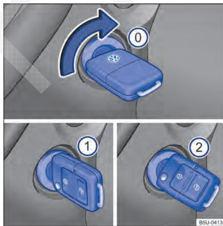
Fig. 106 Ao lado do volante, à direita: posições da chave do veículo no cilindro da ignição.
