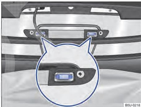
Fig. 174 Lanterna de freio elevada: remover a lâmpada incandescente da iluminação do compartimento de carga.
