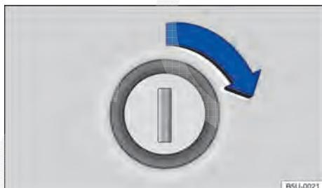
Fig. 66 Cilindro da fechadura para trancar e destrar a tampa do compartimento de carga.
