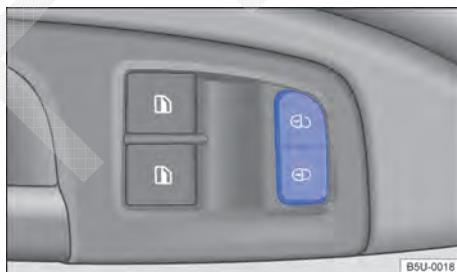
**Fig. 60** Na porta do condutor: teclas do travamento central.
