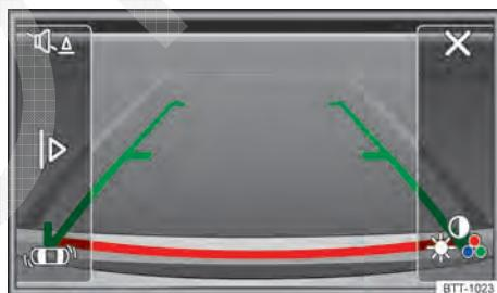
Fig. 119 Exibição do display do rádio ou do sistema de navegação: câmera de marcha a ré ligada (representação esquemática).
