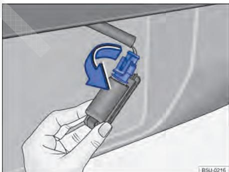
Fig. 172 Lanterna da placa de licença: remover o suporte da lâmpada.
