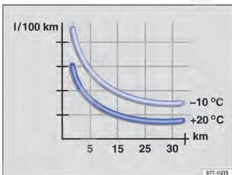
Fig. 105 Consumo de combustível em l/100 km em 2 temperaturas ambiente diferentes.
