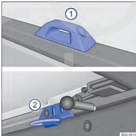
**Fig. 147** No compartimento de carga: suportes fixos **①** para veículos sem capota marítima e **②** para veículos com capota marítima.
