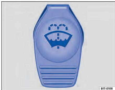
**Fig. 185** No compartimento do motor: tampa do reservatório de água dos lavadores do para-brisa.
