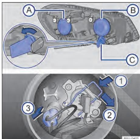
**Fig. 164** No compartimento do motor: vista traseira do farol dianteiro com cobertura de borracha (lado esquerdo da ilustração) - **A** farol baixo, **B** farol alto e luz de posição, e **C** indicador de direção. Vista traseira do farol dianteiro sem a cobertura de borracha (lado direito da ilustração): **1** mola de travamento da lâmpada incandescente do farol e **2** luz de posição.
