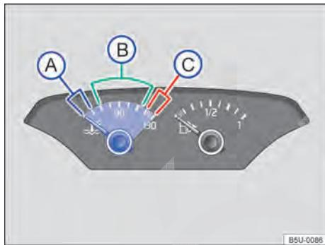
**Fig. 48** Indicador de temperatura do líquido de arrefecimento do motor no instrumento combinado: (A) área fria; (B) área normal; (C) área de alerta.
