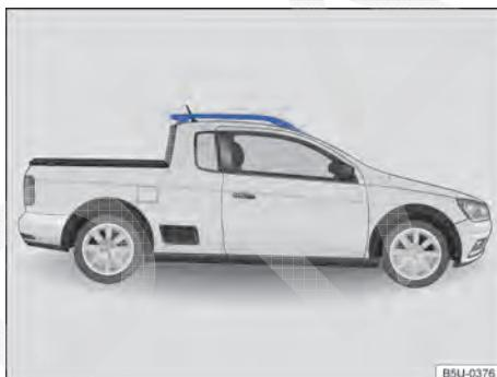
**Fig. 153** Suportes longitudinais do bagageiro do teto (ambos os lados).
