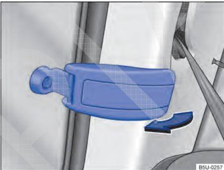
Fig. 71 Abrir o vidro basculante traseiro.
