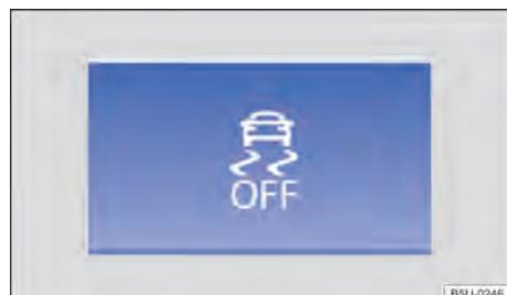
**Fig. 121** No console central: botão para desligar e ligar ASR manualmente.
