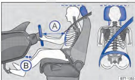
**Fig. 2 Distância correta do condutor em relação ao volante, posição correta do cinto de segurança e ajuste correto do apoio para cabeça.**
