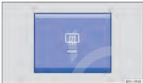
Fig. 101 No console central (Nova Saveiro Robust): botão do desembaçador do vidro traseiro (não disponível para algumas versões).
