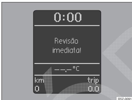
**Fig. 49** Display do instrumento combinado: indicador do intervalo de serviço.
