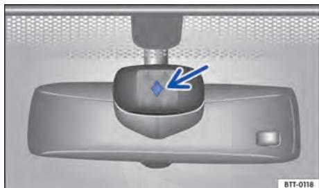
**Fig. 89** No para-brisa: superfície sensitiva do sensor de chuva.
