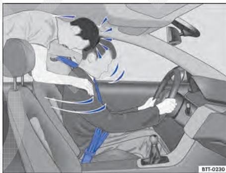
Fig. 7 O passageiro sem cinto de segurança no banco traseiro é lançado para frente sobre o condutor com cinto de segurança.
