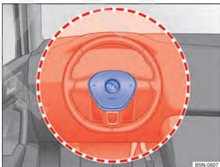
Fig. 18 Local de instalação e área de expansão do airbag frontal do condutor.
