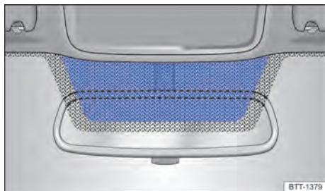
Fig. 95 Para-brisa reticulado com janela de comunicação (superfície azul).
