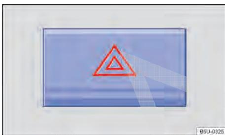
**Fig. 23** Na parte superior do console central: interruptor das luzes de advertência.
