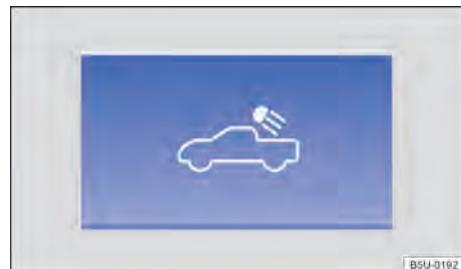
**Fig. 84** No console central: tecla da iluminação do compartimento de carga.
