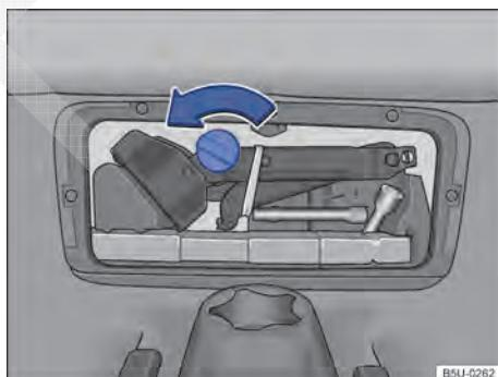
**Fig. 159** Manípulo de fixação da caixa de ferramentas de bordo.
