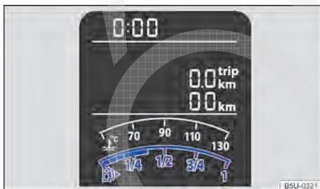
Fig. 145 No display do instrumento combinado: indicador do nível de combustível (variante 1).
