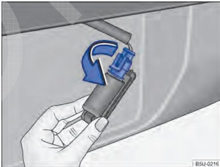
**Fig. 209** Lanterna da placa de licença: remover o suporte da lâmpada.
