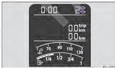
**Fig. 124** No instrumento combinado: indicador de troca de marcha (variante 1).
