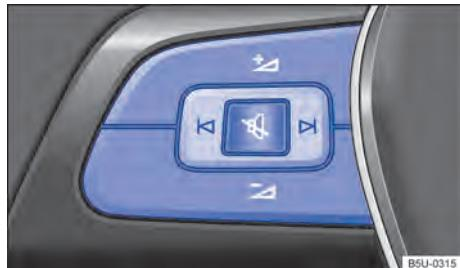
Fig. 20 Lado esquerdo do volante multifunções: teclas de comando.
