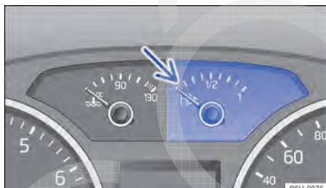
**Fig. 147** No instrumento combinado: indicador da reserva de combustível.
