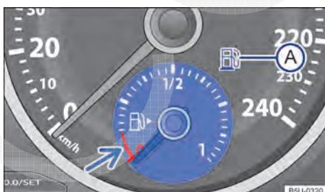
Fig. 146 No instrumento combinado: indicador do nível de combustível (variante 2).
