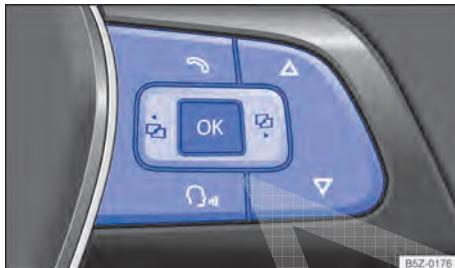
Fig. 21 Lado direito do volante multifunções: teclas de comando.
