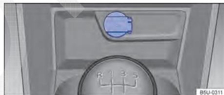
Fig. 115 No console central dianteiro: tomada 12 V. ▶
