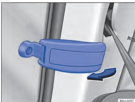
Fig. 38 Abrir o vidro basculante traseiro.
