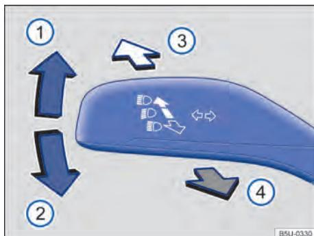
Fig. 71 Alavanca dos indicadores de direção e do farol alto / longo alcance.
