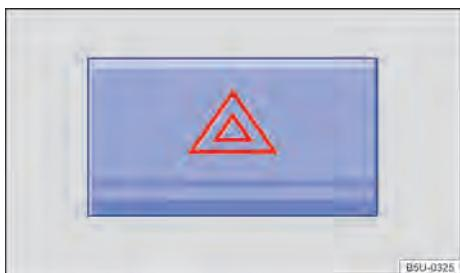
Fig. 181 Na parte superior do console central: interruptor das luzes de advertência.
