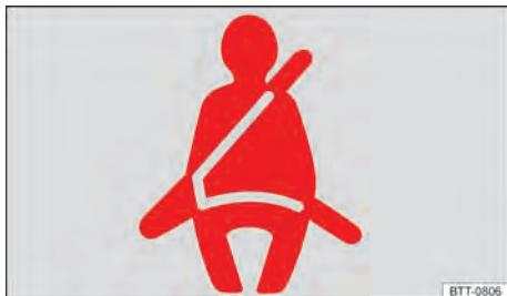
Fig. 51 Luz de advertência no display do instrumento combinado.
