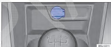
**Fig. 117** No console central dianteiro: tomada 12 V.
