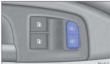
Fig. 30 Na porta do condutor: tecla do travamento central.
