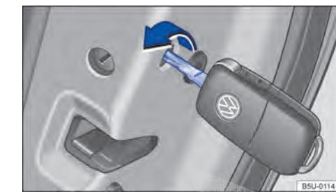
Fig. 187 Travamento de emergência do veículo com a chave do veículo.
