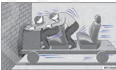
Fig. 53 Um veículo com os ocupantes do veículo sem cintos de segurança colide com o muro.
