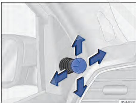
Fig. 85 Nas portas dianteiras: interruptor de ajuste dos espelhos retrovisores externos mecânicos.
