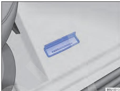
Fig. 214 Em frente ao banco do passageiro dianteiro: número de identificação do veículo (número do chassis) no assoalho, em frente ao banco do passageiro.
