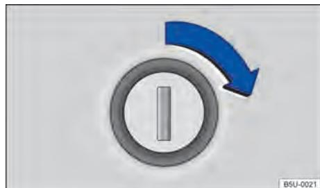
**Fig. 33 Cilindro da fechadura para trancar e destrancar a tampa do compartimento de carga.**
