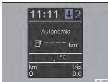
**Fig. 125** No instrumento combinado: indicador de troca de marcha (variante 2).
