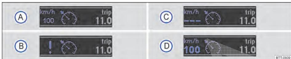
Fig. 138 No display do instrumento combinado: indicadores de status do GRA.
