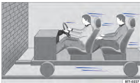
Fig. 49 Um veículo com os ocupantes sem cintos de segurança está em rota de colisão com um muro.
