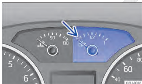
Fig. 127 No instrumento combinado: indicador da reserva de combustível.
