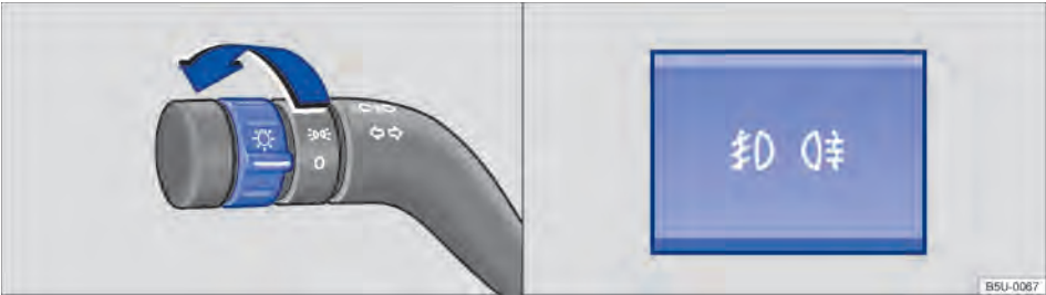
Fig. 66 Interruptor das luzes na alavanca dos indicadores de direção e tecla do farol e da lanterna de neblina no console central.
