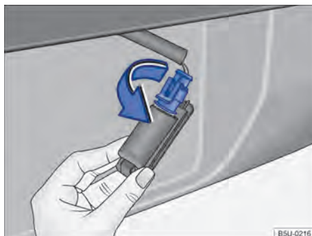
Fig. 197 Lanterna da placa de licença: remover o soquete da lâmpada.
