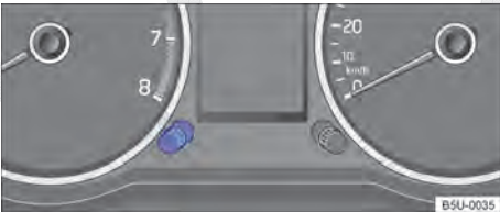
Fig. 69 No instrumento combinado: tecla de regulagem da iluminação dos instrumentos e dos interruptores.
