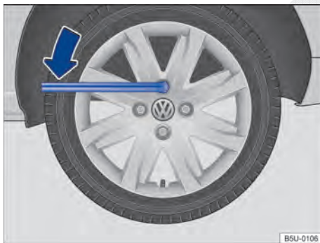
Fig. 168 Troca de roda: afrouxar os parafusos da roda.
