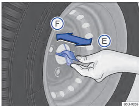
Fig. 167 Na roda de emergência: remover o cabo do aro da roda de emergência.
