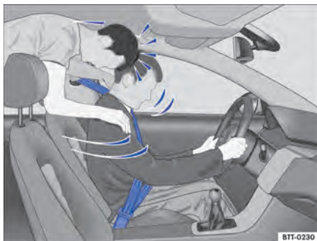
Fig. 52 O passageiro sem cinto de segurança no banco traseiro é lançado para frente sobre o condutor com cinto.
