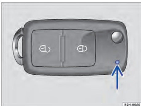
Fig. 23 Luz de controle da chave do veículo com comando remoto.
