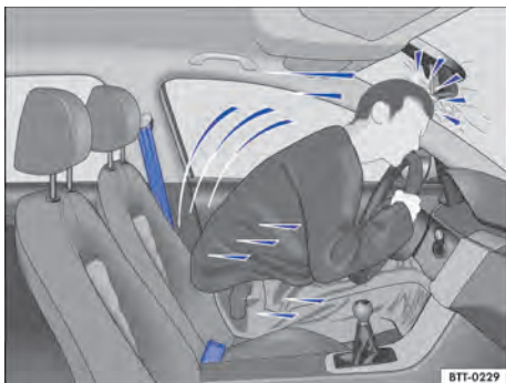
Fig. 51 O condutor sem o cinto de segurança é lançado para frente.
