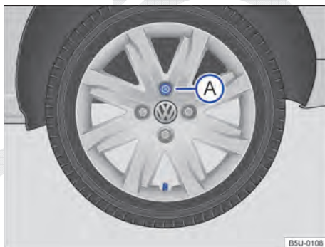
Fig. 163 Retirar a supercalota.
