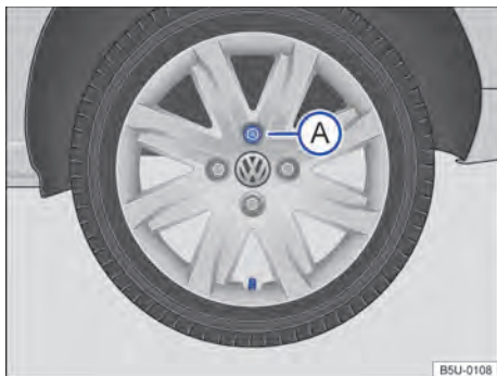
Fig. 171 Troca de roda: sequência de remoção dos parafusos da roda.
