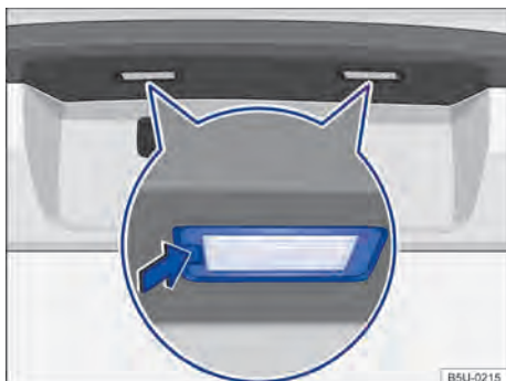
Fig. 196 No para-choque traseiro: remover a lanterna da placa de licença.
