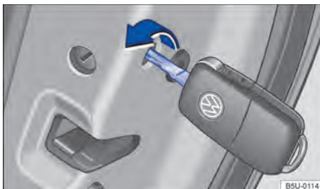
Fig. 157 Travamento de emergência do veículo com a chave do veículo.
