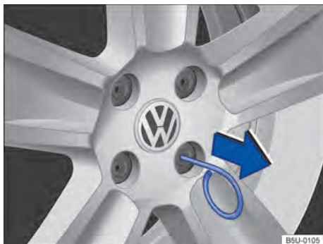
Fig. 164 Remover as capas de cobertura dos parafusos da roda.
