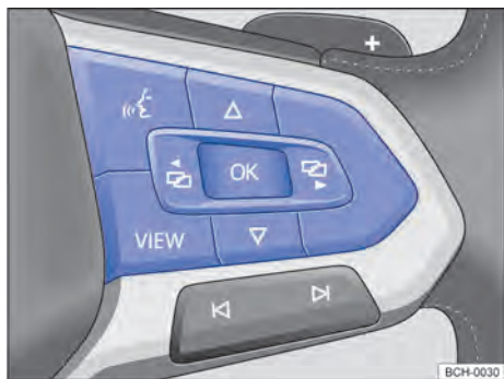
Fig. 20 Lado direito do volante multifunções (variante 2): botões para comando dos menus e exibições de informação do instrumento combinado.
