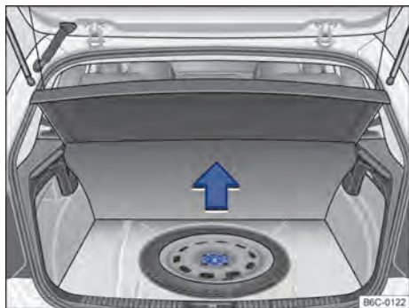
Fig. 130 No compartimento de bagagem, sob o revestimento de assoalho: roda de emergência e ferramentas de bordo.
