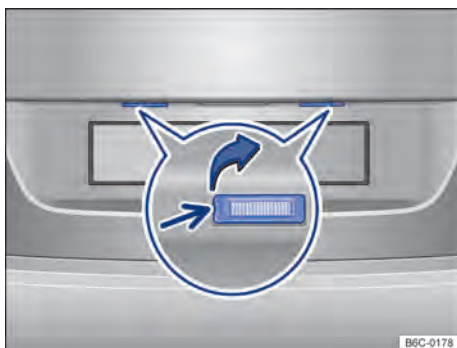
Fig. 139 Na tampa traseira: lanterna da placa de licença.
