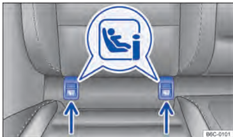
Fig. 43 No banco do veículo: identificação dos pontos de ancoragem inferiores para cadeiras de criança.
