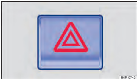
Fig. 46 Na parte superior do console central: interruptor das luzes de advertência.
