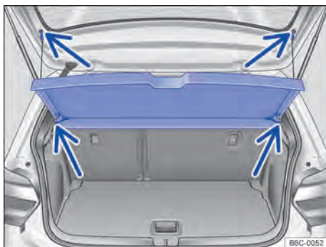
Fig. 122 No compartimento de bagagem: remover e instalar a cobertura do compartimento de bagagem.
