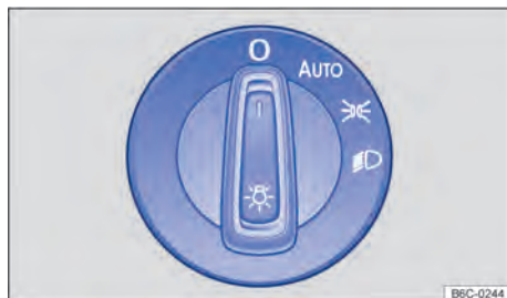
Fig. 70 Ao lado do volante: interruptor de luzes (uma variante).
