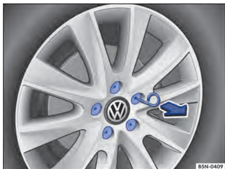
Fig. 169 Remover as capas de cobertura dos parafusos de roda.
