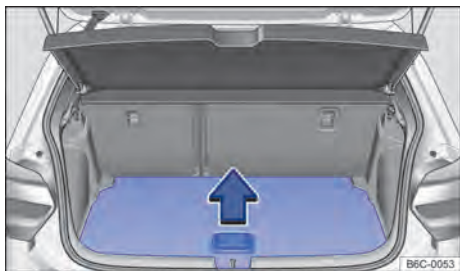
Fig. 123 No compartimento de bagagem: levantar o assoalho do compartimento de bagagem.
