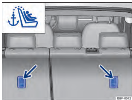
Fig. 44 Olhal de retenção para o cinto de fixação superior no lado de trás do banco traseiro.
