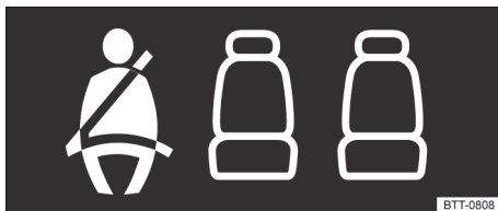
Fig. 24 Indicador de status do cinto de segurança para os assentos traseiros no display do instrumento combinado.
