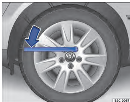
Fig. 168 Troca de roda: soltar os parafusos da roda.
