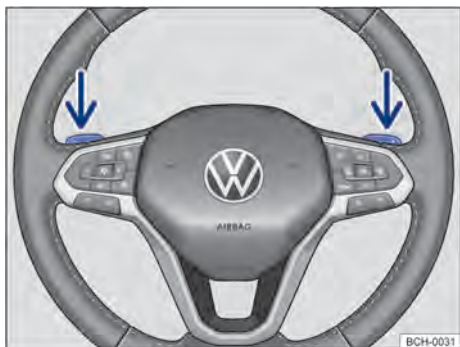
Fig. 95 Volante com seletores basculantes do Tiptronic.
