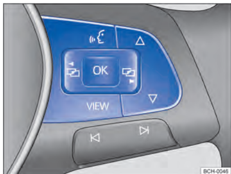
Fig. 19 Lado direito do volante multifunções (variante 1): botões para comando dos menus e exibições de informação do instrumento combinado.
