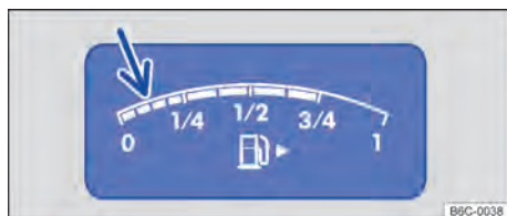
Fig. 12 No instrumento combinado analógico: indicador do nível de combustível.
