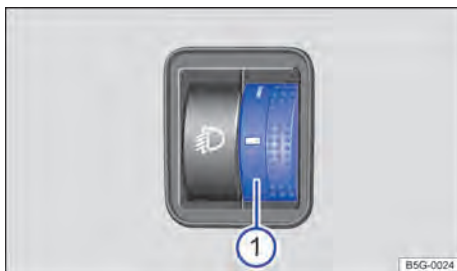
Fig. 73 Ao lado do volante: regulador do alcance do farol ①.
