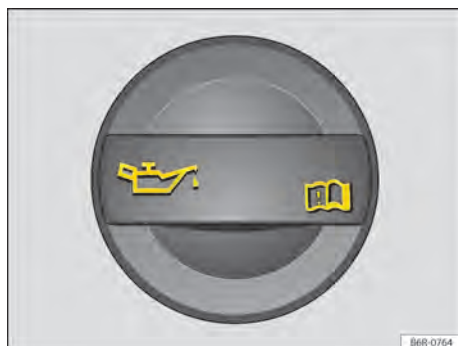
Fig. 157 No compartimento do motor: tampa da abertura para enchimento de óleo do motor.
