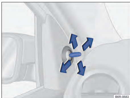
Fig. 80 Nas portas dianteiras: botão de ajuste dos espelhos retrovisores externos mecânicos.
