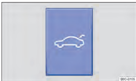
Fig. 61 No console central: botão de destravamento da tampa traseira.
