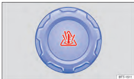
Fig. 159 No compartimento do motor: tampa do reservatório de expansão do líquido de arrefecimento do motor.
