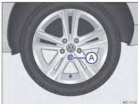
Fig. 198 Retirar a calota integral.
