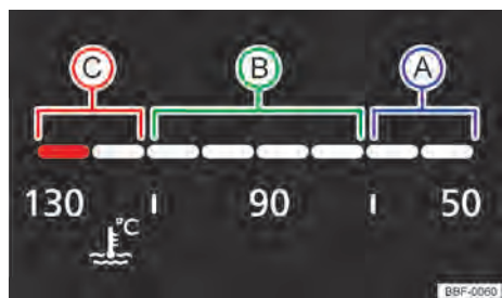
Fig. 16 Indicador de temperatura do líquido de arrefecimento do motor no instrumento combinado digital (variante 2): (A) área fria; (B) área normal; (C) área de alerta.
