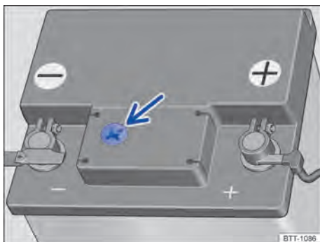
Fig. 190 No compartimento do motor: exemplo de posição do visor no lado superior da bateria do veículo.
