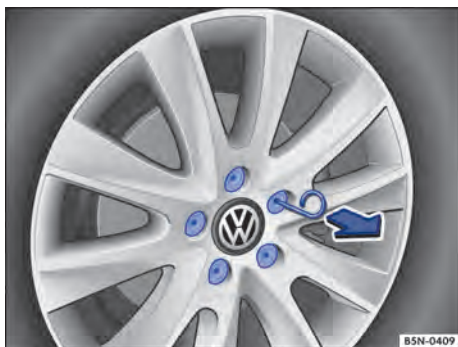
Fig. 199 Remover as capas de cobertura dos parafusos de roda.
