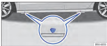
Fig. 202 Pontos de apoio do macaco.
