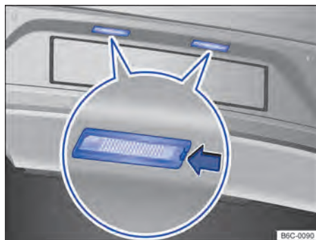
Fig. 171 No para-choque traseiro: lanterna da placa de licença.
