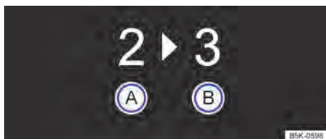
Fig. 89 No instrumento combinado: indicador de troca de marcha.
