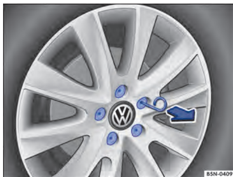
Fig. 200 Remover as capas de cobertura dos parafusos de roda.
