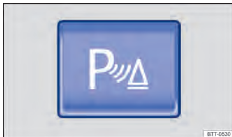
Fig. 101 No console central ou no display do rádio: botão para ligar e desligar o auxílio de estacionamento.
