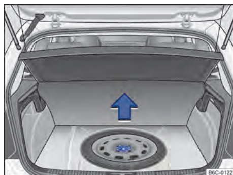
Fig. 160 No compartimento de bagagem, sob o revestimento de assoalho: roda de emergência e ferramentas de bordo.
